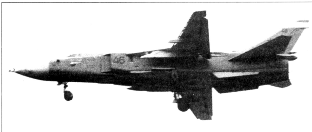
Справа под крылом Су-24 – ракета X-28, на переднем плане хорошо видно пусковое устройство ПУ-28
