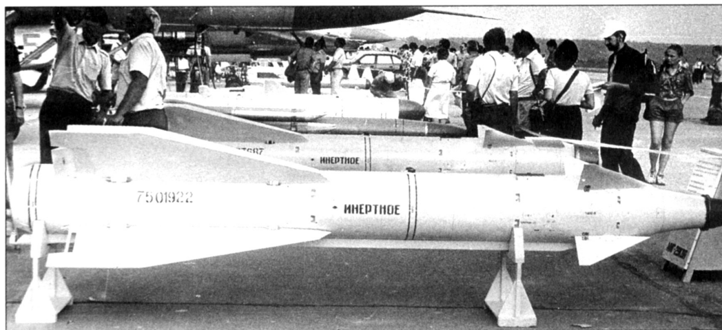
Х-29А в инертном исполнении без БЧ и порохового заряда двигателя
