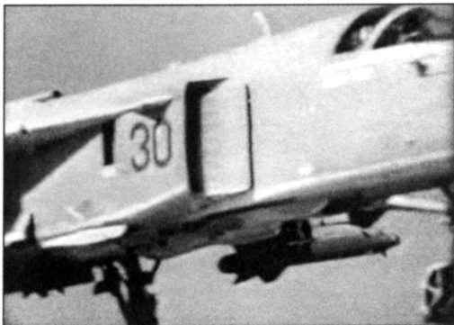
Отработка X-25 на бомбардировщике Су-24М
