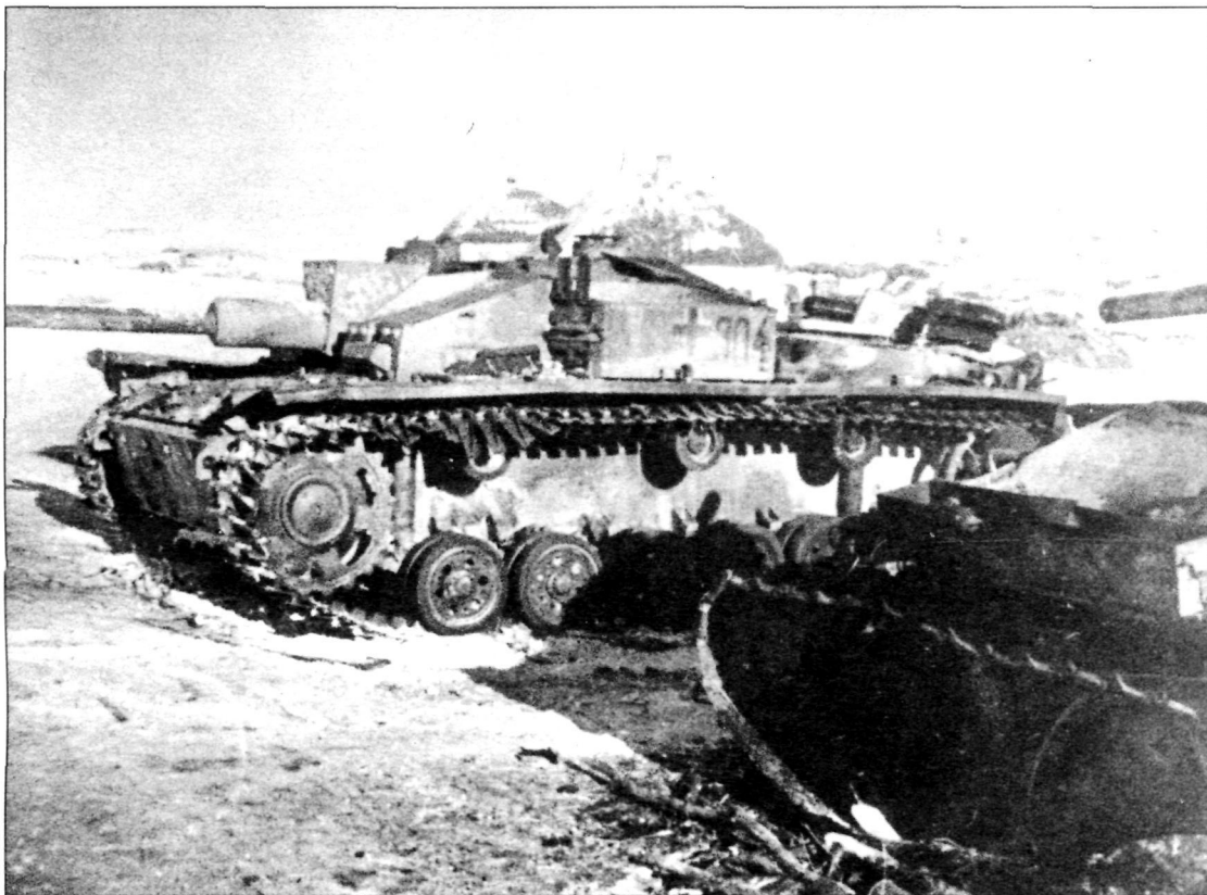
Штурмовое орудие StuG 40 Ausf F, подбитое в р-не г. Харьков, с обрезинными поддерживающими катками. 1943 г.
