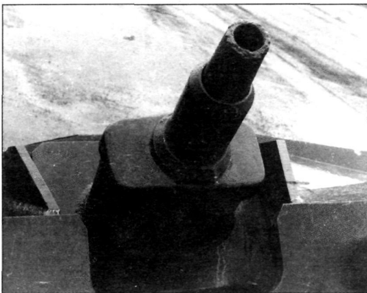
Короткоствольное орудие и маска StuG III Ausf C.
