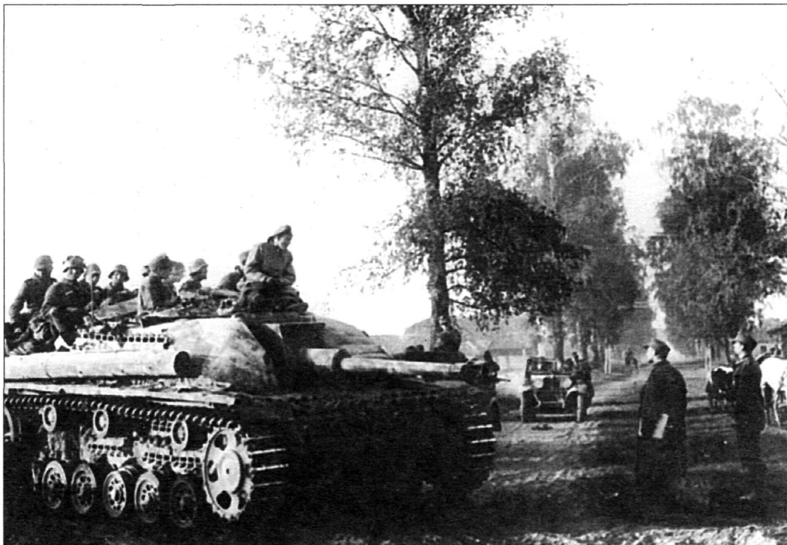
Интересный вариант нанесения цементного покрытия на лобовую часть StuG 40. Это не «Циммерит». По некоторым данным, такая «подушка» наносилась для защиты от кумулятивных снарядов.
