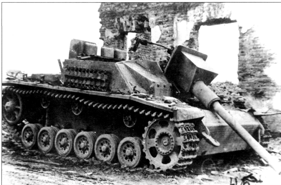
Штурмовое орудие с цельнометаллическими поддерживающими катками, подбитое в р-не г. Киев. Осень, 1943 г.
