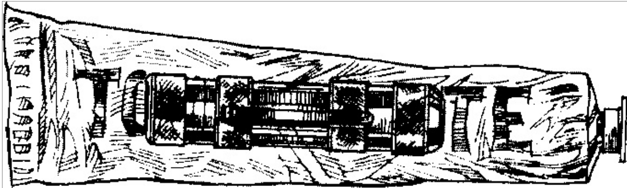
Миниатюрное однозарядное приспособление для стрельбы 22-го калибра (5,6 мм) «Стингер», замаскированное в тюбике зубной пасты
