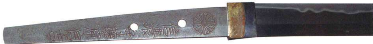
Полоса меча. Можно видеть изображение хризантемы и подпись мастера на стороне омотэ хвостовика, а также сужение закаленной части якиба и спрямление линии закалки хамон к хвостовику. Фотография автора.
