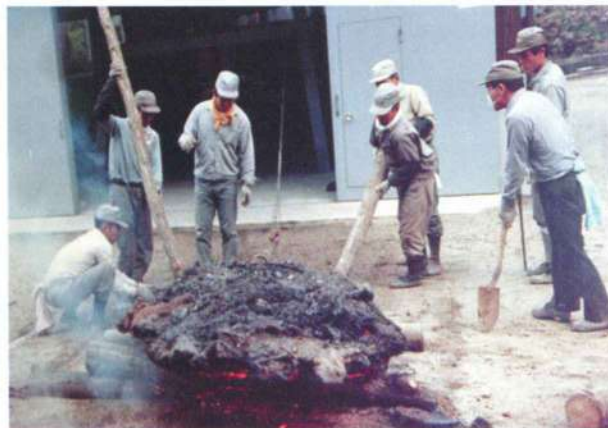
Процесс получения сырой железной массы кэра в традиционной плавильне татара .
