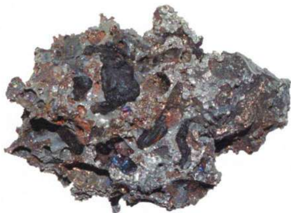
Кусочек тамагаганэ. Спектральный анализ данного образца показал, что содержание железа в нем составляет 97,743%, среди других элементов – кремний, кальций, калий, фосфор, алюминий, марганец, сера, хром и углерод. Коллекция автора. Фотография автора.
