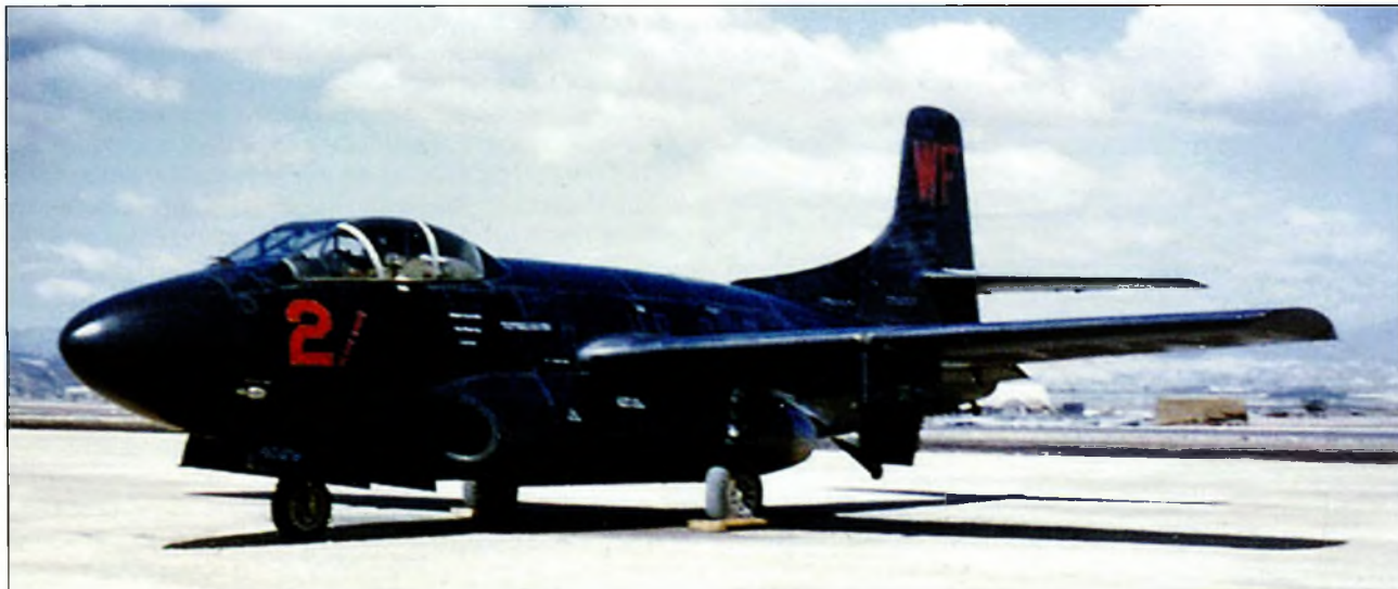
F3D-2 Skyknight эскадрильи корпуса морской пехоты VMF(N)-513 «Flying Nightmares». Лето 1952 года. Самолет стал первым реактивным тяжелым истребителем с бортовой РЛС, которому удалось одержать победу над реактивным истребителем противника. 3 ноября 1952 года экипаж самолета заявил об уничтожении северокорейского Як-15
