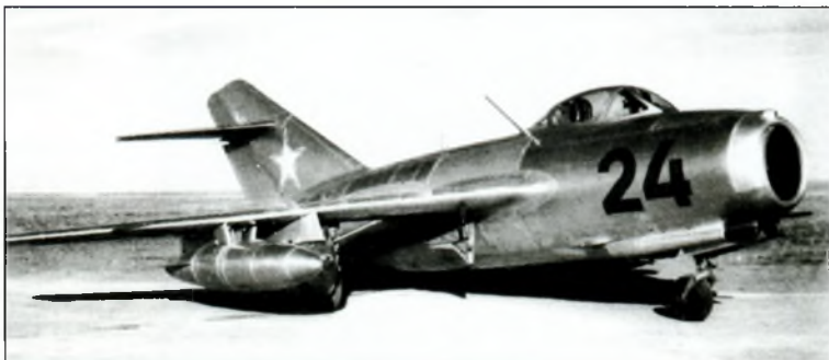
Истребитель бомбардировщик МиГ-15бис с четырьмя авиабомбами ФАБ-250. Фото из книги (Н. Якубович. «Истребитель МиГ-15 гроза летающих крепостей». С. 46)
