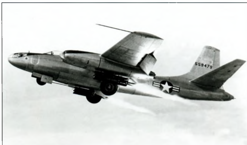
Отработка взлета самолета XB-45 Tornado с использованием стартовых ускорителей
