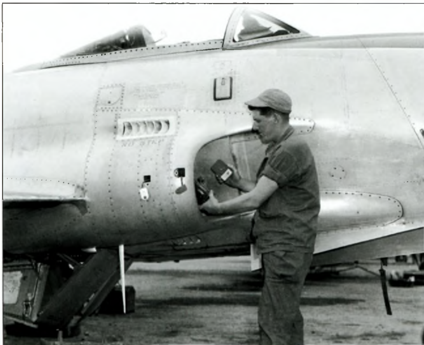
Установка на самолет камеры фотокинопулемета (ФКП) перед боевым вылетом
