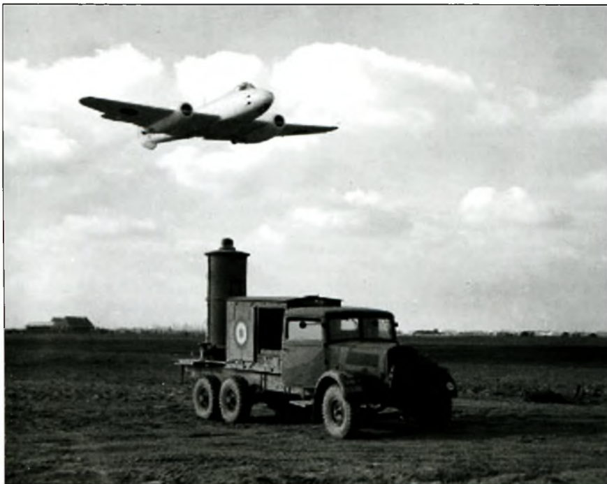
Взлет истребителя Gloster Meteor Mk III 616-й эскадрильи RAF. На переднем плане автомобиль светового обозначения ВПП, который использовался ночью и в плохих метеоусловиях
