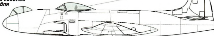
F-80A с барабанной пусковой установкой НУРС
