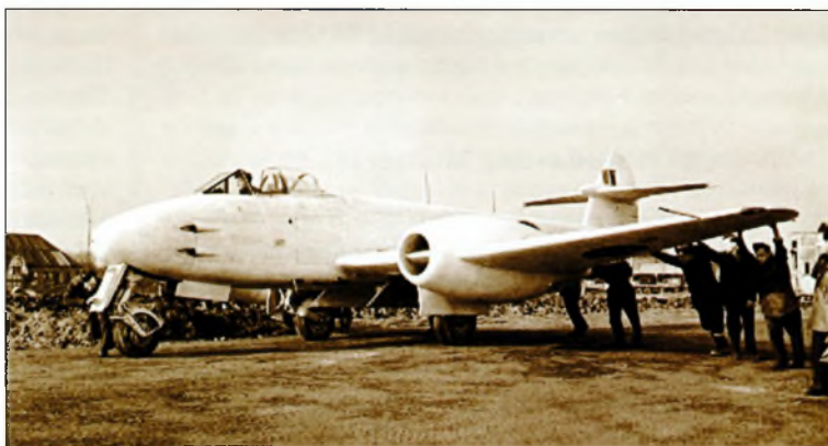
Gloster Meteor Mk III (EE239) 616-й эскадрильи RAF. Эскадрилья применялась для противодействия немецким реактивным Messerschmitt Me 262. «Метеоры» были выкрашены в белый цвет для облегчения идентификации другими самолетов союзников. Март 1945 года
