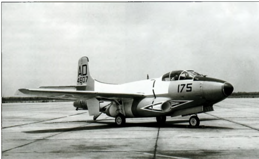
Douglas F3D-2T2 Skyknight (№ 124607) истребительной эскадрильи VF-101 «Grim Reapers». Авиабазы Ки-Уэст (Key West), 1961 год. В модификацию F3D-2T2 было переоборудовано 55 F3D-2. Самолеты использовались для подготовки операторов РЛС. В 1962 году самолеты получили обозначение TF-10B
