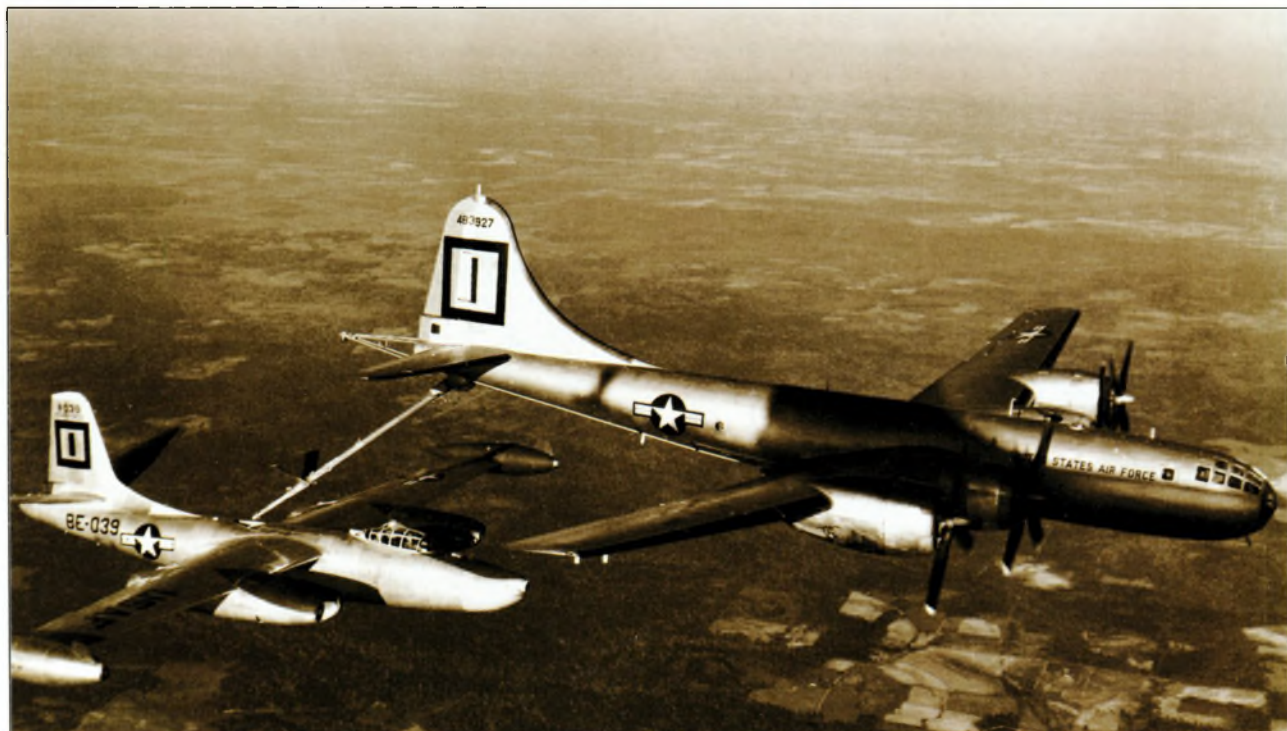
RB-45C Tornado (№ 48-039) из состава 91-го стратегического разведывательного крыла (91 SRW) выполняет дозаправку от воздушного танкера KB-29P (№ 44-83927)
