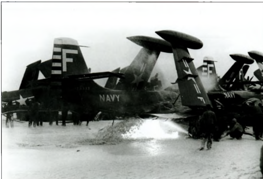
Тушение пожара двигателя на истребителе F2H-2 Banshee (№ 123333) эскадрильи VF-62 «Gladiators». Авианосец USS Lake Champlain (CVA-39). Корея, 1953 год
