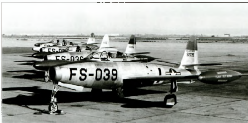
Все эти F-84E-1-RE Thunderjets (№ № 49-2039, 49-2036, 49-2034 и 49-2035) использовались в испытательных полетах, о чем говорит и надпись на дополнительных концевых крыльевых топливных баках.
