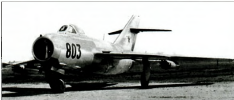
Опытный самолет СД-57 с реактивными орудиями ОРО-57. Фото из книги (Н. Якубович. Указ. соч. С. 44)
