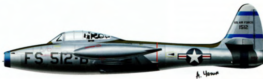
Истребитель-бомбардировщик F-84E Thunderjet из 159-й эскадрильи 116-го истребительно-бомбардировочного авиакрыла. В рамках программы «Hi-Tide» оба крыльевых топливных бака оборудованы штангами для дозаправки топливом в воздухе. Июнь 1952 года
