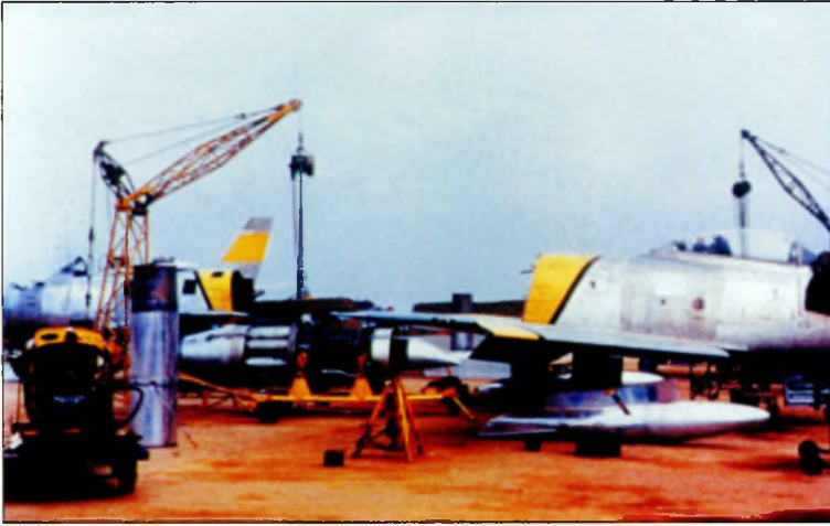
Замена двигателей General Electric J47-GE-13 на самолетах F-86E Sabre 4-го истребительного авиационного крыла. Авиабазы Кимпо (Kimpo), Корея, 1952 год
