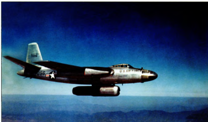
Летающая лаборатория JB-45A. Самолет был переоборудован из серийного В-45А-5-NA (SN 47-096). В нижней части фюзеляжа самолета установлен двигатель Westinghouse J34
