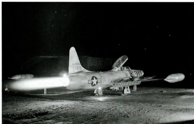
Lockheed F-94B-5-LO Starfire (№ 51-5416) 319-й эскадрильи истребителей-перехватчиков опробует двигатель на форсажном режиме перед взлетом в ночное небо Кореи. Июль 1953 года
