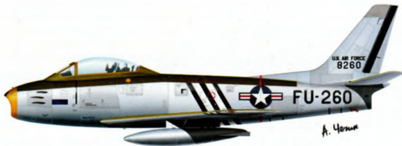
Истребитель F-86A «Sabre» из 335-й эскадрильи 4-го истребительного авиакрыла. На верхние поверхности самолета нанесено камуфляжное покрытие для проведения визуальной разведки в глубоком тылу противника. Операции «Stovepipe», 1951 год
