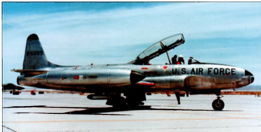
Двухместный самолет Т-33, созданный на базе F-80 и долгое время применявшийся в ВВС США и других стран в качестве тренировочного и учебно-боевого
