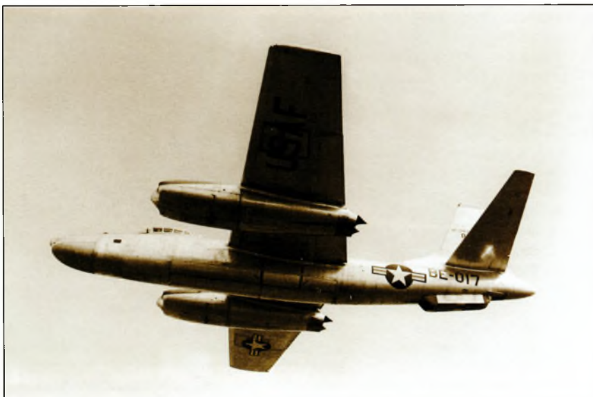
В полете JRB-45С. В хвостовой части самолета установлен контейнер аппаратуры РЭБ
