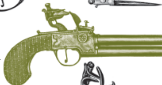
Рис. 158. Трехствольный пистолет с маленьким штыком, который, вращаясь на шарнире, укладывается под стволами
