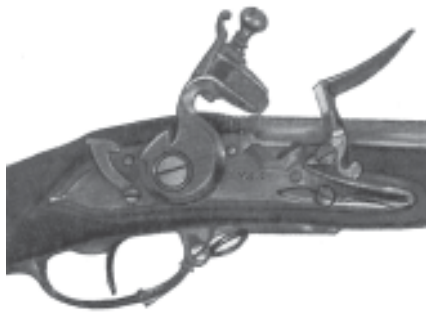
Рис. 176. Замок пехотного ружья образца 1763 г.
