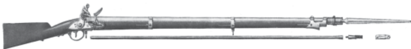
Рис. 200. Русское пехотное ружье образца 1808 г. Ниже показаны шомпол, разрядник (пыжевик) и патрон
