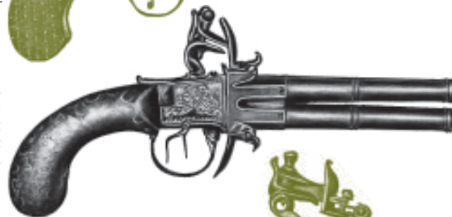
Рис. 159. Двухствольный пистолет с неподвижными стволами
