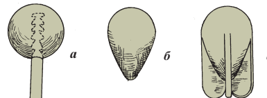
Рис. 199. Пули Босвелла для гладкоствольных ружей: а — пуля с хвостом из проволоки; б — яйцеобразная пуля; в — яйцеобразная пуля с крылышками
