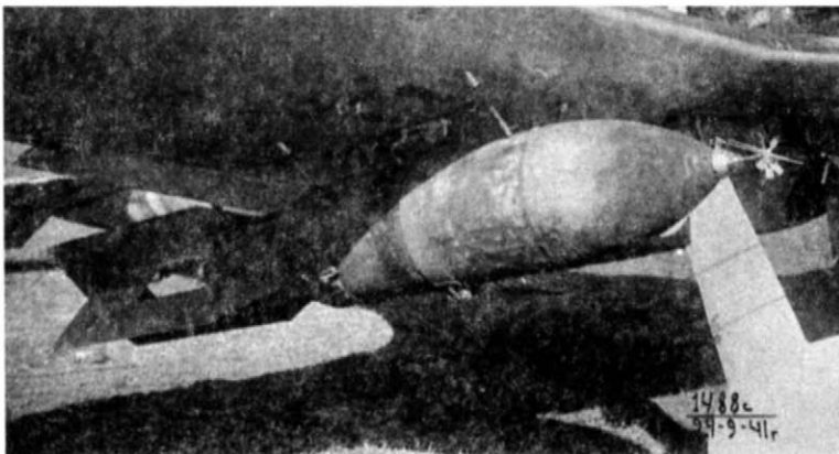
Испытание бомбового вооружения на самолете И-185 М-71 № 6204 в сентябре 1941 г. на аэродроме ЛИИ в Раменском. Под крылом подвешены две ФАБ-250
