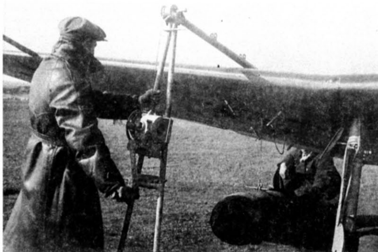
Подъем авиабомбы ФАБ-250 при помощи лебедки БЛ-4 на подкрыльевой держатель
