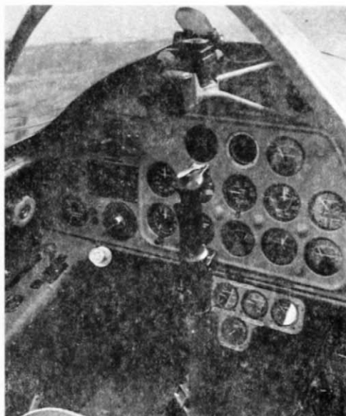
Оборудование кабины летчика эталонного И-185 М-71
