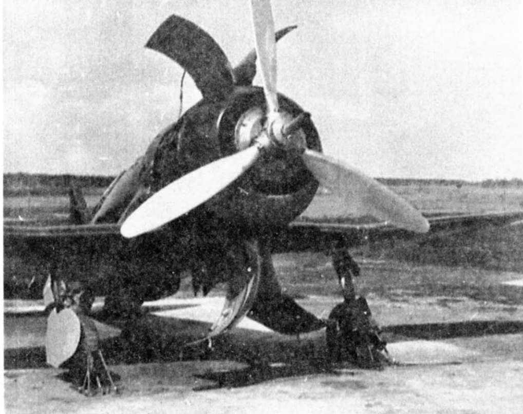
И-185 М-71 с раскрытыми створками капота и снятым обтекателем воздушного винта
