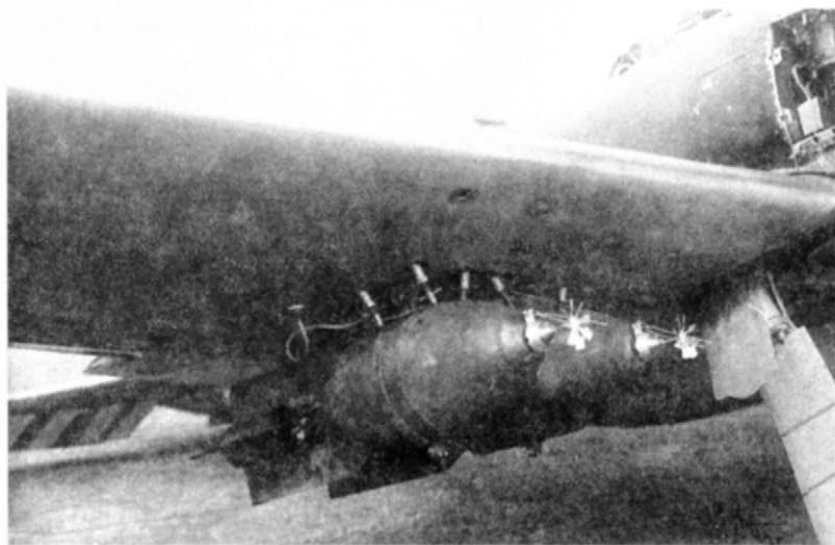
Подвеска под И-185 выливных приборов ВАП-6
