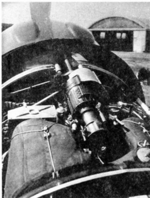
Установка верхней синхронной пушки ШВАК
