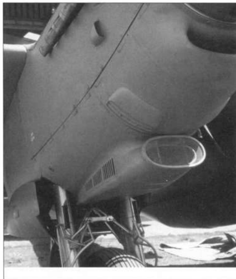
Мотогондла «Москито» с двигателем «Мерлин» 72. Позади кока винта появился еще один воздухозаборник для интеркулера, ведь наддув стал двухступенчатым для увеличения высоты
