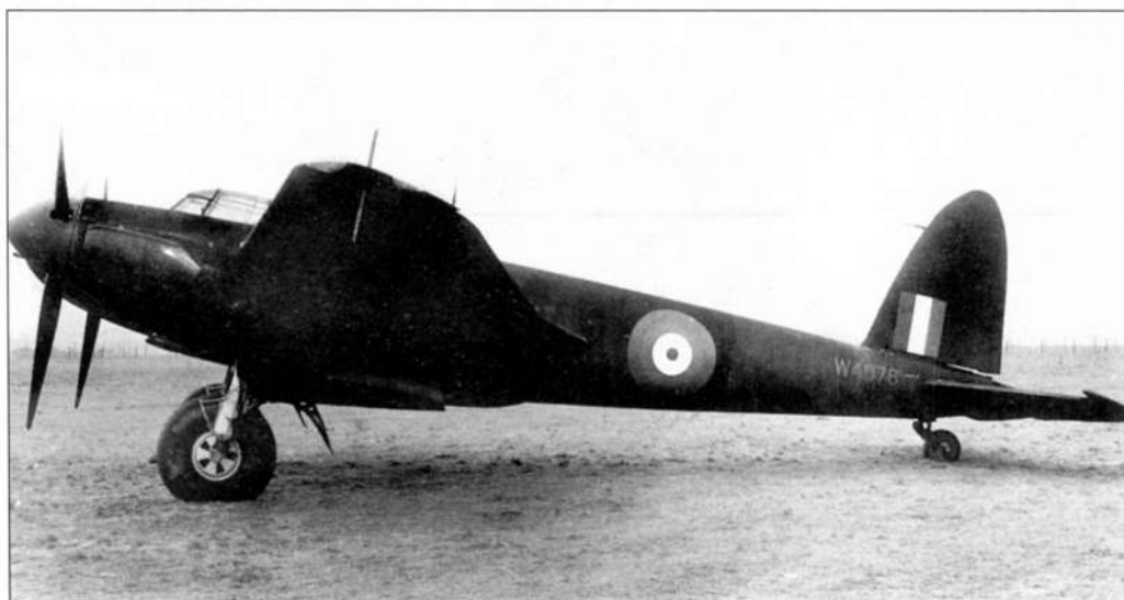
Ночной истребитель W4076 из первой серийной партии машин имел удлиненные мотогондолы, выхлопные патрубки под пламегасителями и радиолокатор AI. Mk. IV с приемными антеннами на консолях крыла
