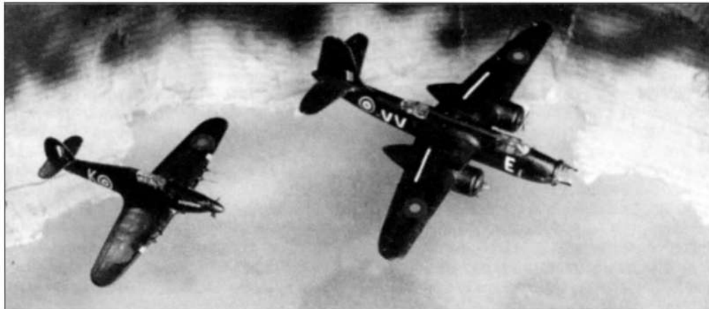
Первым носителем прожектора «Турбинлайт» был переоборудованный американский двухмоторный P-70 «Хэвок», с которым взаимодействовали истребители «Харрикейн»
