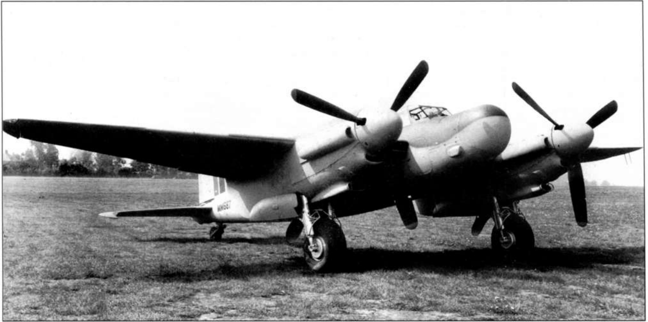
Ночной истребитель NF.Мк.30 с высотными моторами «Мерлин» 72 мощностью 1680 л.с. обладал максимальной скоростью 681 км/ч на второй границе высотности
