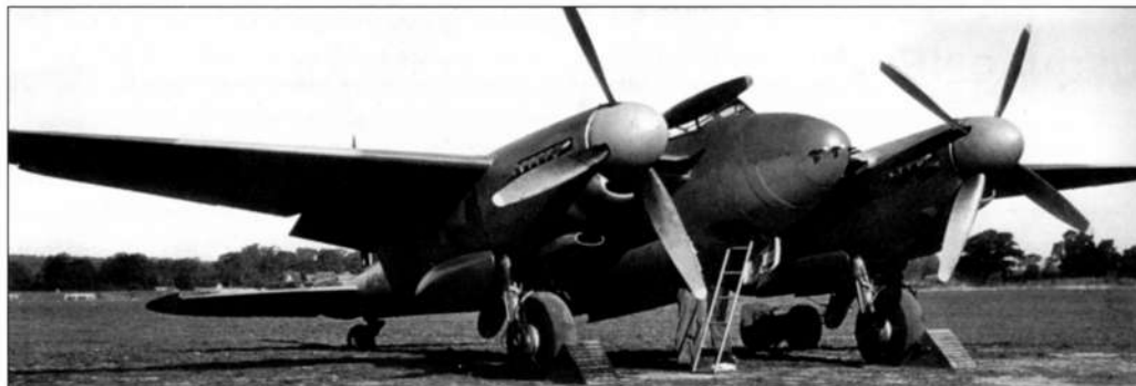
В результате сверхсрочной переделки экспериментального высотного бомбардировщика «Москито» (заводской номер MP469) с гермокабиной и моторами «Мерлин» 61 появился истребитель NF.Мк.XV. В отличие от всех других истребителей «Москито» вход в его кабину осуществлялся через нижний люк, как у бомбардировщиков. Первоначально машина была одноместной
