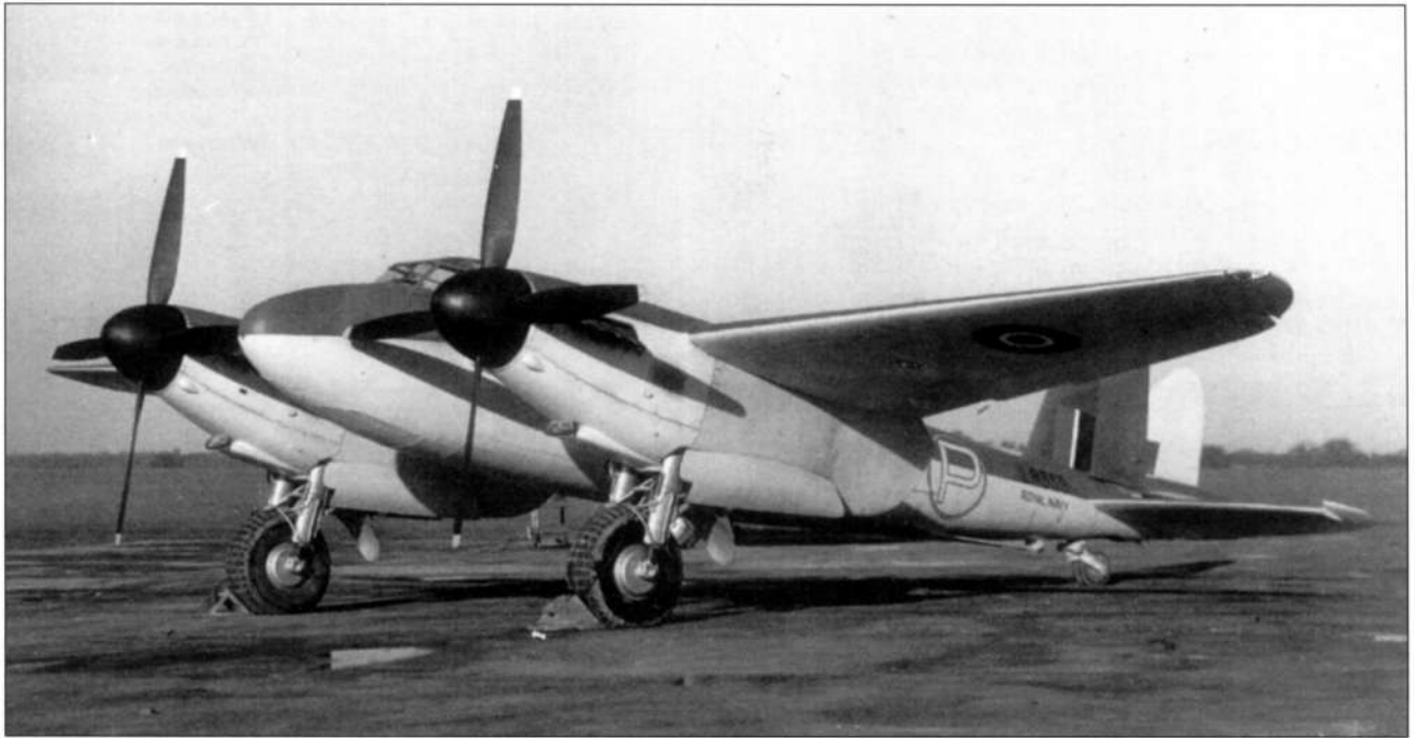
Прототип палубного самолета «Москито» FВ.Мк.VI заводской номер LR359 с четырехлопастными винтами, посадочным гаком, нескладывающимся крылом и пока еще «сухопутными» амортизационными стойками шасси
