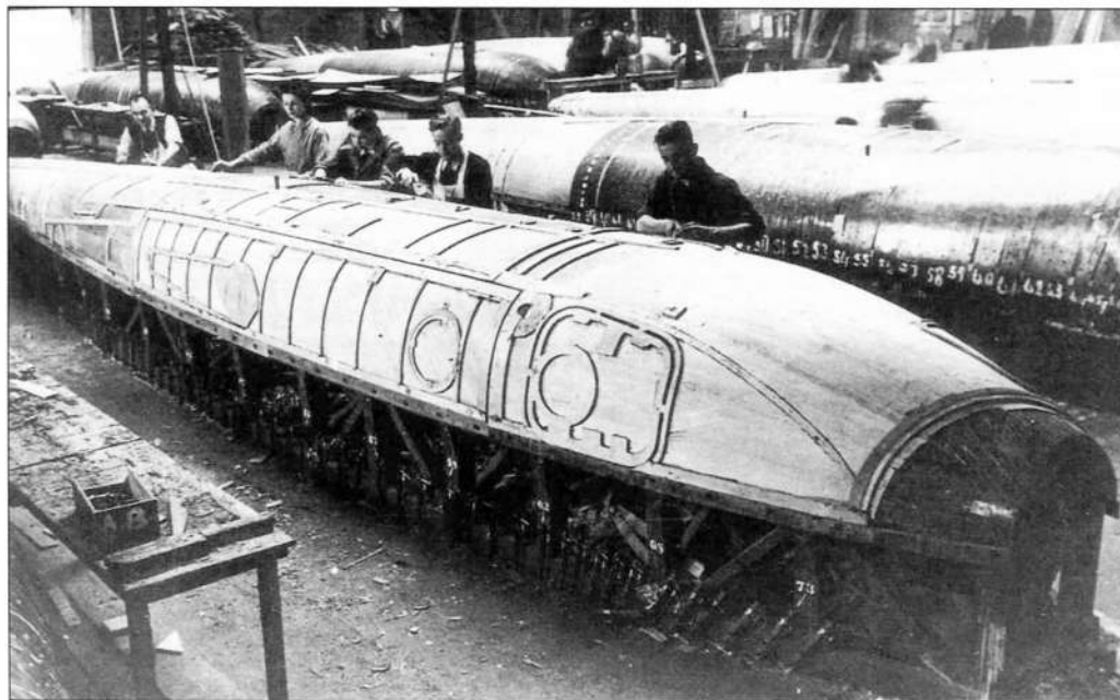
Сборка фюзеляжа «Москито». Внутренняя обшивка половины фюзеляжа выполнена, приклеены усиливающие элементы. Теперь необходимо уложить фрагменты из бальзы, залить все это фенолформальдегидным клеем и наложить внешнюю обшивку, а затем — под пресс
