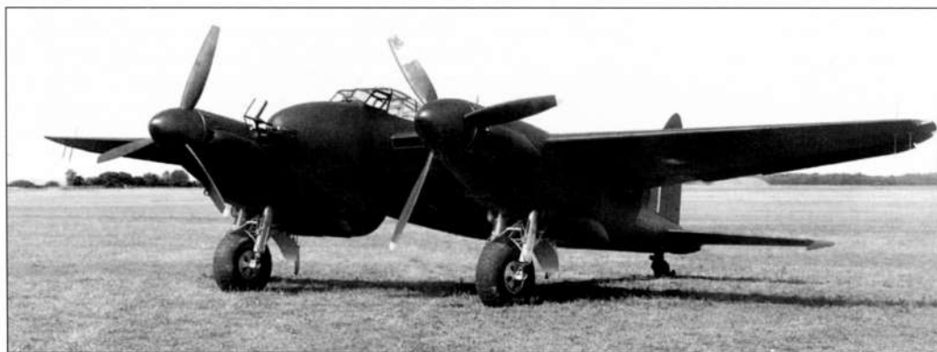
Ночной истребитель «Москито» NF.Mk.II с радиолокатором AI Mk.IV в 1942 г. В носу фюзеляжа монтировали излучающую антенну РЛС, на концах крыла — азимутальные приемные антенны. Угломестная антенна (самолет противника выше-ниже) была установлена на правой консоли крыла в районе мотогондолы
