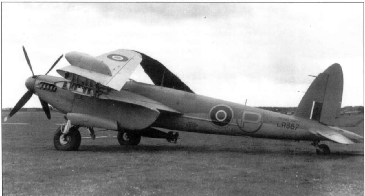
Прототип торпедоносца, «конвертированный» из истребителя-бомбардировщика «Москито» FB.VI заводской номер LR387, получил складное крыло и торпедодержатель под фюзеляжем
