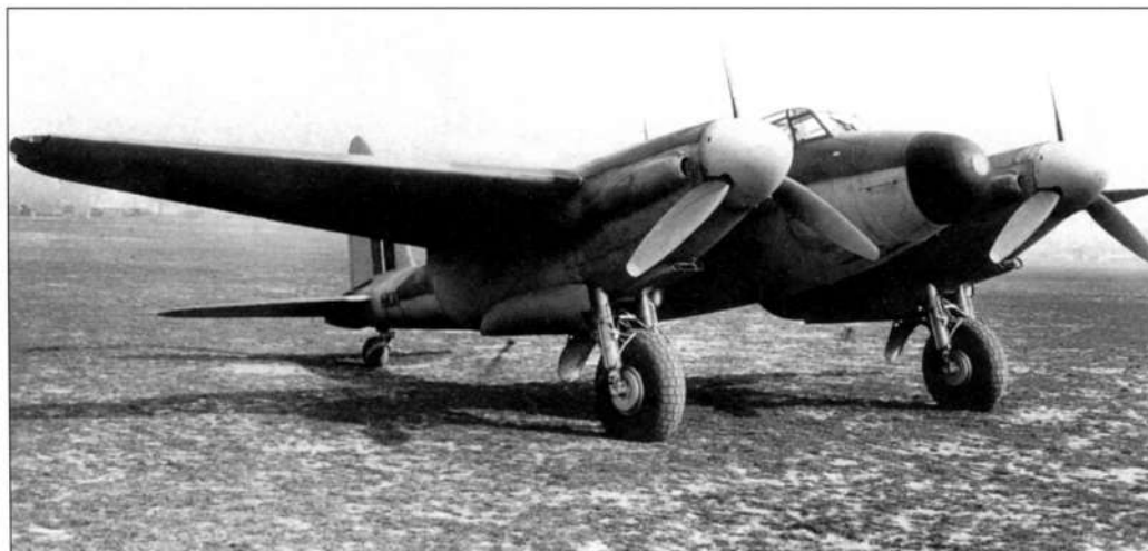
Истребитель «Москито» NF.Mk.XII заводской номер НК117 с радиолокатором сантиметрового диапазона AI.Mk.VIII. Подвижная антенна локатора, сканировавшая вверх-вниз и влево-вправо на 45°, заставила отказаться от носовых пулеметов «Браунинг»
