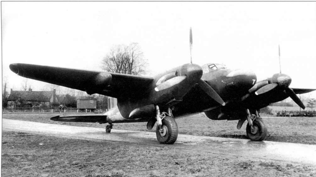
Ночной истребитель NF.Мк.ХІІІ из 29-й эскадрильи. Этот вариант отличался от предшественников так называемым «базовым» (усиленным) крылом от истребителя-бомбардировщика FB.Мк. VI, которое обеспечивало возможность подвески внешних баков под консолями
