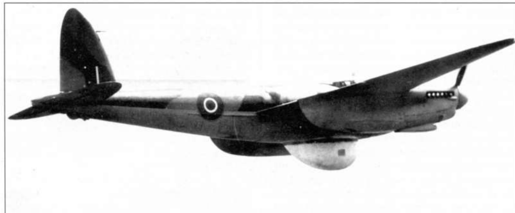
Некоторые В.Мк. XVI подверглись переоборудованию в самолеты-целеназначатели. Такие машины несли в бомбоотсеках блоки радиолокатора H2S, а под «брюхом» в обтекателе — его весьма габаритную антенну
