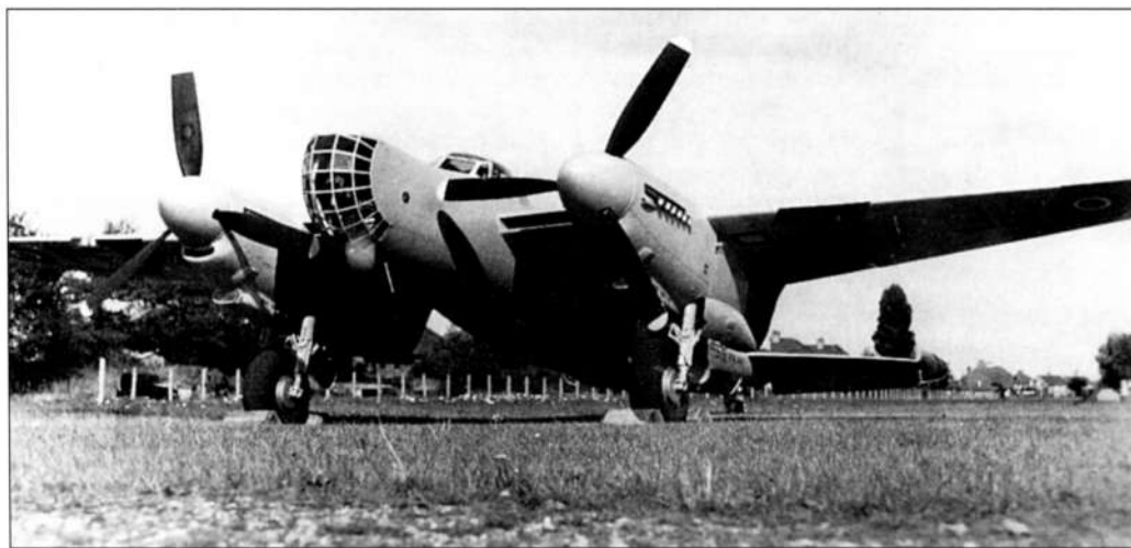
Носовая часть фюзеляжа буксировщика мишеней подверглась солидным переделкам для улучшения условий обзора штурмана
