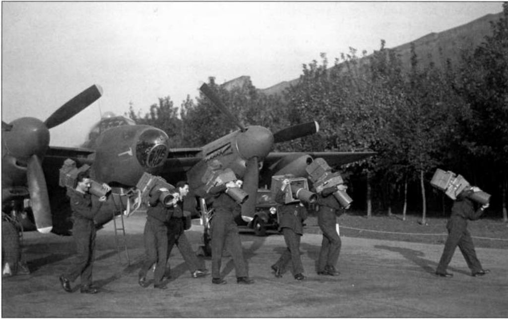
Авиационные фотоаппараты довольно тяжелые и крупногабаритные, поэтому персоналу аэродромной фотолаборатории приходится немало потрудиться. Обратите внимание на левый подкрыльевой бак этого PR.Мк.XVI: внутри него смонтирован еще один аппарат с объективом, ориентированным вперед
