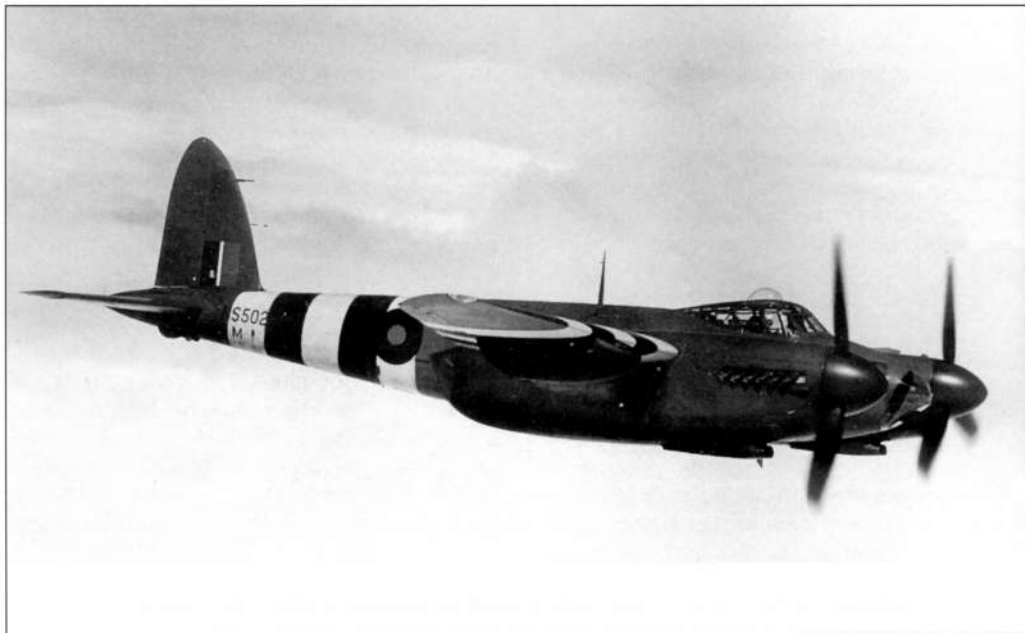
В отличие от предшественников, разведчики PR. Mk. XVI получили герметизированные кабины, что позволяло осуществлять длительные полеты на высотах до 11 000 м. Впрочем, долгое время машины этого типа страдали из-за обмерзания карбюраторов и оттого их экипажи 544-й эскадрильи не рисковали забираться слишком высоко
