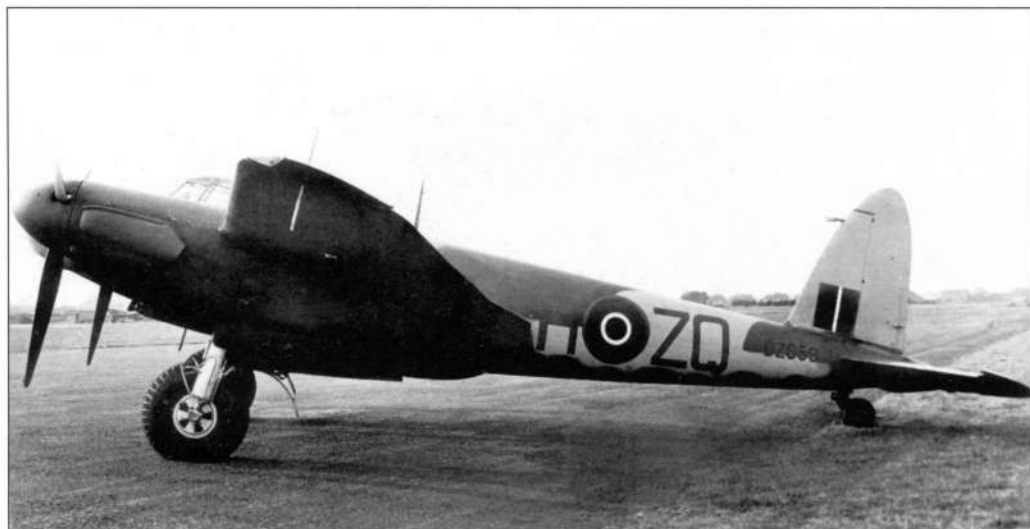
Ночной истребитель NF.Mk.XVII с американским радиолокатором SCR720 в носовом коке
