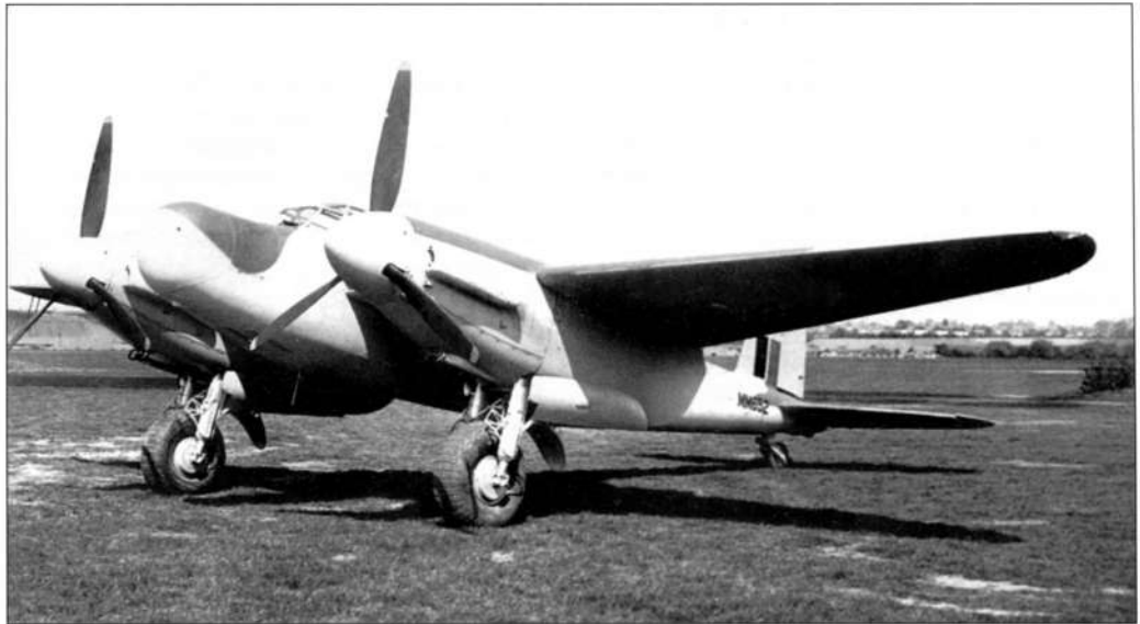
Ночной истребитель NF.Мк. XIX мало отличался от NF. Мк. XVII: на нем установили несколько более мощные моторы «Мерлин» 25, а также «универсальный» носовой кок, позволявший монтировать под ним несколько вариантов радиолокаторов, включая американские
