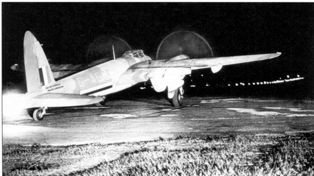
Стартует один из самолетов ВОАС. Такие машины летали с дипломатической почтой из Англии (позднее из Италии) в СССР. Изначально G-AGGF был изготовлен в варианте истребителя-бомбардировщика FB. Mk. VI
