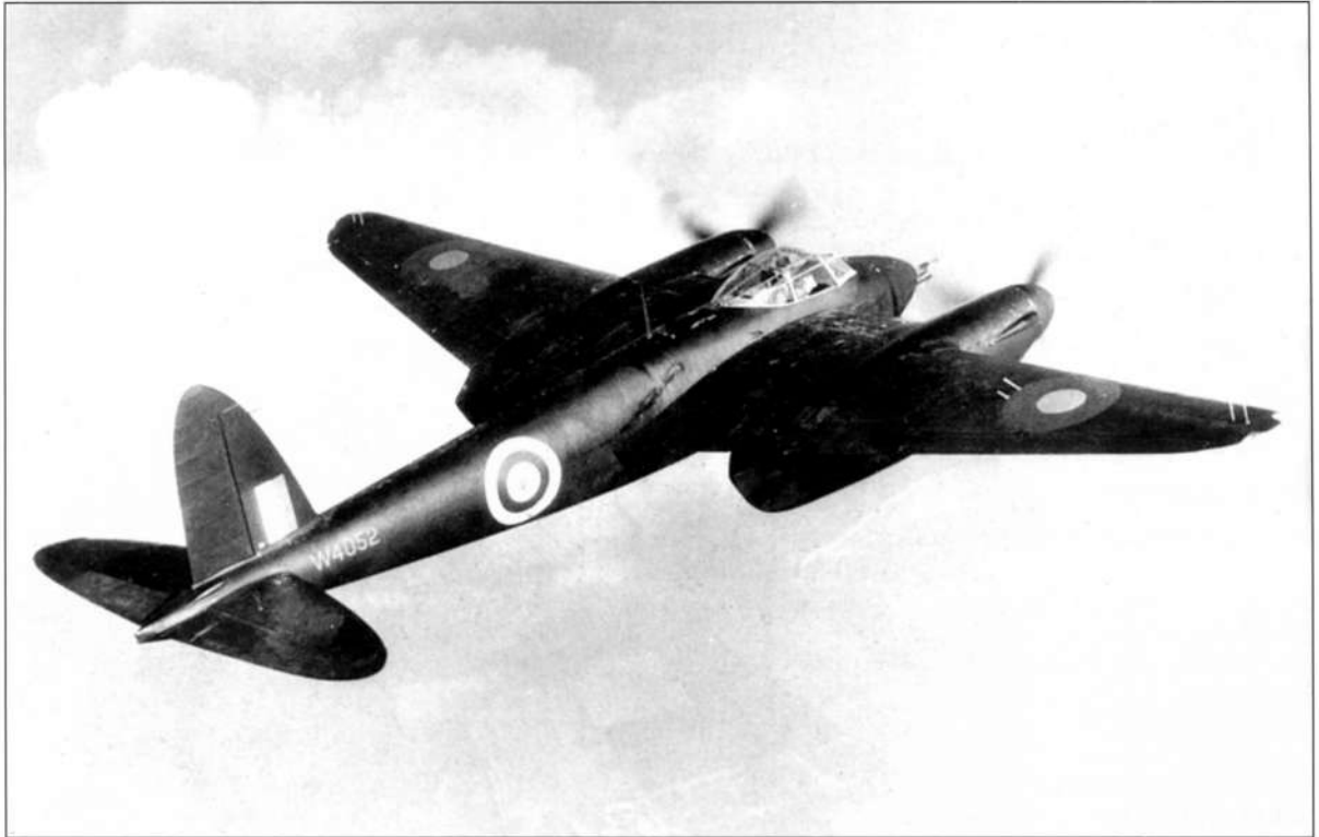
Первый полет окрашенного целиком в черный цвет истребителя F.Mk.II с заводским номером W4052 состоялся 15 мая 1941 г. В варианте ночного истребителя NF.Mk.II такие машины оснащались радиолокаторами AI.Mk.IV или AI.Mk.V
