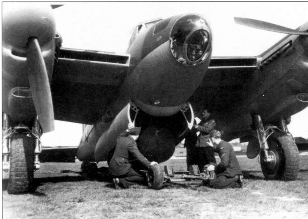
«Куки» не имела оперения и кувыркалась на траектории, поэтому ее конструкция предусматривала наличие нескольких ударных взрывателей для обеспечения всюдубойности
