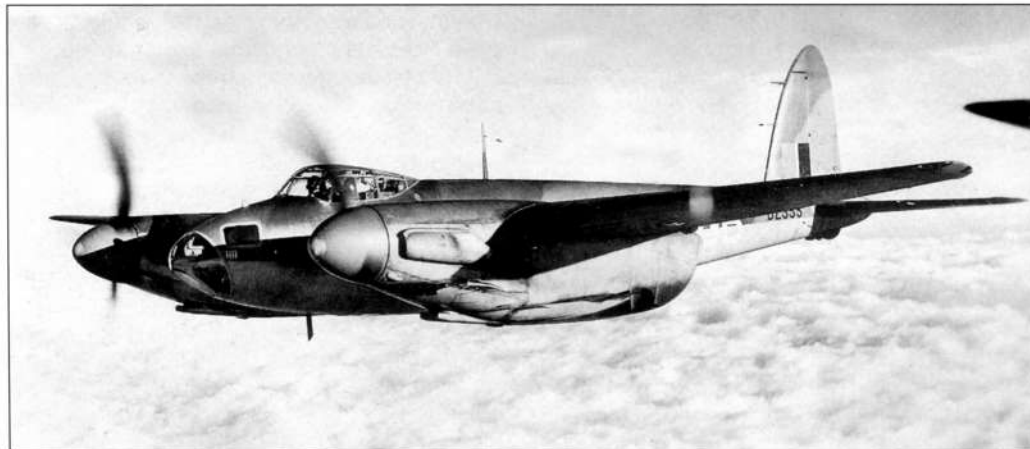
Бомбардировщики «Москито» В.Мк.ІV из 105-й и 109-й эскадрилий оснащались невысотными двигателями «Мерлин» 23 и, вопреки легендам, с самого начала боевого применения несли чувствительные (по английским меркам) потери
