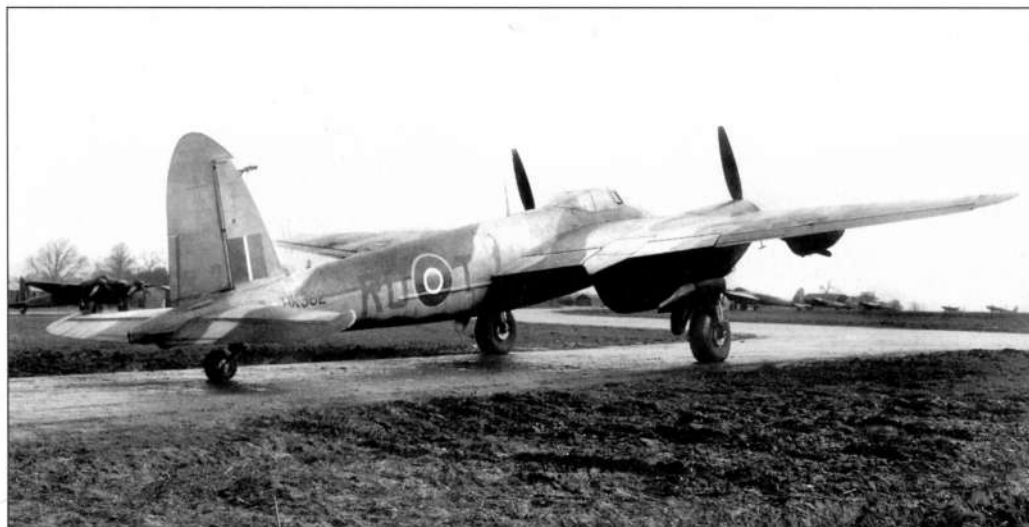
Первый полет головной серийный NF.XIII совершил в августе 1943 г. Благодаря улучшению аэродинамики истребитель развивал максимальную скорость 634 км/ч
