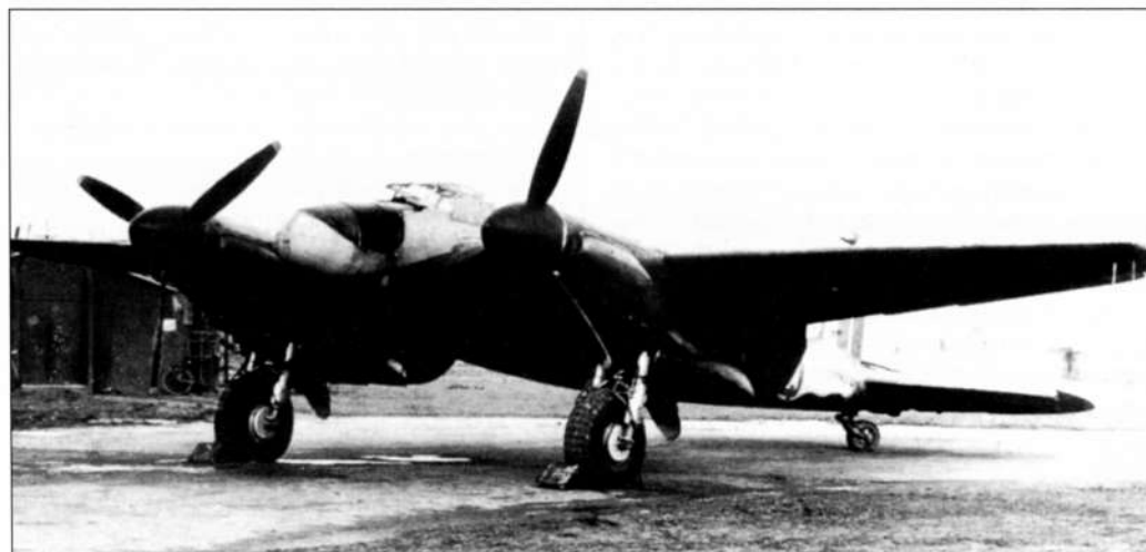
Ночной истребитель «Москито» NF.XIII с планером от FB.VI с усиленным «универсальным» крылом и силовой установкой, а также с радиолокатором от NF.XII
