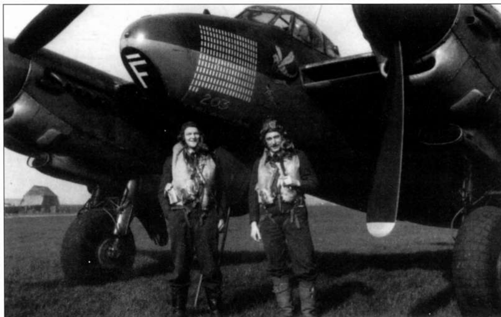
Флайт-лейтенанты Лоуренсон и Аллен у самолета «Москито» В.Мк. IX, совершившего 213 боевых вылетов (максимальное число для самолета данного типа). В носовом коке смонтирована аппаратура разнодно-дальномерной станции Обое. Самолет и экипаж погибли в ходе агитационного тура по Канаде
