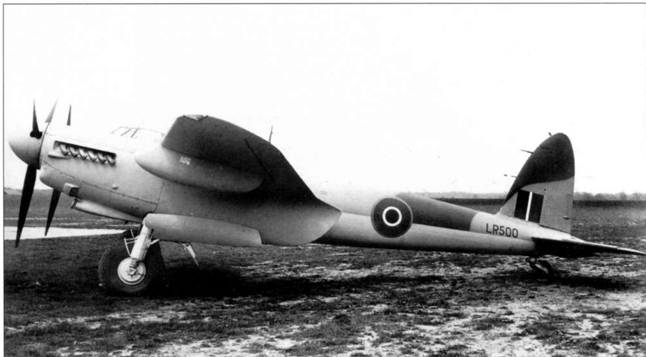
Шестой серийный бомбардировщик «Москито» В.Мк.IX весной 1943 г. был передан в 109-ю эскадрилью. Ранние машины этой модификации оснащались моторами «Мерлин» 72/73 максимальной мощностью 1680 л.с.
