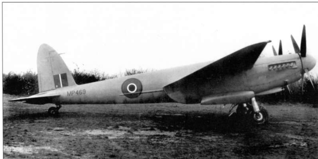
Винты NF.Мк.XV были четырехлопастными, радиолокатор отсутствовал. На фото — один из пяти специализированных высотных истребителей, ни одному из которых так и не удалось поучаствовать в воздушном бою
