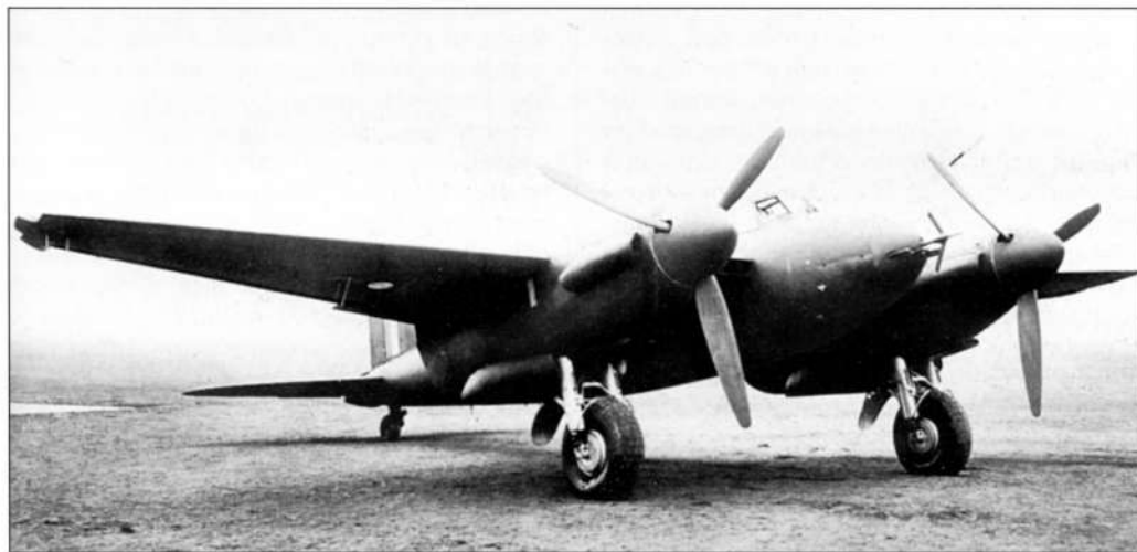
В носовом коке фюзеляжа этого NF. Mk. II смонтирован радиолокатор AI. Mk. V с излучающей антенной. Приемные антенны угла места цели видны слева от фары, а приемные антенны азимута цели — на концах консолей
