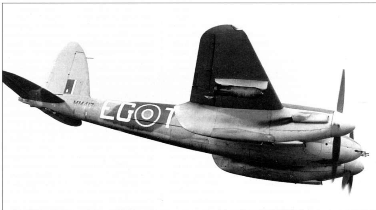
Истребители-бомбардировщики «Москито» FB.Мк.VI оснащались маловысотными вариантами мотора «Мерлин» 23 или 25. На подкрыльевых держателях они были способны нести две бомбы калибром 500 фунтов, а во внутрифюзеляжном отсеке — еще четыре такие же бомбы. При этом сохранялось мощное пулеметно-пушечное вооружение истребителя
