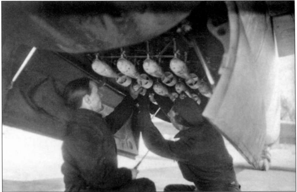
Нанесение ударов с применением малокалиберных бомб «Москито» практиковали очень редко, но все же соответствующий вариант вооружения был отработан
