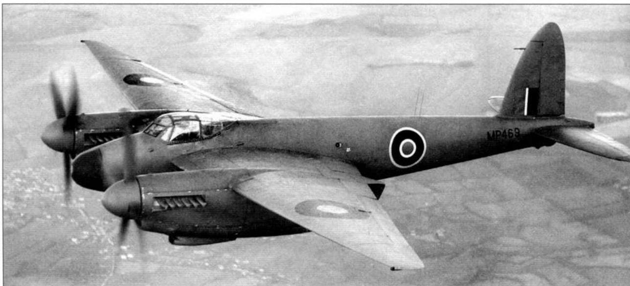
Размах крыла NF.Мк.ХV возрос до 19,1 м, а массу истребителя постарались предельно уменьшить для повышения высотности. Фонарь кабины с лобовым стеклом из двух частей, в то время как у других истребителей лобовое бронестекло было плоским
