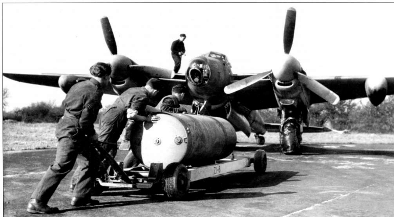
В огромный внутрифюзеляжный бомбоотсек «Москито» В.Мк.XVI с небольшими зазорами помещалась 1800-килограммовая фугасная бомба «куки», по форме напоминавшая упаковку печенья с одноименным названием
