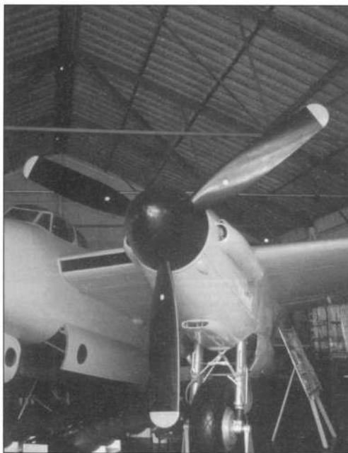
Левая мотогондола бомбардировщика с двигателем «Мерлин» 23
