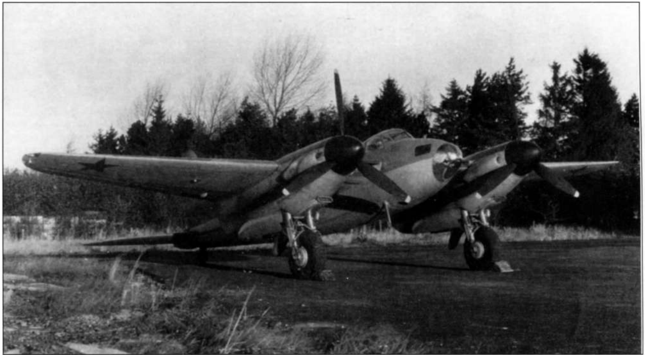
Бомбардировщик «Москито» В.Мк. IV заводской номер DK296 проходил испытания в ЛИИ НКАП весной 1944 г. Машина была не новой, выпуска лета 1942 г., с моторами «Мерлин» 21
