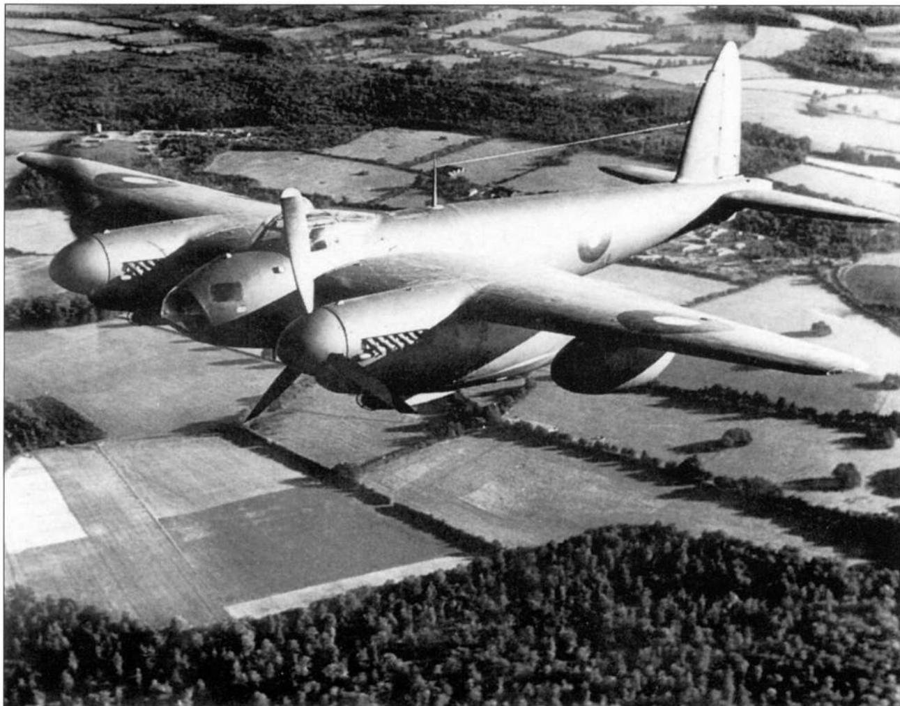
Высотный самолет-разведчик PR.Мк. IX с двигателями «Мерлин» 72/73. Прототип машины этого типа (LR405) совершил первый полет в апреле 1943 г. На фото запечатлен фрагмент испытаний самолета с выключенным левым мотором
