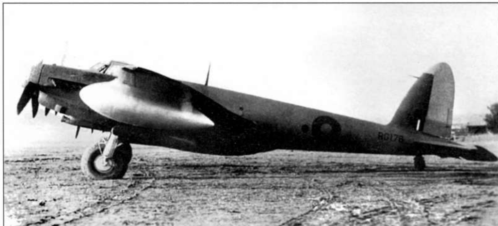
Первый серийный «Москито» PR. Mk.34 заводской номер RG176. С установленными дополнительными внутрифюзеляжными (в отсеке нагрузки) баками и огромными подкрыльевыми емкостями дальность полета машины превышала 5000 км
