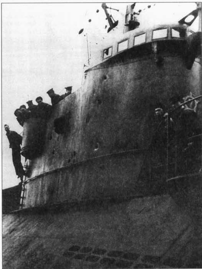
Повреждения «Л-20», полученные в результате пушечно-пулеметного обстрела германского самолета 9.5.1944.
