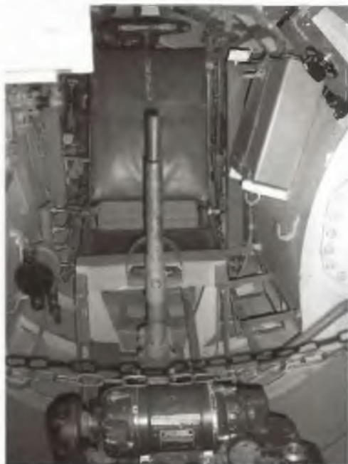
Рычаг горизонтального и вертикального рулей СМПЛ «Зеехунд», Немецкий музей предметов науки и техники в Мюнхене
