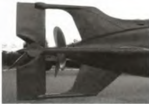
Американская СМПЛ X-1 вобрала в себя ряд техни- ческих «изюминок» немецкого «Зеехун- да». Особенно хоро- шо сходство видно по винторулевому комплексу
