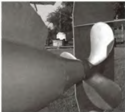
Трехлопастный гребной винт «Зеехунда»
