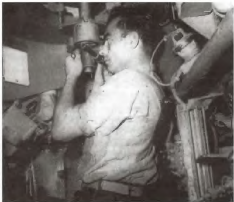
Место командира подводной лодки. Жорж Тибо, инженер-механик одного из французских трофейных «зеехундов», позирует перед командирским перископом. Фото из архива Клауса Маттеса
