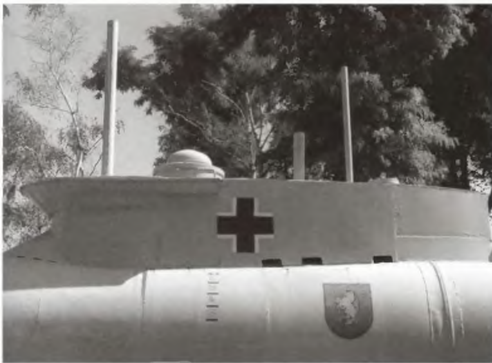
На этой фотографии СМПЛ типа «Зеехунд», установленной в качестве экспоната в немецком Музее техники и транспорта, хорошо видны детали надстройки субмарины. В частности, слева видна труба командирского перископа, затем идет плексигласовый колпак рубочного люка, затем — мачта с чувствительными элементами главного магнитного компаса (это уже ее имитация), после нее — непонятная труба, которая, скорее всего, имитирует мачтовое устройство с антенной радиостанции. Последней идет шахта «шнорхеля». Фото из архива Музея техники и транспорта
