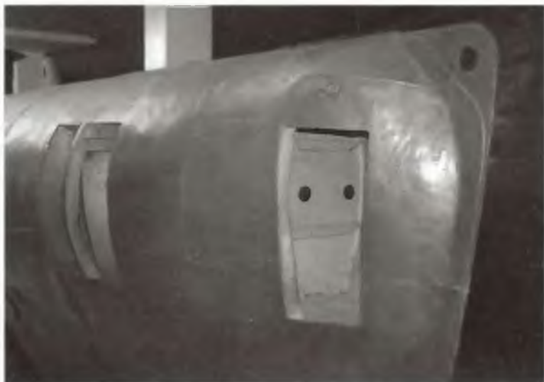
Носовая часть «Зеехунда», виден вырез в районе отсека приема забортной воды. Фото из архива автора
