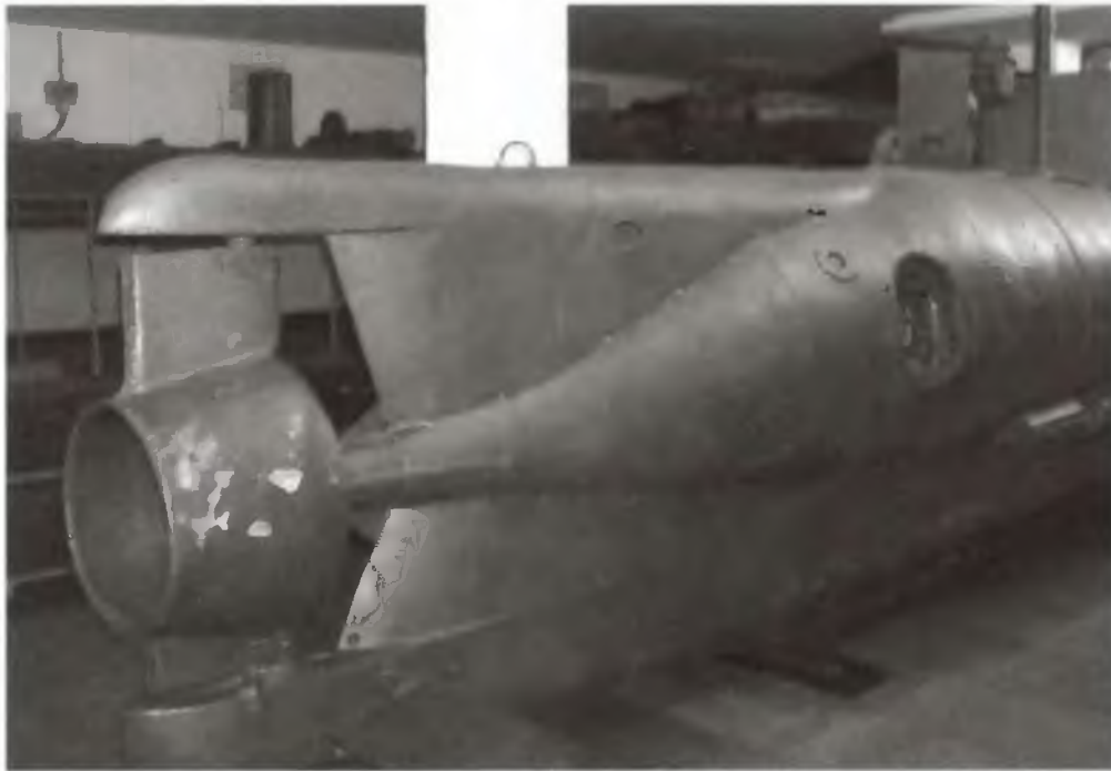
Вид на кормовую секцию «Зеехунда» и его винто-рулевую группу. Хорошо виден вертикальный профилированный руль и насадка Корта. Фото из архива автора
