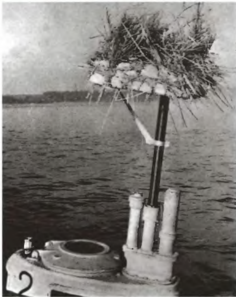
Водители «биберов» часто маскировали перископы своих подлодок под плавучие птичьи гнезда. Данные фотографии сделаны на Балтийском море в начале 1945 г.
