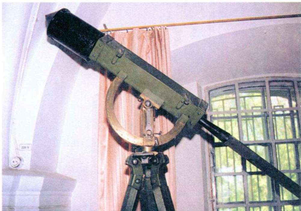
XXX. Пусковой станок и 2-дюймовая ракета Константинова
