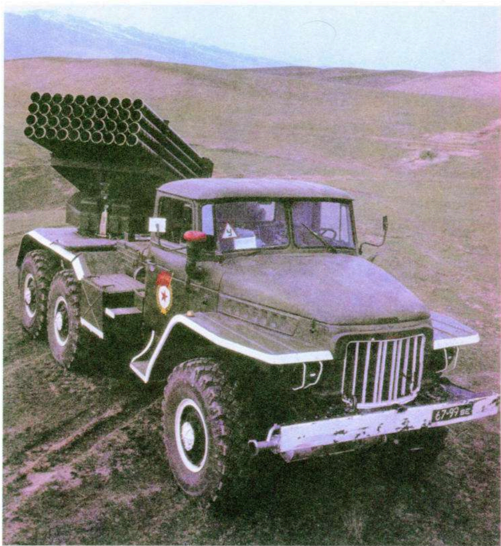
XI. Ракетная система залпового огня «Град»
