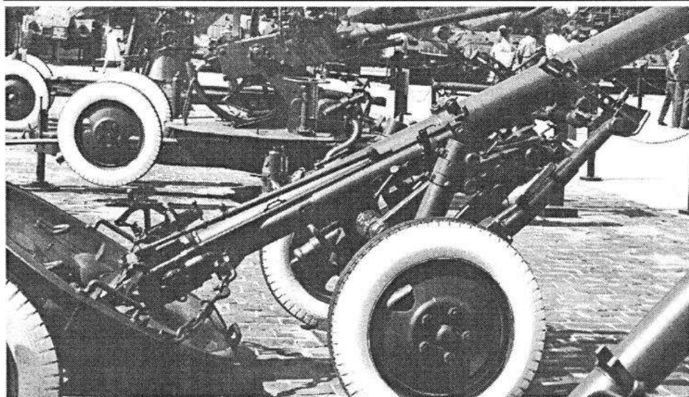
Рис. 67. 160-мм миномет М-160 (опорная плита)
