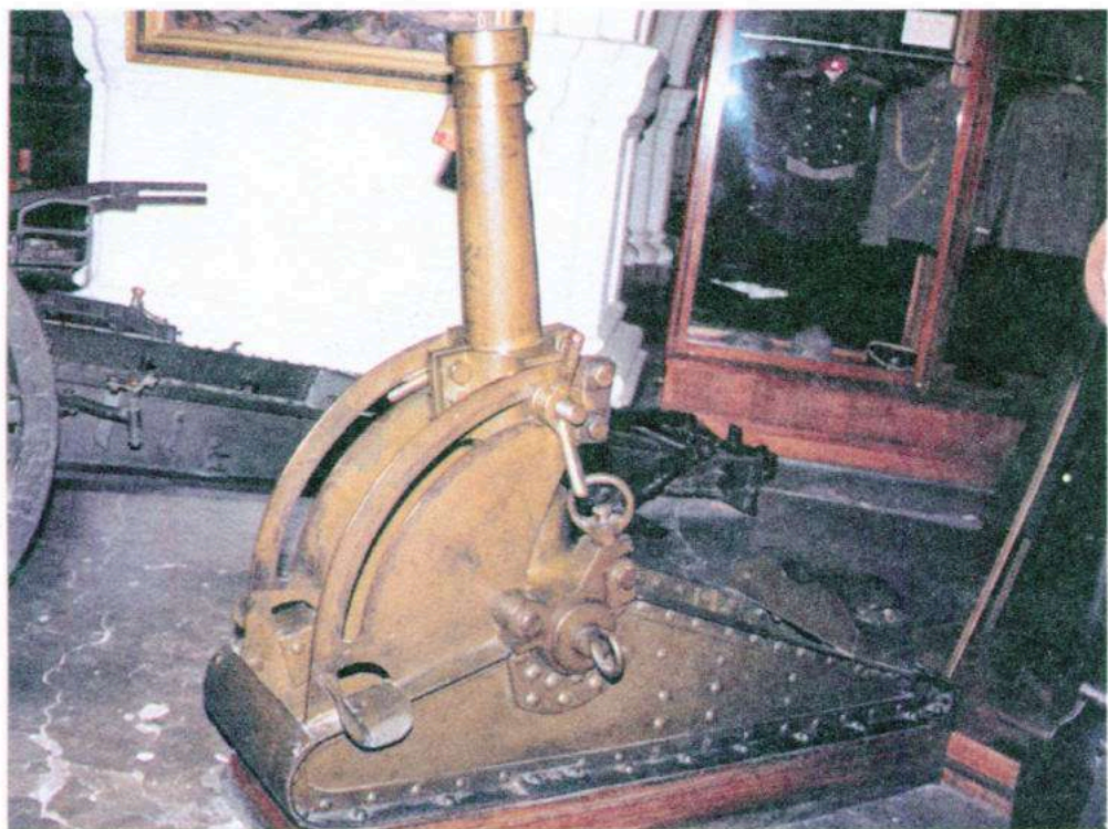
IX. 89-мм миномет Ижорского завода
