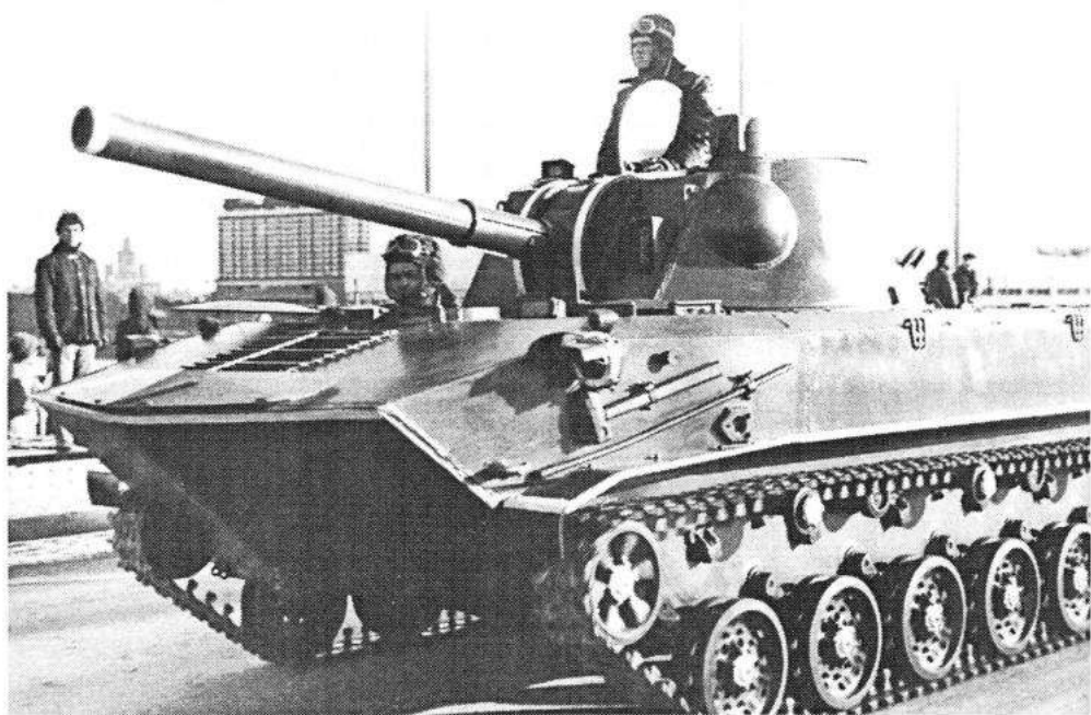
Рис. 64. 120-мм миномет «Нона-С» 2С9 (вид спереди)
