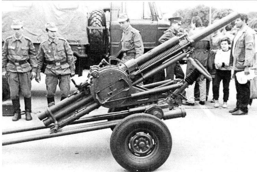
Рис. 57. 82-мм миномет «Василек» в походном положении
