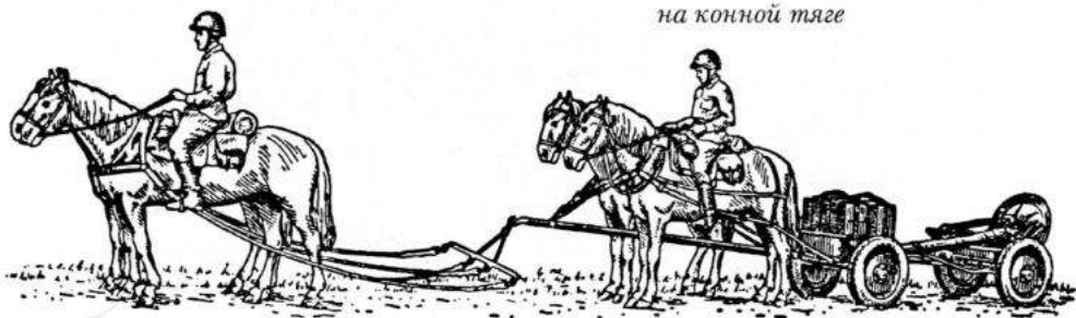
Рис. 37. 107-мм горно-вьючный полковой миномет обр. 1938 г. в походном положении в прицеле за передком на конной тяге
