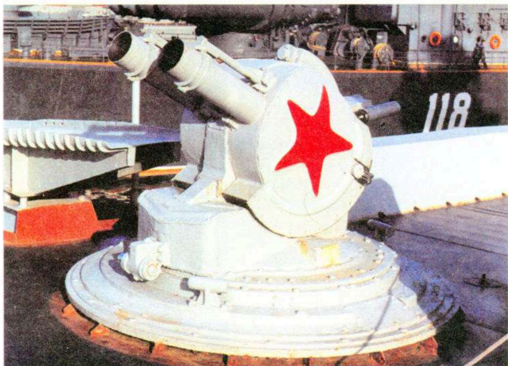
ЛШ. Корабельная пусковая установка ЗИФ-121
