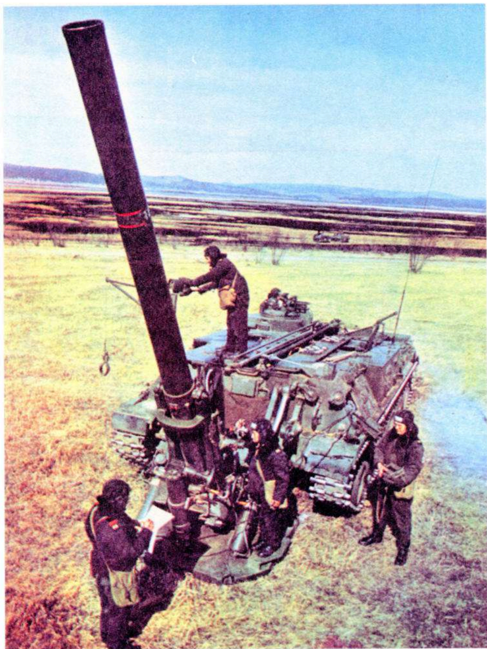
XXV. 240-мм миномет «Тюльпан» в боевом положении
