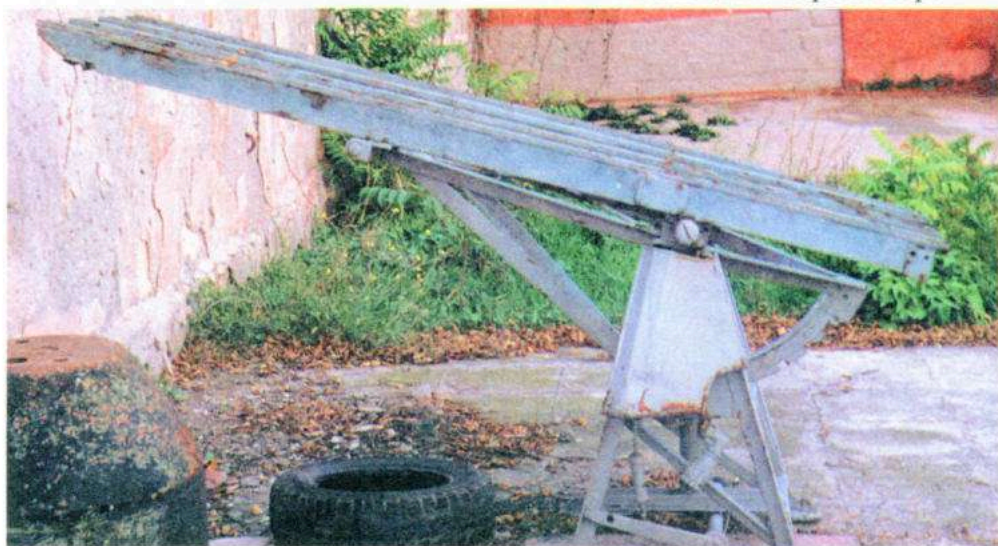
XXXIII. Кустарная установка для пуска четырех ракет М-8. Монтировалась на катерах в 1942 г. на Черном море
