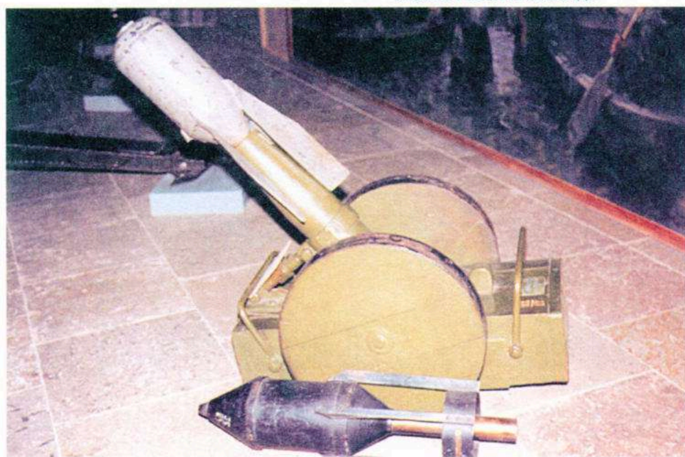
VI. 58-мм миномет ФР на деревянном станке Невского завода
