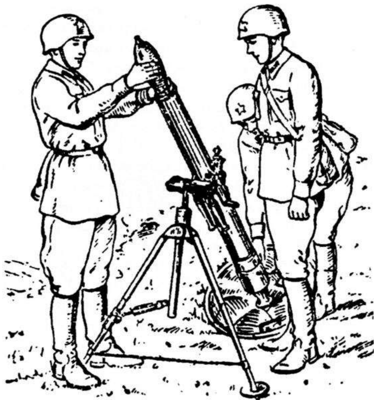
Рис. 41. Заряжание 107-мм горного миномета обр. 1938 г.
