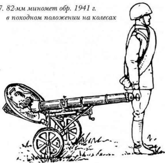
Рис. 28. 82-мм миномет обр. 1943 г. в походном положении на колесах
