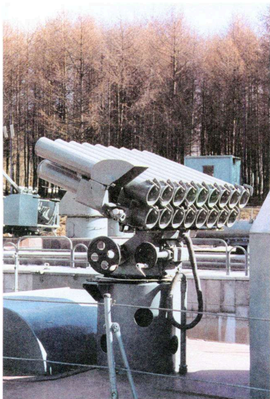
ЛП. 17-ствольная пусковая установка для 140-мм ракет на палубе бронекатера проекта 1204
