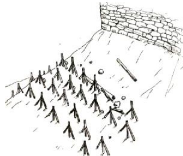
Рис. 164. Защита от скатываемых предметов с помощью трезубцев
