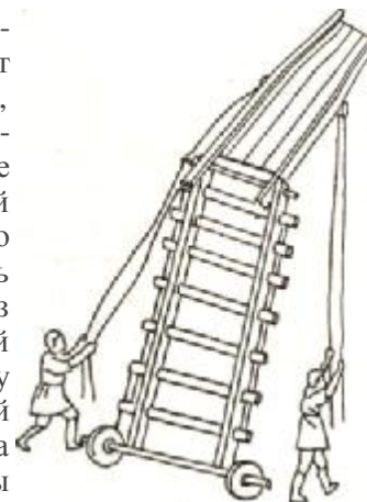
Рис. 32. Лестница с перекидным мостиком. По книге Анонима Византийского* «Инструкции по полиоркетике»
