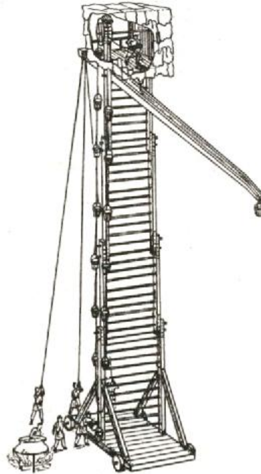
Рис. 34. Сооружение из лестниц для поливания защитников кипятком или кипящим маслом
