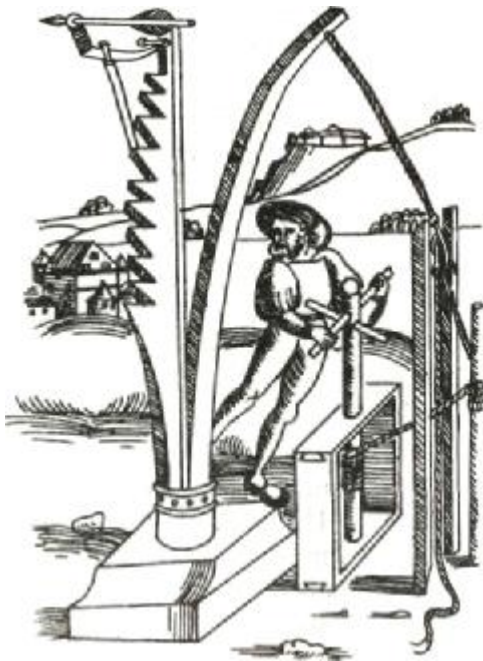
Рис. 136. Схематичный рисунок стреломета бриколь. По изданию Вальтурио, 1453/54 г.
