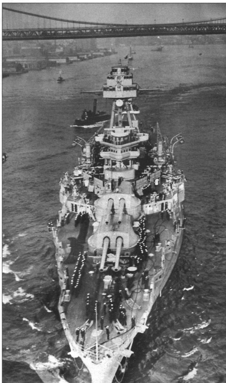
Линкор «Техас» после завершения модернизации, ноябрь 1926 г. Слева: «Техас» в Нью-Йорке. Хорошо виден флагманский мостик над ходовой рубкой, появившийся в конце 1920-х гг.
