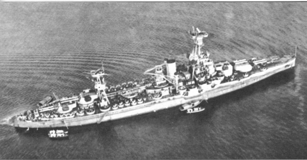
Вид на «Нью-Йорк» с воздуха: хорошо видны установленные в 1944 г. многочисленные зенитные автоматы
