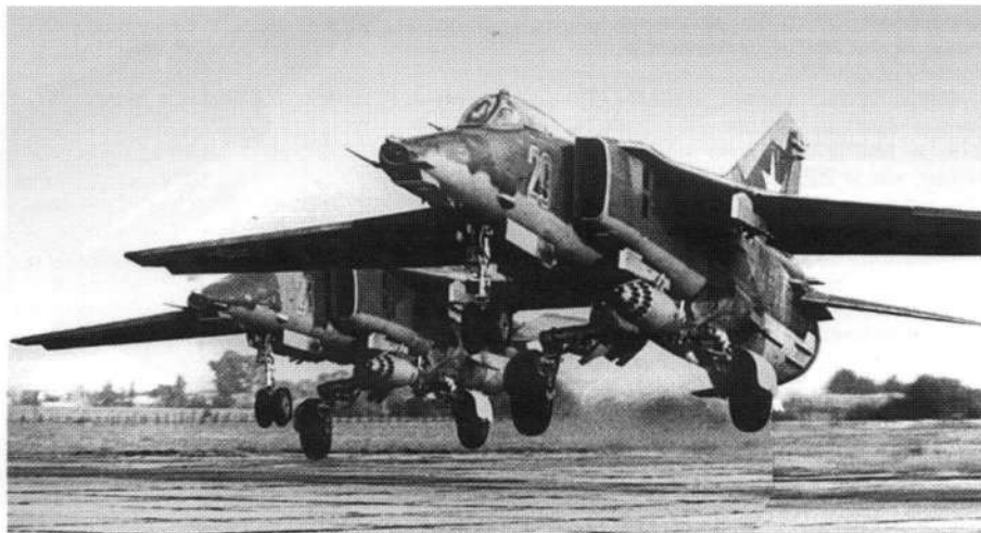
Взлет парой МиГ-27К. Для выполнения учебной задачи самолеты несут только по одному блоку УБ-32А-73
