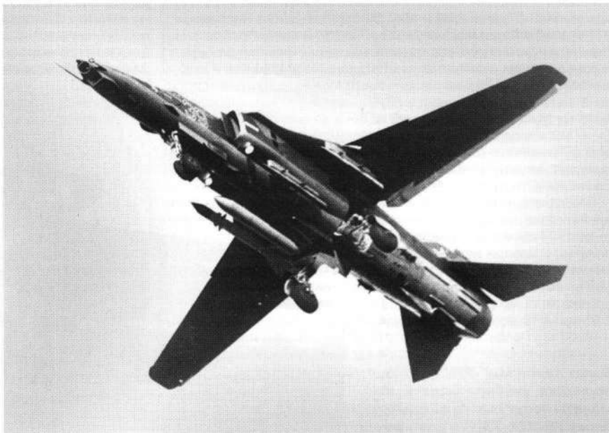
В полете МиГ-27К 266-го апиб с противорадиолокационным вооружением – ракетой Х-27ПС литеры А' и контейнером с аппаратурой управления «Вьюга»
