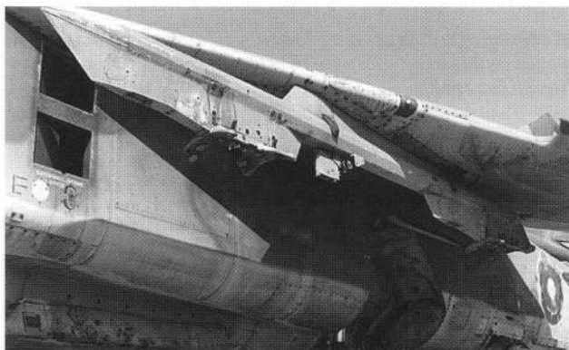
Установка многозамкового балочного держателя МБДЗ-У2Т-1 на МиГ-23БН
