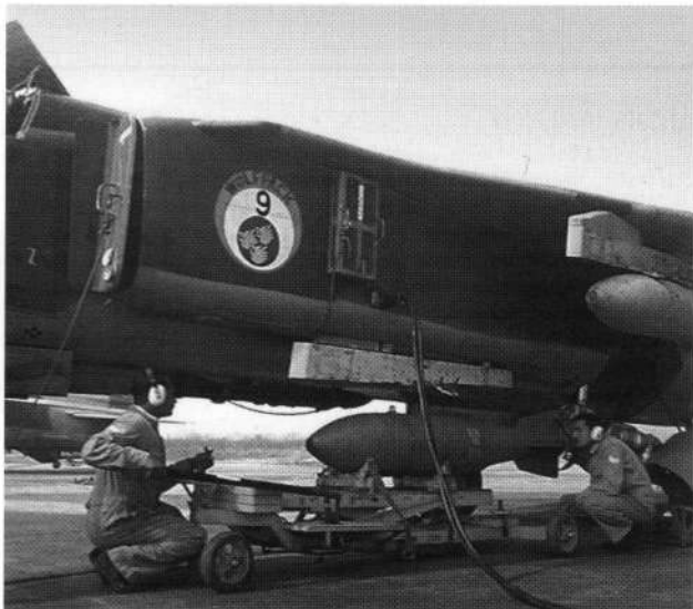
Подвеска фугасной авиабомбы ФАБ-500М-62 под фюзеляж индийского МиГ-27М
