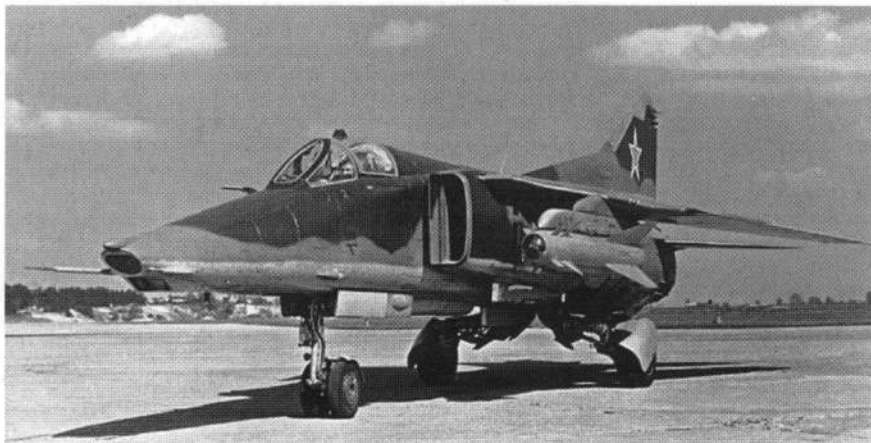
Опытный образец МиГ-23БК с четырьмя управляемыми ракетами Х-29Т на катапультных устройствах АКУ-58-1
