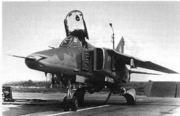
МиГ-27Д на стоянке. Рядом видна колонка ЦЗТ и кабели централизованной системы электроснабжения
