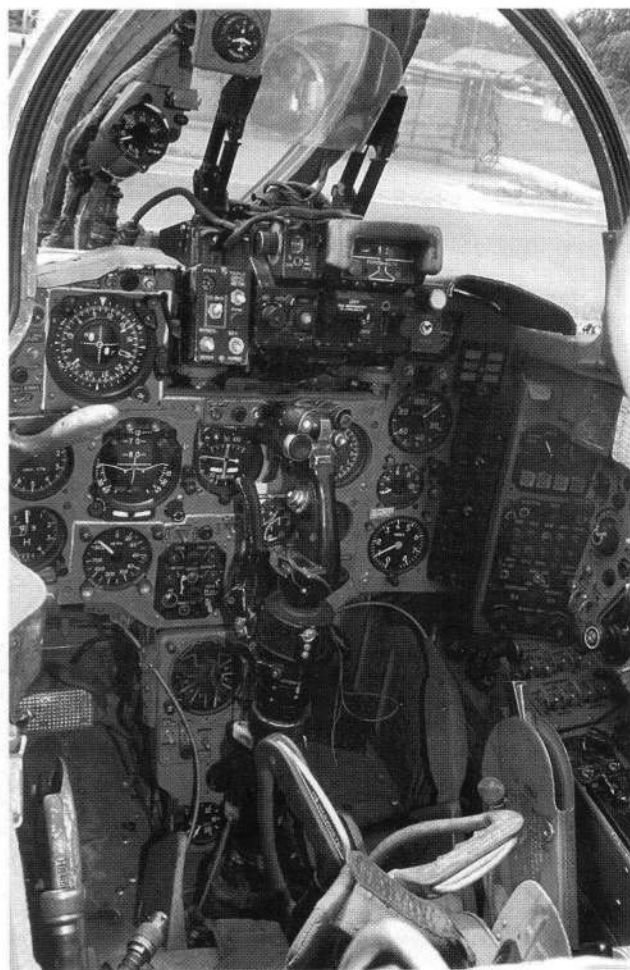
Приборная доска самолета МиГ-27. На козырьке фонаря слева размещены индикатор станции «Сирена-3М» и указатель угла атаки УУА-1А
