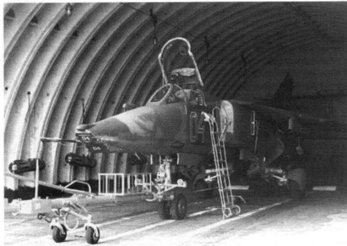
МиГ-27К 559-го апиб в укрытии, на стенах которого подвешены осколочно-фугасные авиабомбы ОФАБ-250-270. Бомбы входят в первый боекомплект, который предписывалось хранить рядом с самолетом для вылета по тревоге
