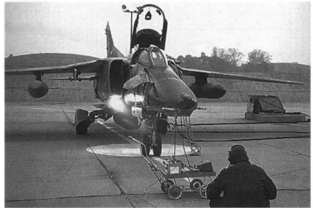
Проверка оборудования МиГ-27К 559-го апиб на ЦЗТ аэродрома Финстервальде. Контрольная аппаратура установлена на самодельной тележке, сделанной на «шасси» детской коляски
