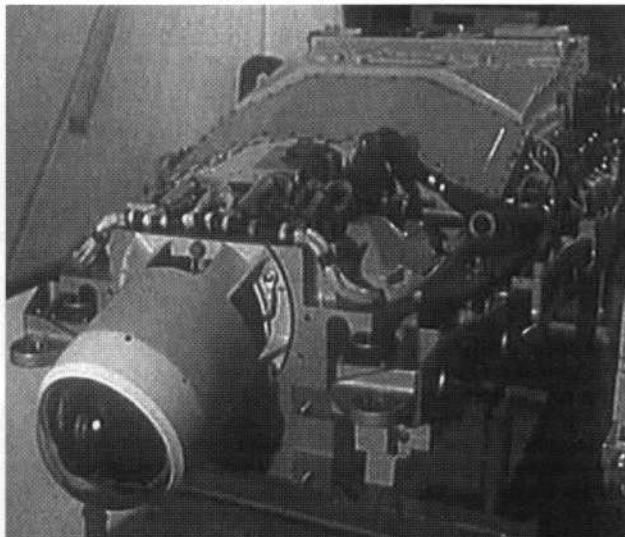
Моноблок лазерно-телевизионной прицельной системы «Кайра-23» (изделие 16С1)
