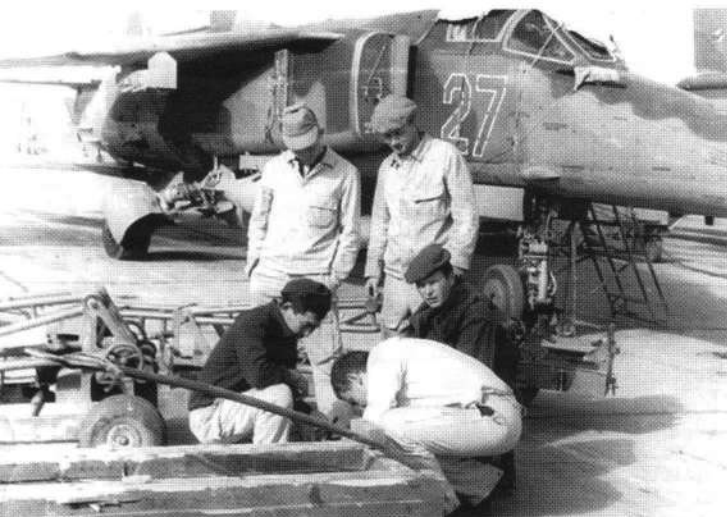
Техники занимаются подготовкой тележек и подъемников для подвески вооружения. Стоящий рядом МиГ-27Д снаряжен парой авиабомб ФАБ-500 М-62. Шинданд, ноябрь 1988 г.
