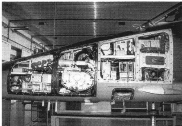
Большие эксплуатационные люки в носовой части МиГ-23БН обеспечивали удобный подход к оборудованию
