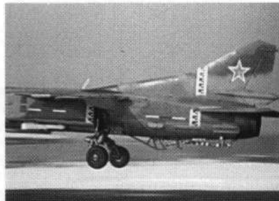
Посадочный гак в хвостовой части летающей лаборатории на базе МиГ-27
