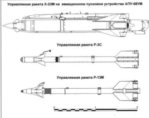
«Длинная рука» МиГ-27 – управляемая ракета X-23M (изделие 68M)
