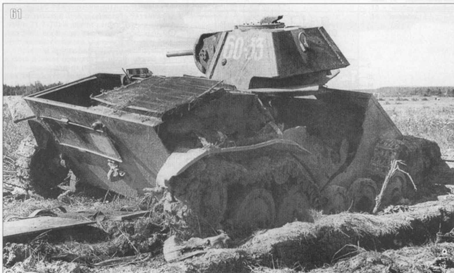
61. Легкий танк Т-70, разбитый во время боев на дальних подступах к Сталинграду. Сентябрь 1942 года. Машина имеет башенный номер 60-33, на корме корпуса закреплена крышка жалюзи для доступа воздуха к радиатору, которая устанавливалась в холодное время года (АСКМ).
