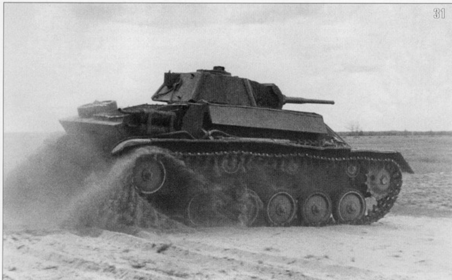
31, 32. Фото того же Т-70М, что и на фото 29, 30. 1-й Белорусский фронт, лето 1944 года. Хорошо видны выхлопные трубы и антенный ввод на кормовом листе башни (АСКМ).
