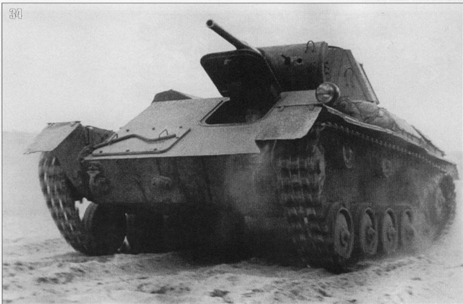
33, 34. Фото того же Т-70М, что на предыдущих фото. 1-й Белорусский фронт, лето 1944 года. В открытом люке виден смотровой прибор механика-водителя (АСКМ).
