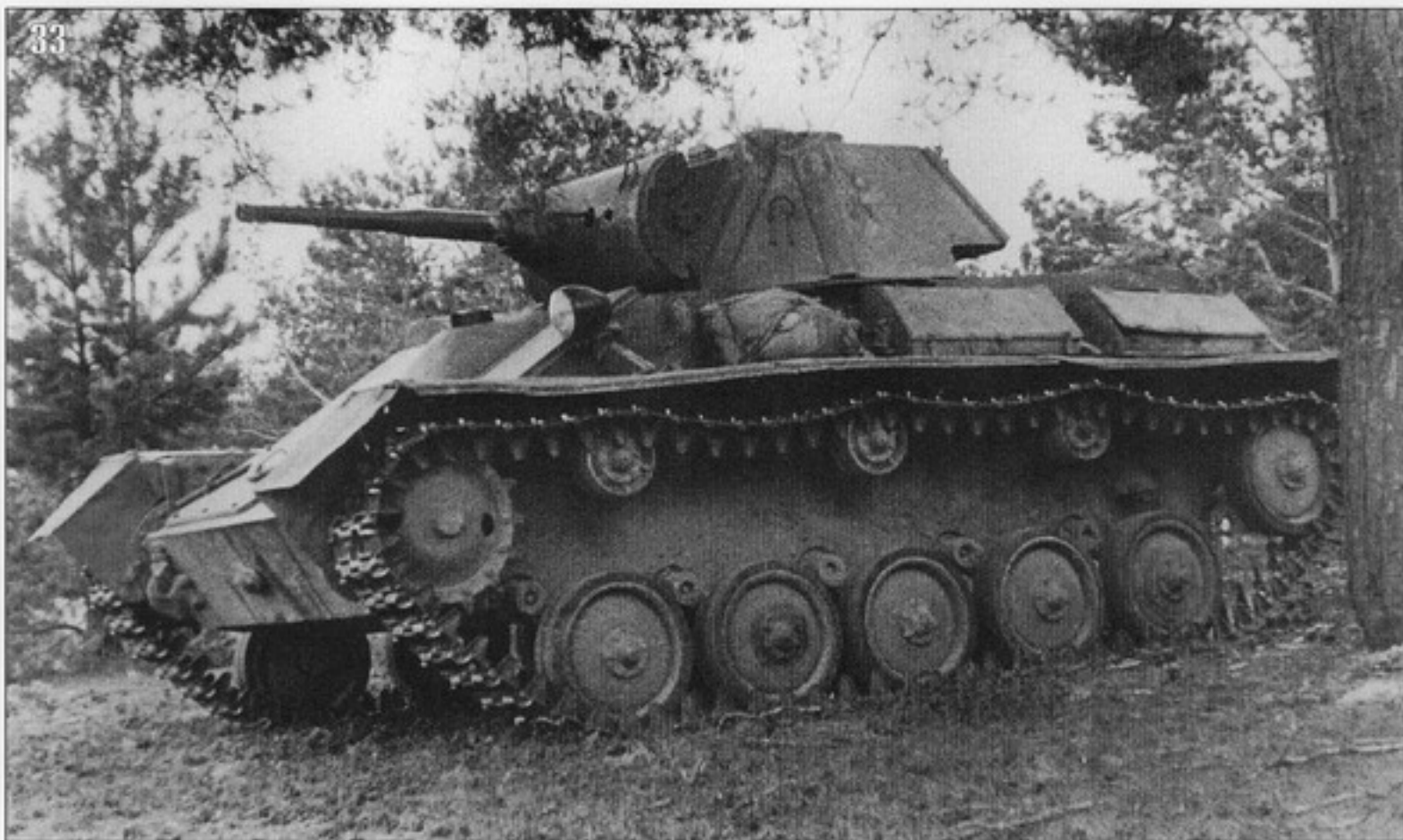
33, 34. Фото того же Т-70М, что на предыдущих фото. 1-й Белорусский фронт, лето 1944 года. В открытом люке виден смотровой прибор механика-водителя (АСКМ).
