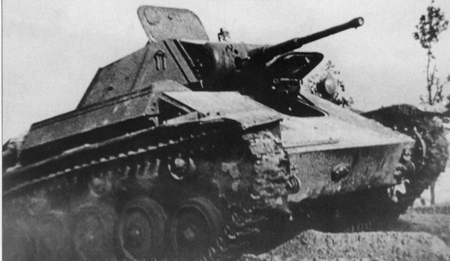
21, 22. Испытания танка Т-70 с двухместной башней в окрестностях Горького. Сентябрь 1942 года. На фото хорошо видна конструкция башенного люка (фото ГАЗ).
