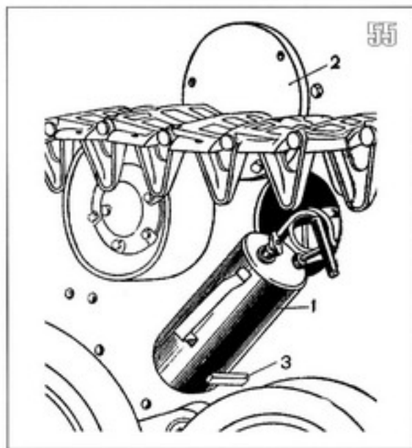
55. Установка лампы на борту танка Т-70 для запуска двигателя в зимнее время (из краткого руководства службы по танку Т-70 издания 1943 года): 1 – лампа, 2 – броневая крышка люка, 3 – кронштейн для лампы.
