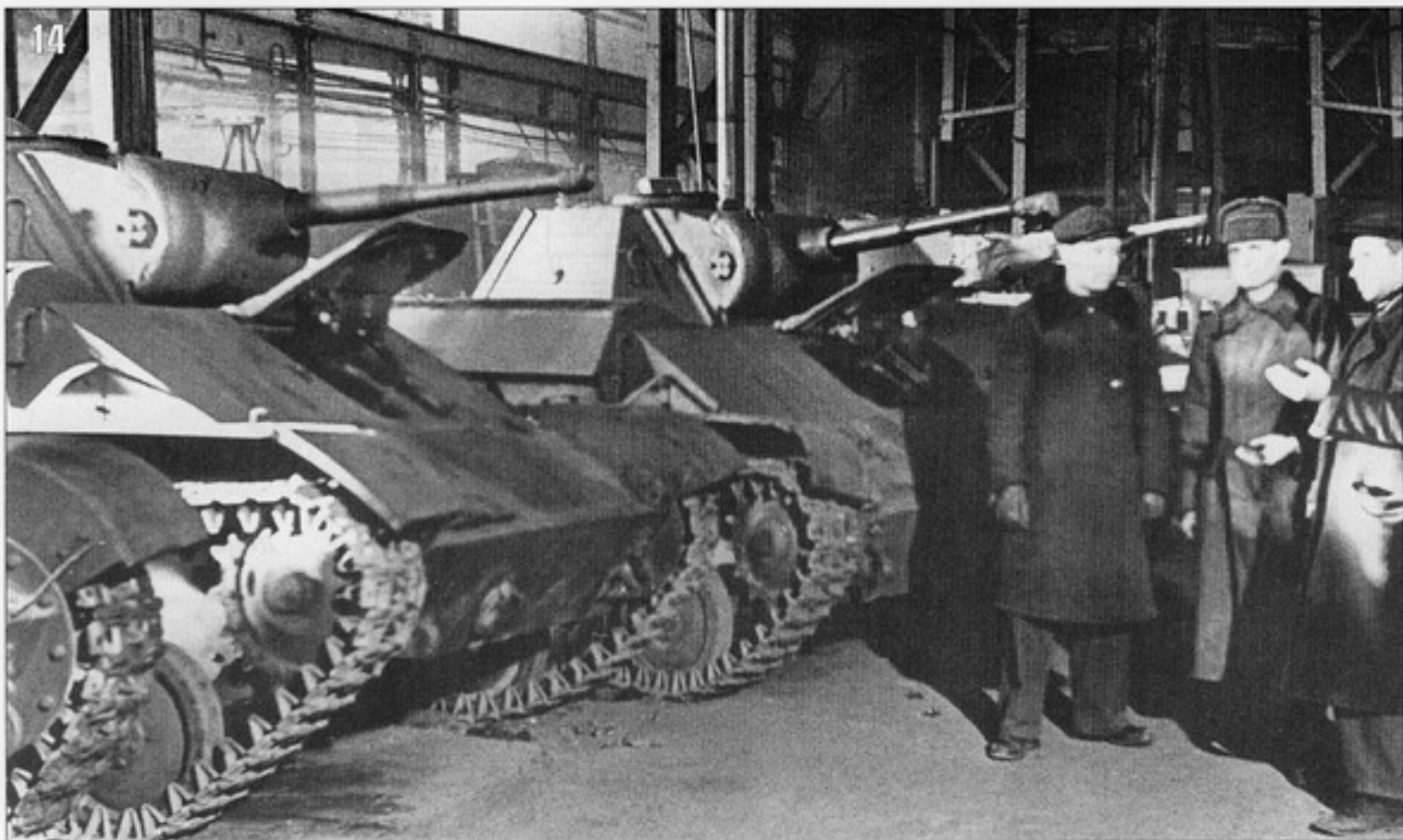
14, 15. Передача представителям Красной Армии танков Т-70, отремонтированных на одном из заводов. Осень 1942 года. На лобовом листе машины на фото 15 видна надпись «Защитникам Сталинграда», на борту между катками подвески видна броневая заплатка (РГАКФД).
