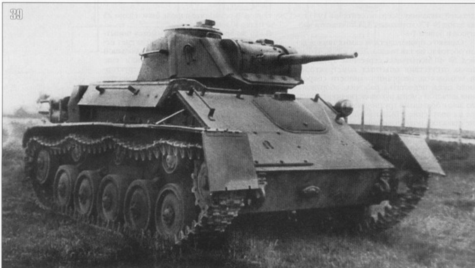
39. Легкий танк Т-80 производства завода № 40. Хорошо видны отличия от образца ГАЗа – поручни на башне и корпусе, маска пушки и т.п. (фото предоставил М. Барятинский).
