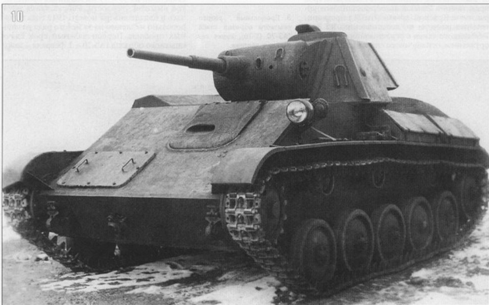
10. Серийный образец танка Т-70, изготовленный на Горьковском автомобильном заводе. 1942 год. Машина имеет литые маску пушки и люк механика-водителя производства завода № 176 (фото предоставил М. Барятинский).
