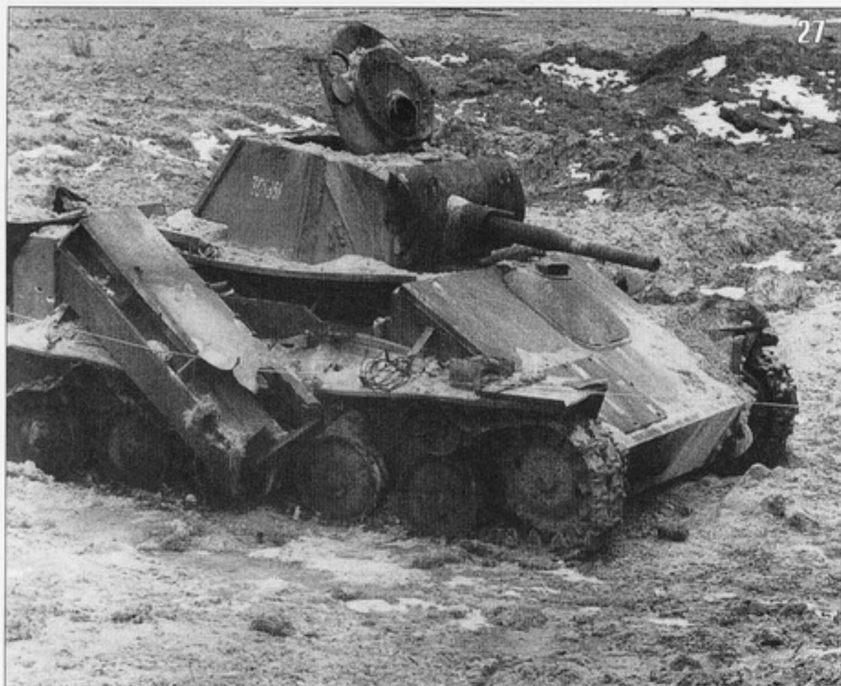
27. Легкий танк Т-70М, подбитый весной 1943 года. Машина имеет сварную маску пушки и литой люк механика-водителя производства завода № 177 (АСКМ).
