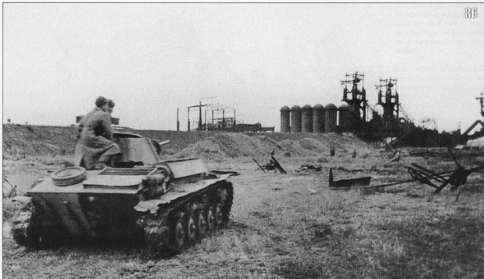
86. Легкий танк Т-70М с десантом на броне ведет бой на Таманском полуострове. Осень 1943 года. На жалюзи для доступа воздуха к радиатору видна одна съемная крышка (АСКМ).
