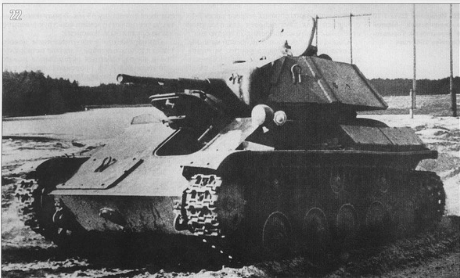
21, 22. Испытания танка Т-70 с двухместной башней в окрестностях Горького. Сентябрь 1942 года. На фото хорошо видна конструкция башенного люка (фото ГАЗ).
