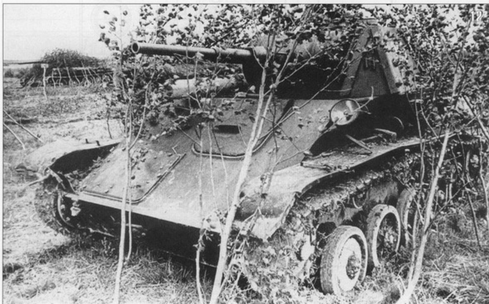
11, 12. Танки старшего лейтенанта Ф. Рубикина перед боем. Калининский фронт, лето 1943 года. На фото изображены Т-70 производства завода № 38 выпуска весны – начала лета 1942 года. Машины имеют литые опорные катки (РГАКФД).
