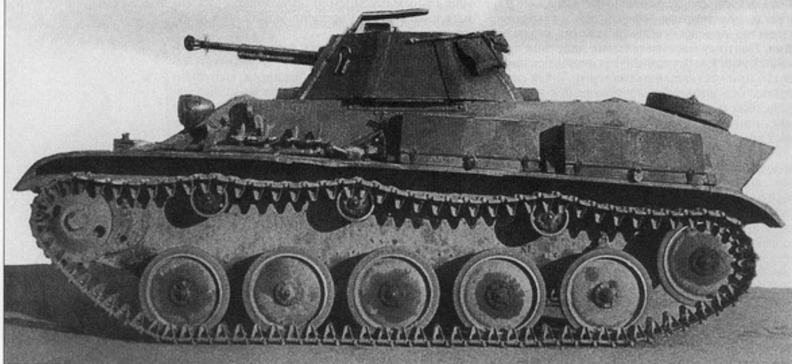
45, 46. Зенитный танк Т-90 Горьковского автозавода, вид сбоку. Декабрь 1942 года. На фото 46 пулеметы находятся на максимальном угле возвышения (АСКМ).
