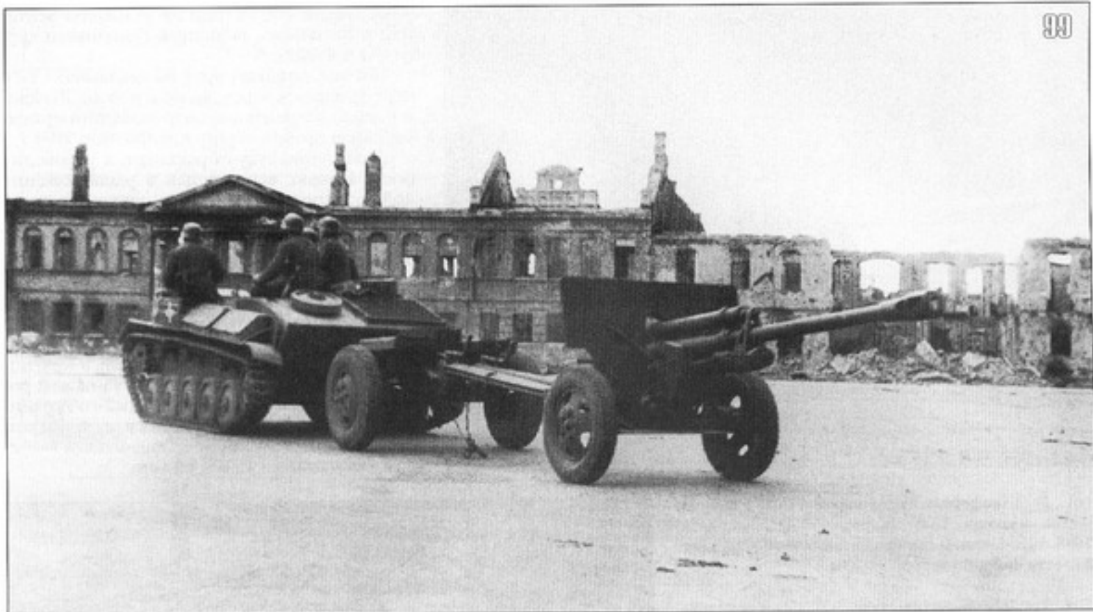
99. Трофейный танк Т-70, используемый в вермахте в качестве тягача для захваченной советской 76,2-мм пушки ЗИС-3. Ростов-на-Дону, лето 1942 года. Использование в частях вермахта трофейных Т-70 без башни в качестве тягачей для 50 – 75-мм орудий летом – осенью 1942 года было довольно частым явлением (АСКМ).
