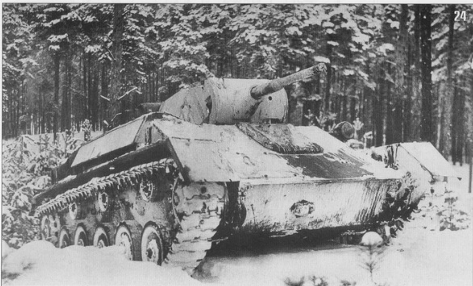
24. Испытания серийного танка Т-70М в окрестностях Горького. Декабрь 1942 года. Машина имеет сварную маску пушки и литой люк механика-водителя (фото ГАЗ).
