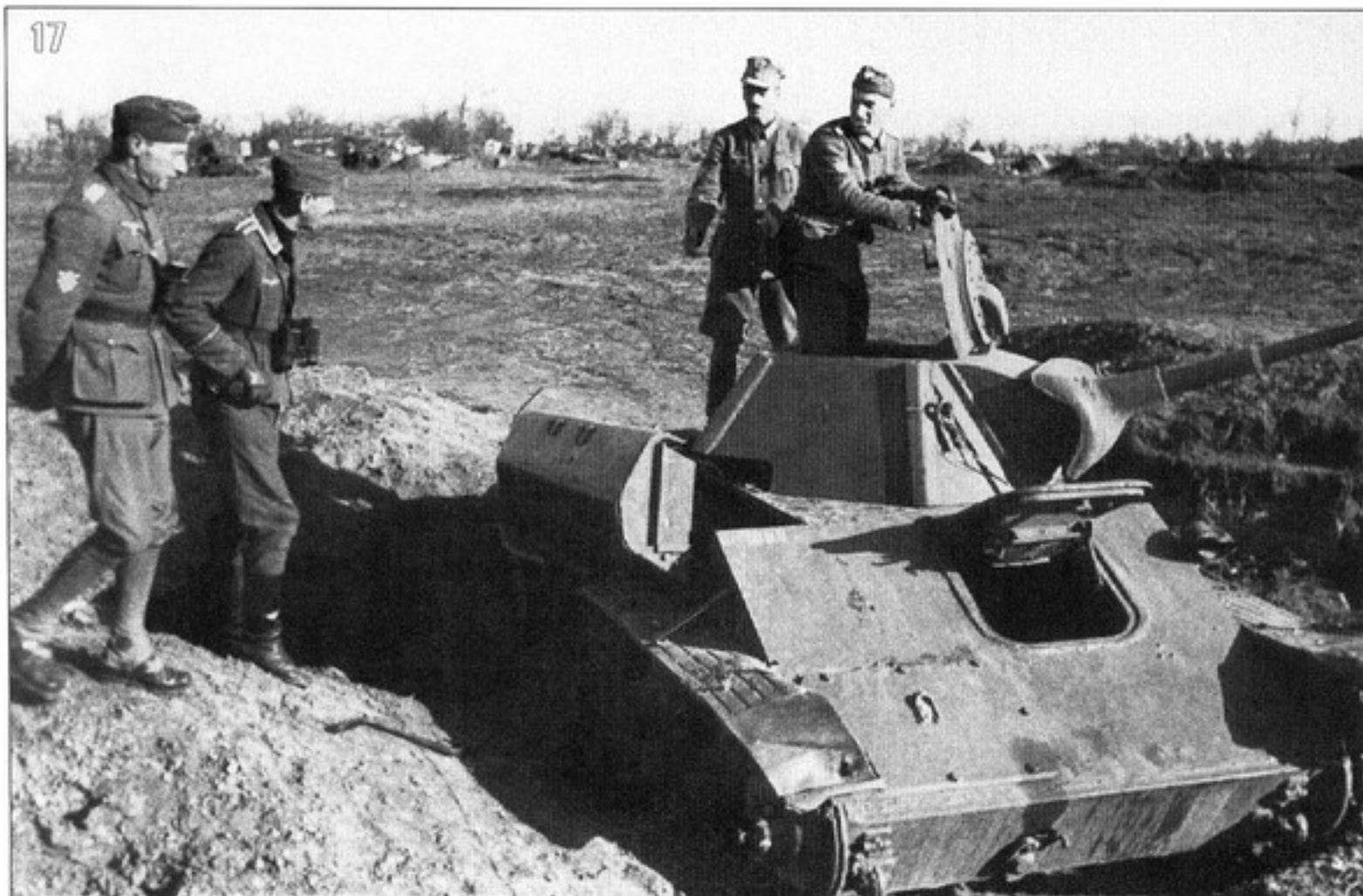
17, 18. Офицеры вермахта осматривают подбитый советский танк Т-70. Лето 1942 года. Люк с жалюзи для доступа к двигателям откинут (АСКМ).
