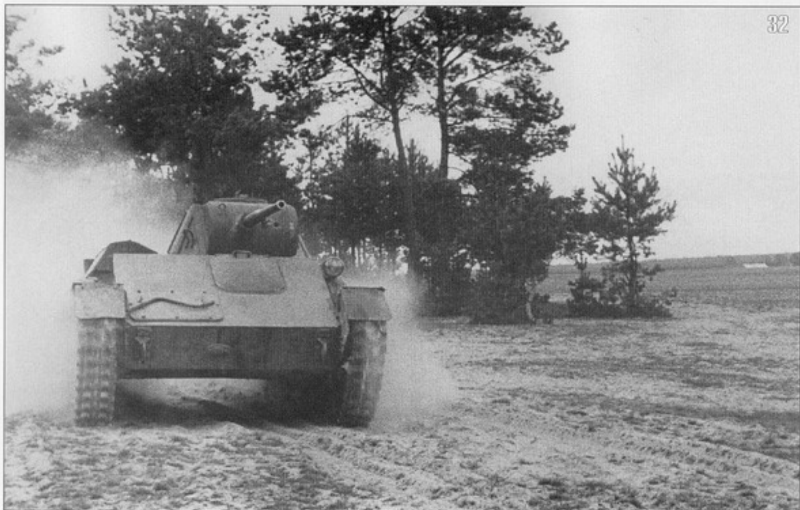
31, 32. Фото того же Т-70М, что и на фото 29, 30. 1-й Белорусский фронт, лето 1944 года. Хорошо видны выхлопные трубы и антенный ввод на кормовом листе башни (АСКМ).
