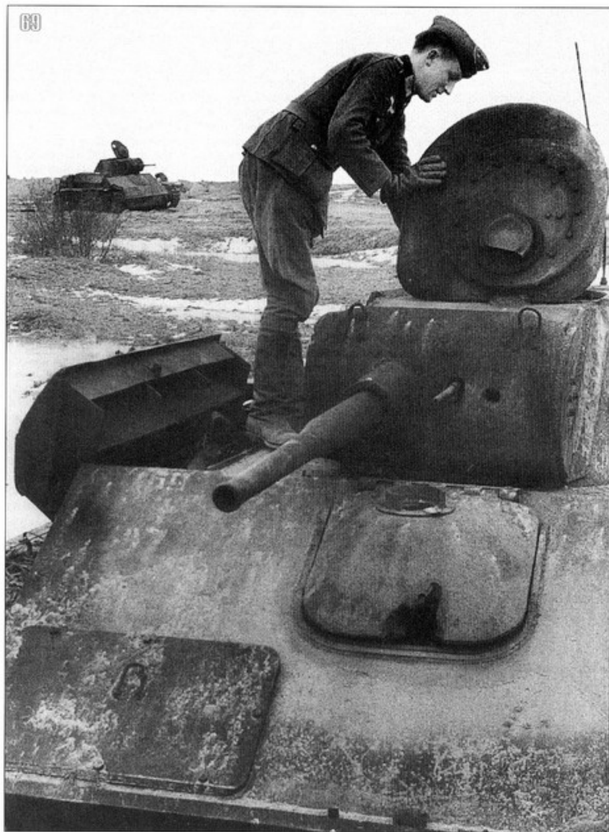
69, 70. Немецкий солдат осматривает подбитый советский танк Т-70М. Осень 1943 года. Машина имеет антенну, установленную на кормовом листе башни. Обратите внимание на пробоину в нижней части механика-водителя (АСКМ).
