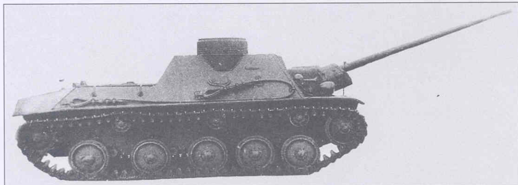
Истребитель танков НАТИ, вооруженный 57-мм противотанковой пушкой С-1-57
