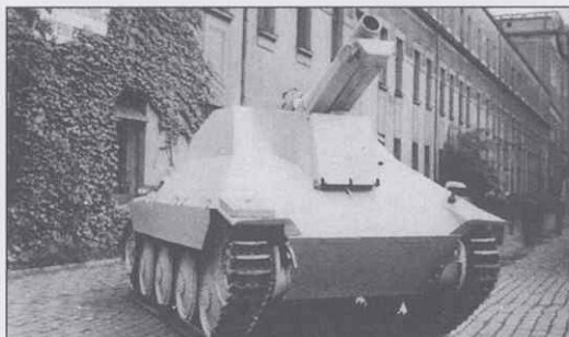
Опытный образец 15-см sIG 33/2 (Sfl) auf Jagdpanzer 38 (Hetzer-Bison) во дворе «ВММ». Вид в положении для стрельбы прямой наводкой и в положении угла наибольшего возвышения
