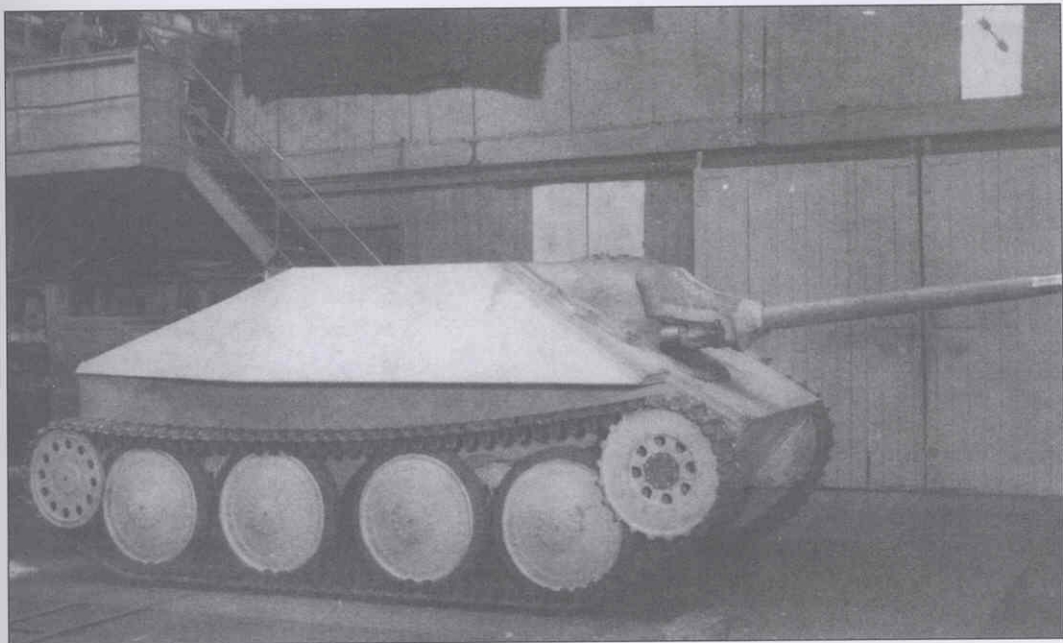
Прототип САУ Sturmgeschütz nA, одобренный к постройке
