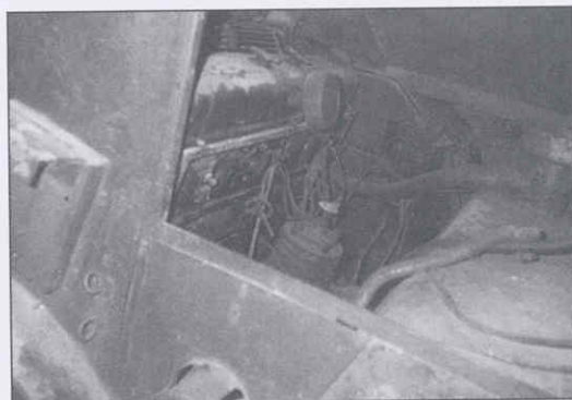
Вид на двигательную установку «Хетцера» — заслонка снята
