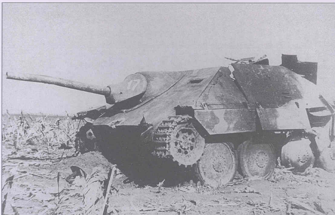
Подбитый и разрушенный внутренним взрывом «Хетцер».
