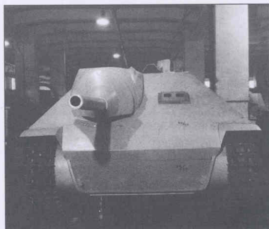
Макет штурмового орудия нового типа со смотровым прибором и пулеметной оборонительной турелью
