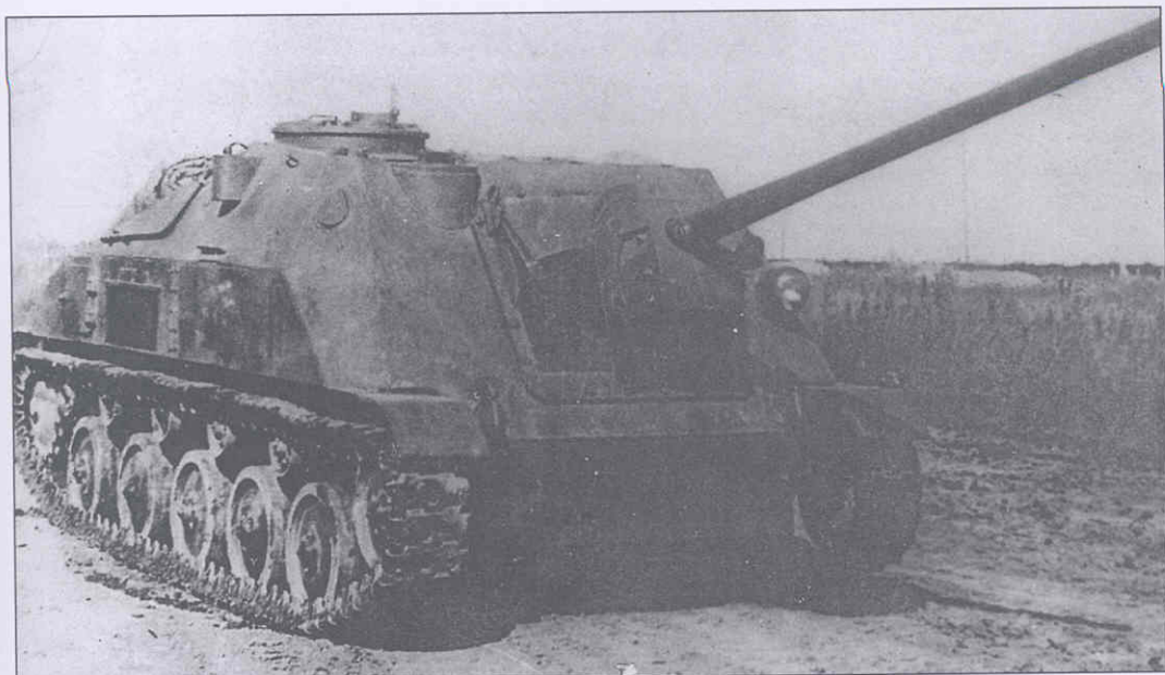
Истребитель танков ГАЗ-74 (СУ-576), вооруженный 57-мм противотанковой пушкой С-1-57
