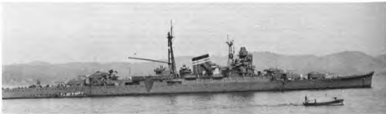
Крейсер "Mikuma", сентябрь 1935 г. Хорошо видно отсутствие двух 127-мм спаренных орудий.
