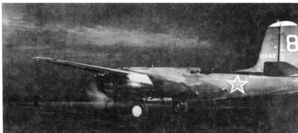
А-20В готовят к боевому вылету. Хорошо видны бомбы на наружных бомбодержателях
