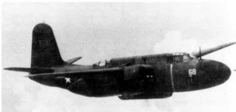
Второй экземпляр Р-70 после установки под фюзеляжем контейнера с четырьмя 20-мм пушками
