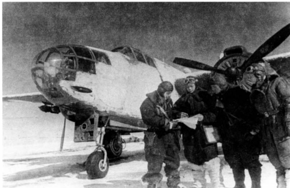
Экипаж капитана И.С. Петросяна (второй слева) у разведчика А-20В в зимнем камуфля- же, Воронежский фронт, март 1943 г. Обратите внимание на съемный зимний лобовой щит капота
