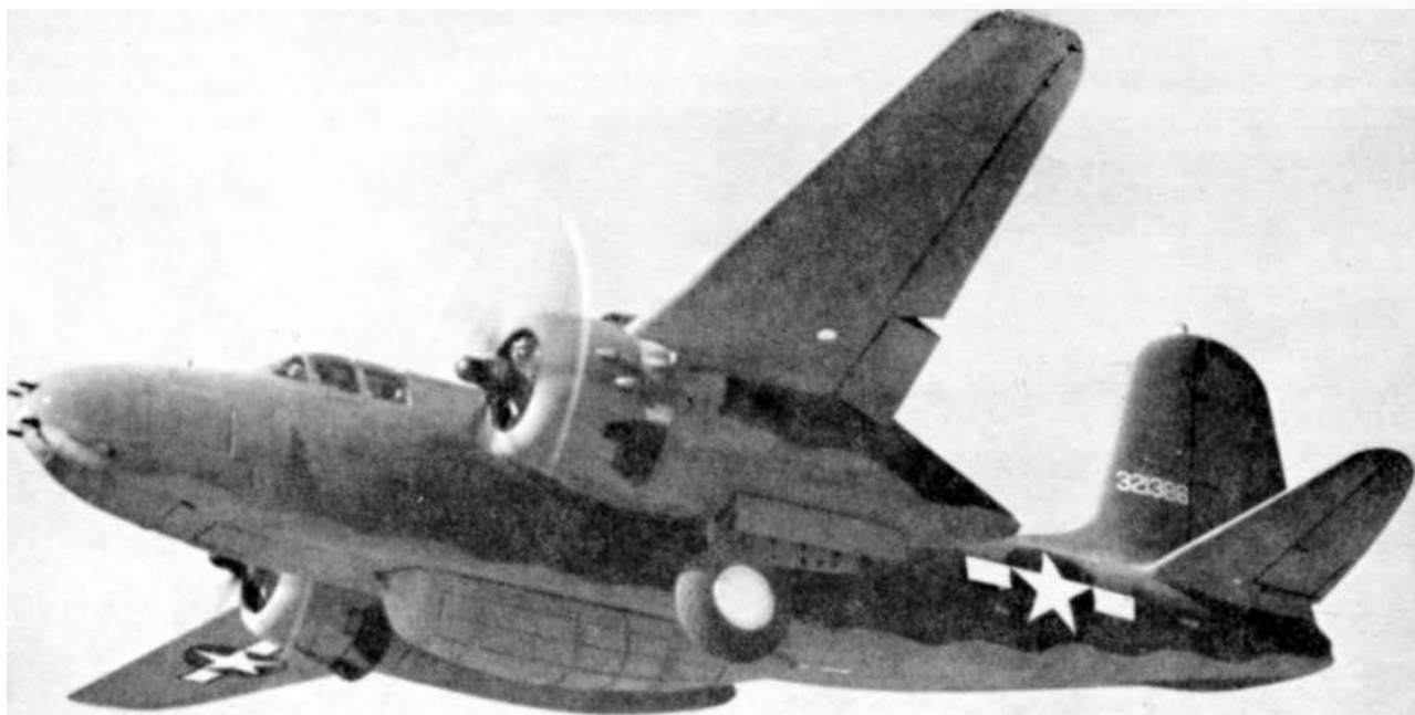
A-20G-40 с перегоночным подвесным баком под фюзеляжем
