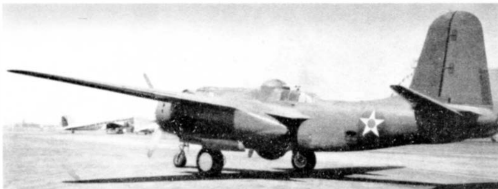
ХА-20В с тремя дистанционно управляемыми турелями, июль 1941 г.
