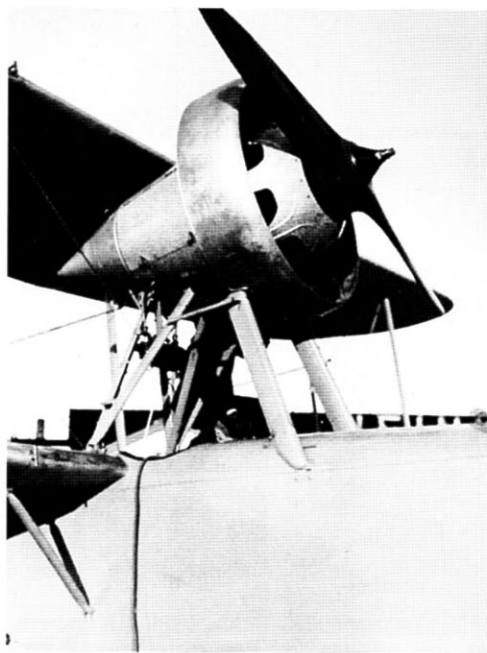
Силовая установка HD.55, оснащенная кольцом Тауненда
