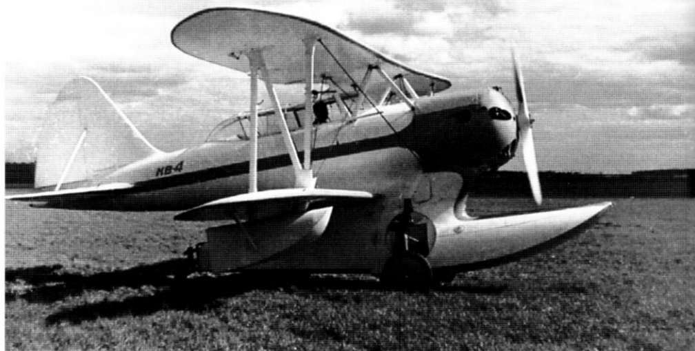
Амфибия НВ-4 с двигателем М-11 конструкции В.В. Никитина явилась «прообразом» проекта КОР-2 этого же конструктора
