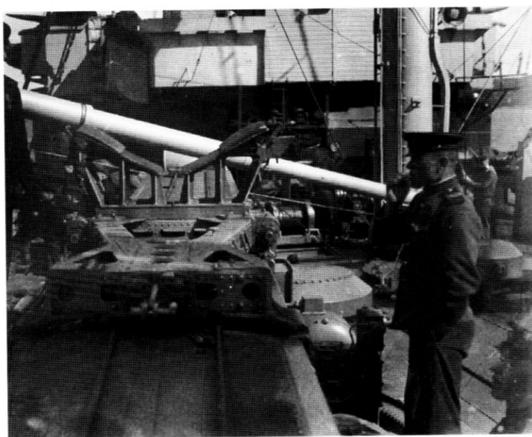
В центре: элементы корабельной катапульты крейсера «Мурманск» с поворотной площадкой, резервуарами сжатого воздуха, разгонным и тормозными механизмами
