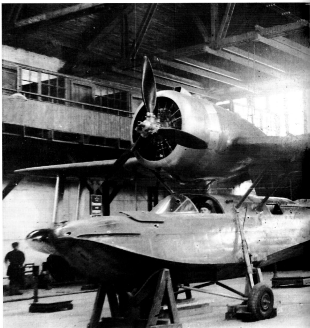
КОР-2 на сухопутном шасси, оборудо- ванном колесами 650х200 мм. Носовая часть лодки снабжена дополнительными пластинками- брызгоотража- телями
