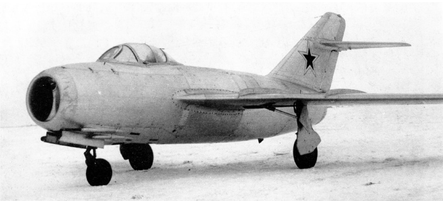
Первый прототип МиГ-15 — самолет «С-1» с двигателем «Нин-1». Декабрь 1947 г.
