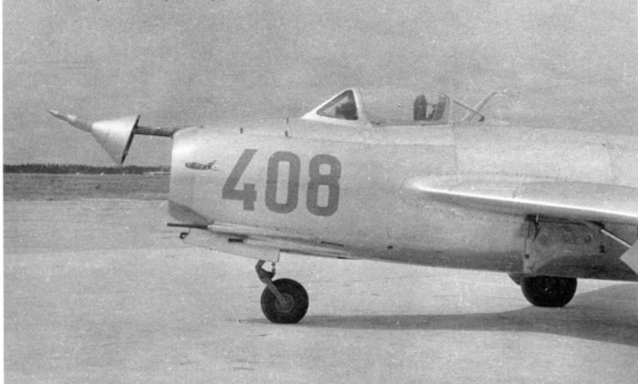
МиГ-15бис с приемником-конусом на гарпуне
