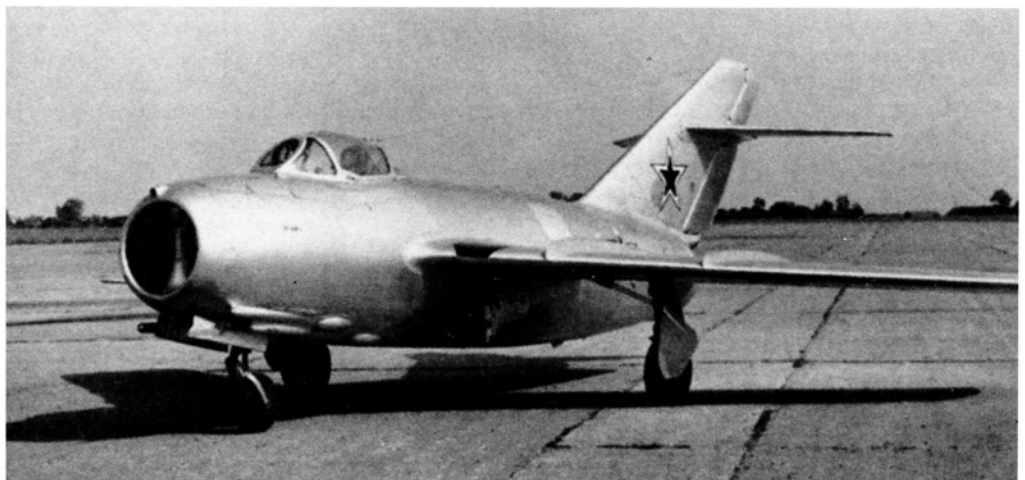
Самолет «СВ», ставший фактически летающей лабораторией для отработки технических решений будущего МиГ-15бис
