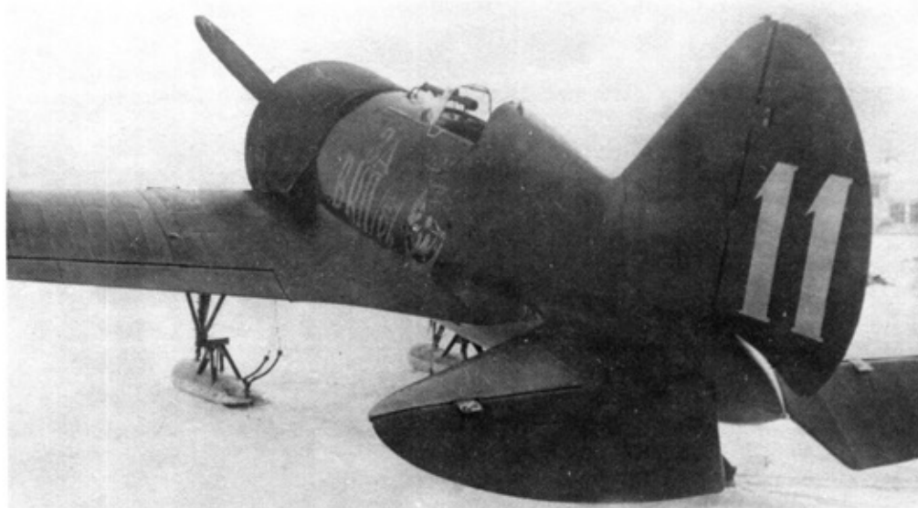
Левый борт машины с 11-м номером отличался надписью «За ВКП(б)» и рисунком ордена Красного знамени. И-16 оборудован радиостанцией, установлен на неубираемые в полете лыжи
