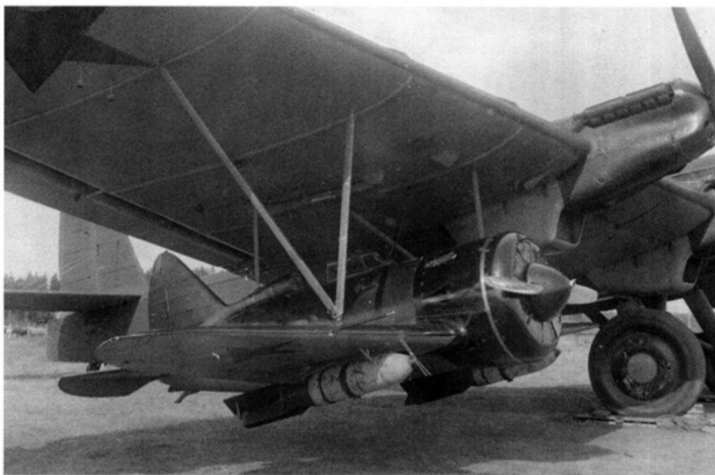
Полностью подготовленный к старту правый И-16 системы «Звено-СПБ» образца 1938 г.
