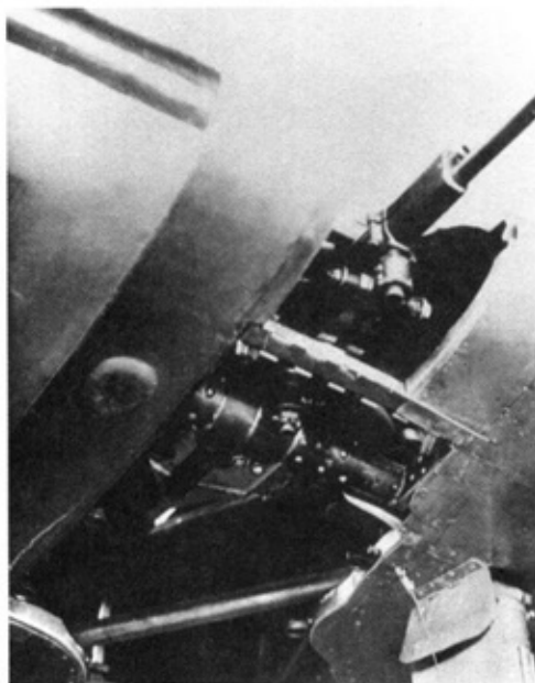
Установка пулемета ШКАС в центроплане И-16 тип 4
