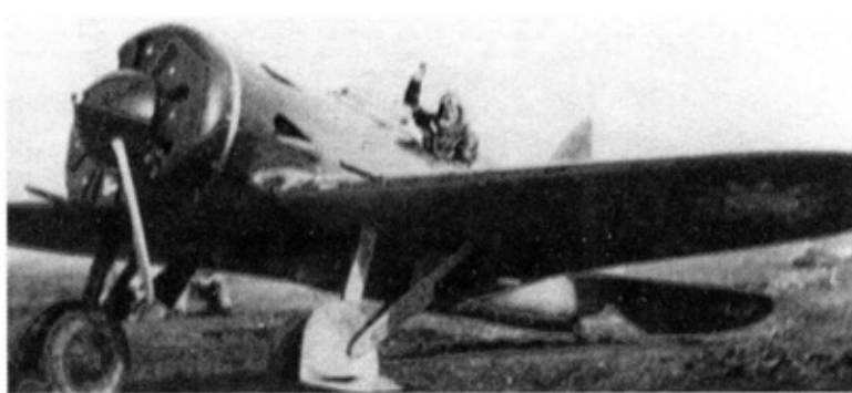
Китайский И-16 тип 5. Пулеметы ШКАС в крыле заменены пулеметами Викарс
