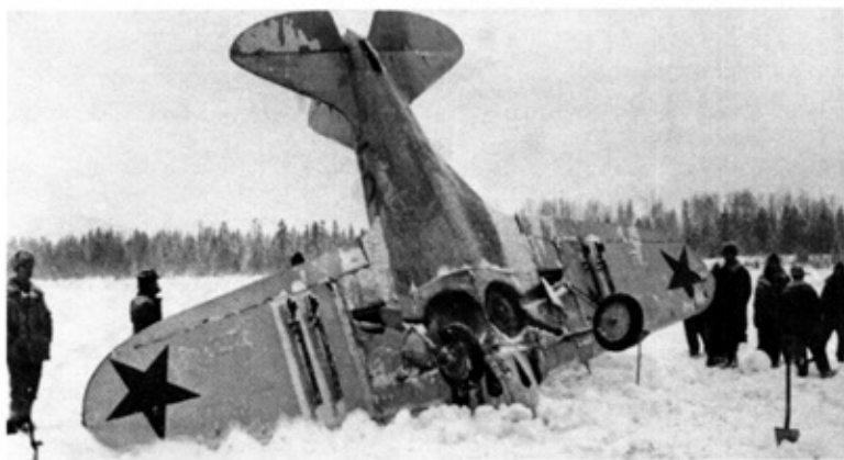
Этот И-16 тип 5 с бортовым номером «64» достался финнам 10 декабря 1941 г. на Ладожском озере. Самолет вооружен 4 РО-82, которые установили на нем в полевых авиамастерских
