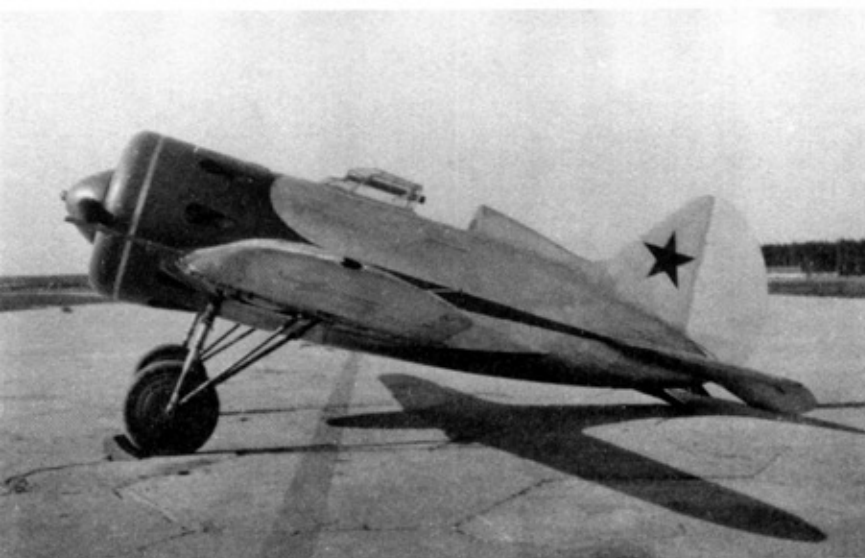
ЦКБ-12П в процессе испытаний пушечного вооружения летом 1936 г. Механизм уборки шасси оказался неисправным, поэтому на втором этапе испытаний шасси не убрали
