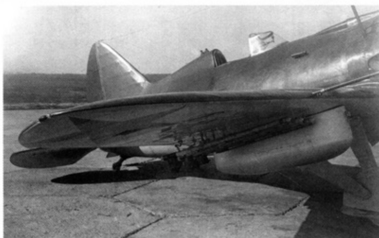
Крупный план на РО-82 под правым крылом И-16 тип 29. В связи с установкой стандартного ракетного вооружения опознавательные знаки — звезды — перенесены на концевую часть крыла
