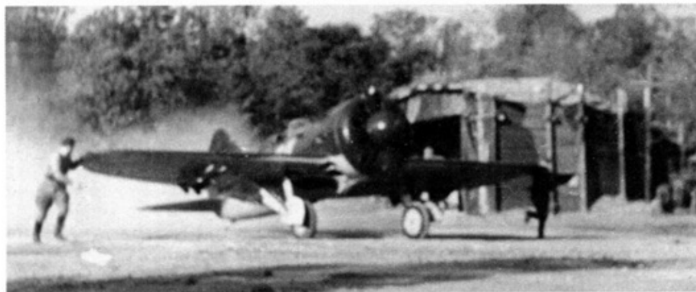
На старт вырывается И-16 тип 29, вооруженный четырьмя РС-82
