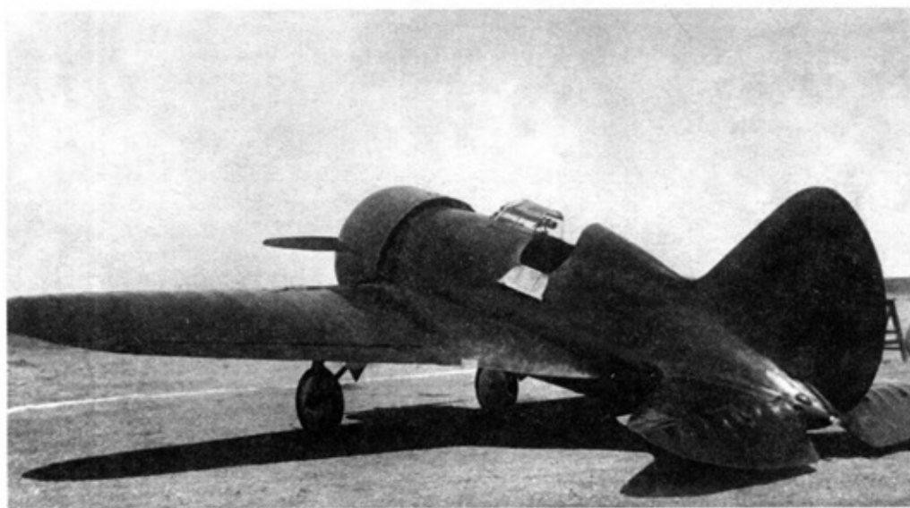
Первый опытный экземпляр ЦКБ-12 с двигателем М-22 во время проведения эксплуатационных испытаний в Крыму в марте 1934 г.
