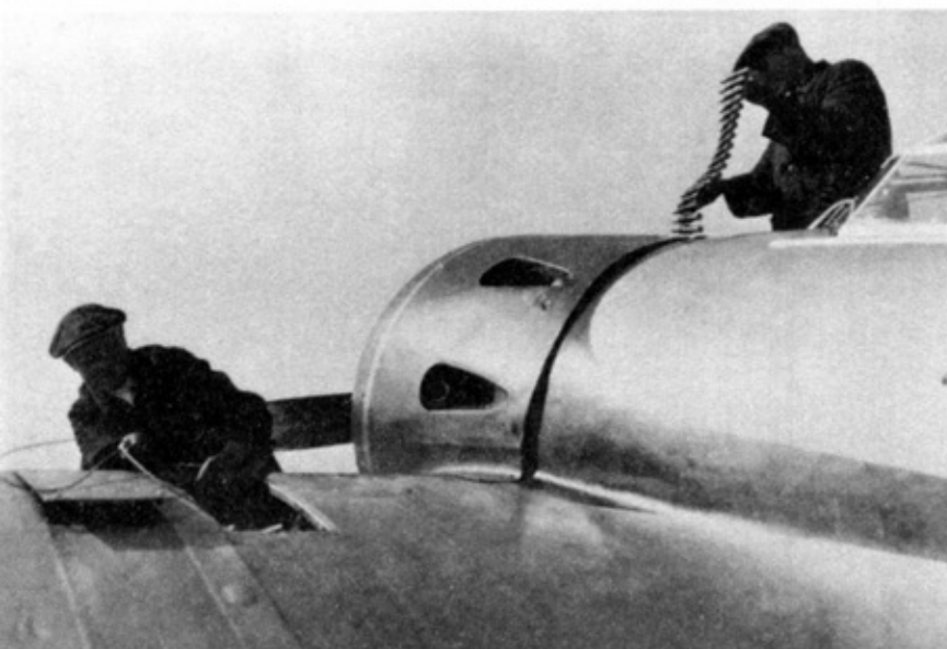
Укладка ленты со снарядами в ящик боезапаса, размещенный в ЦКБ-12П в фюзеляже перед бензобаком
