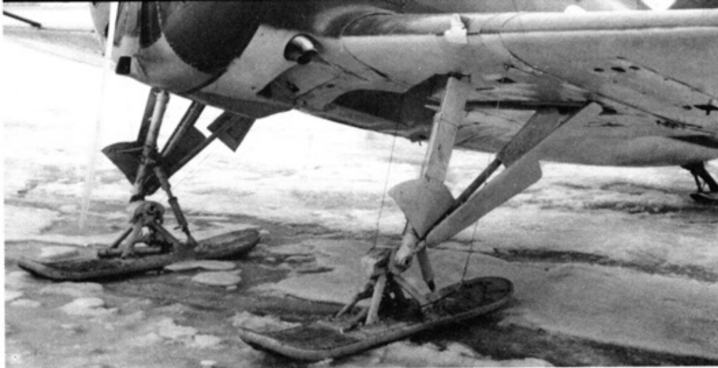
Лыжное шасси И-16, который достался финнам в апреле 1940 г. в исправном состоянии. В период вторичной эксплуатации поначалу получил обозначение VH-201, затем — VH-21
