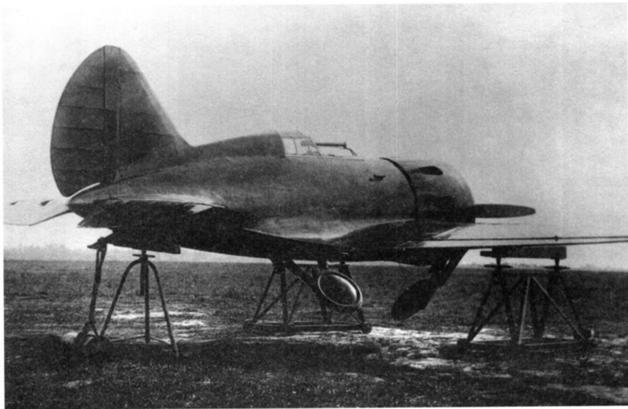
ЦКБ-12 бис с двигателем Райт «Циклон» F-3 установлен на козелки для проверки механизма уборки шасси
