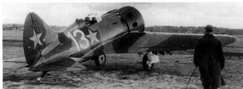
И-16 тип 29 с бортовым «несчастливым» номером 13 вырывается на взлет. Самолет с убедительно правильным камуфляжем, то есть нанесенным в соответствии с инструкцией 1941 г., вооружен шестью РС-82
