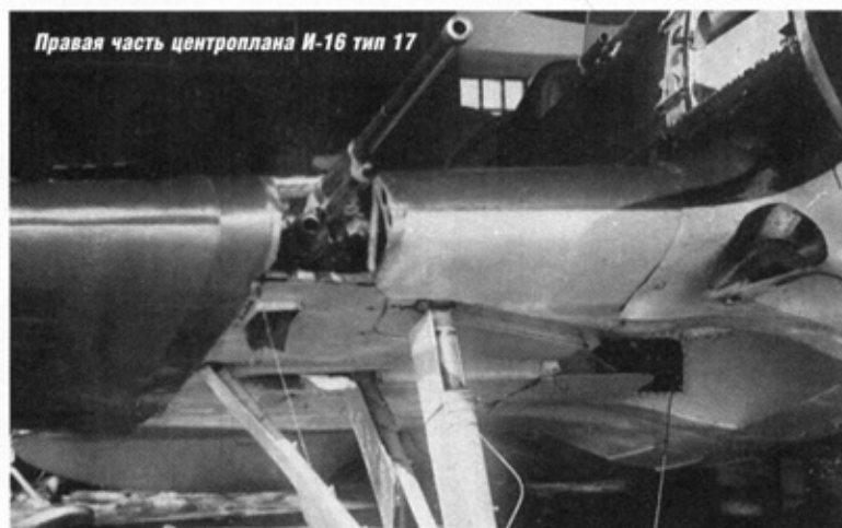
Подфюзеляжное пространство И-16 тип 17. Стрелкой указана ниша для установки носка лыжи в убранном положении
