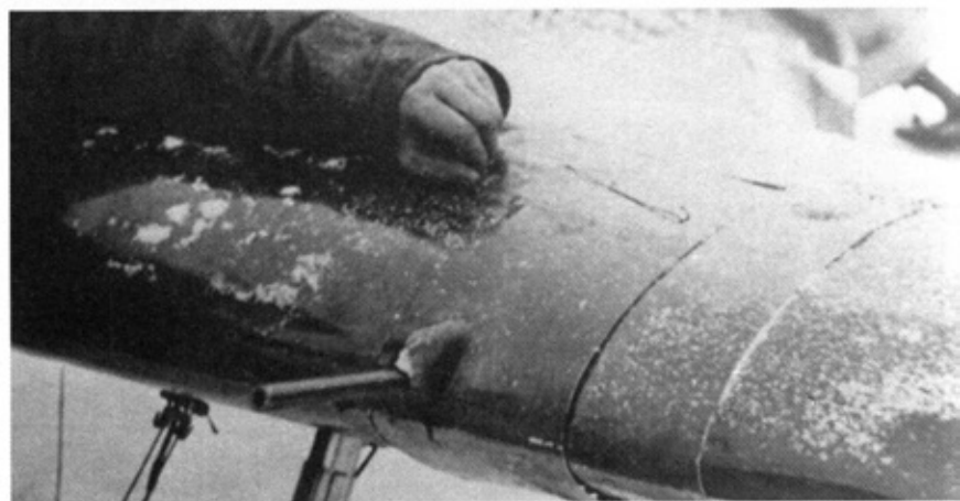
Установка пулемета ШКАС в центроплане И-16 тип 4
