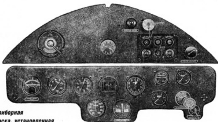
Внизу: приборная доска задней пилотской кабины. Окраска самой доски выполнена черной матовой краской методом «под муар»
