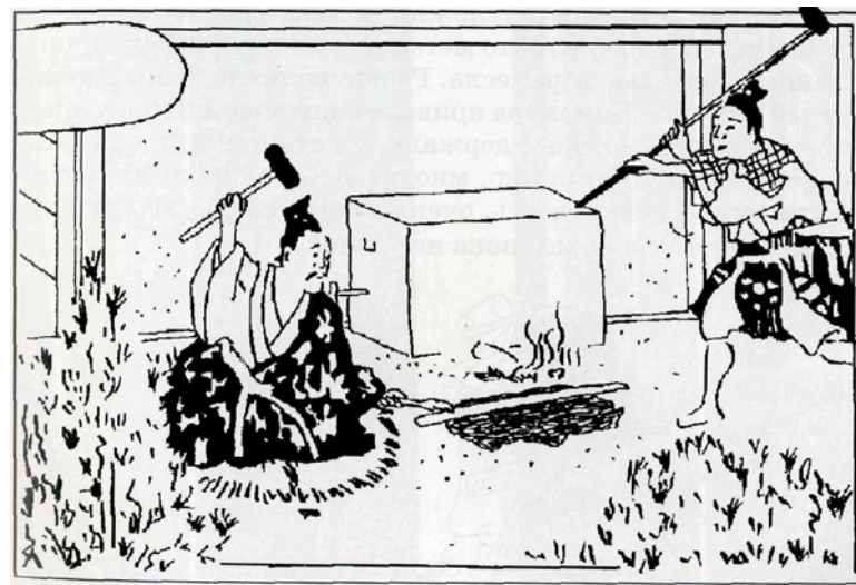
Кузнец за работой. Мастер сидит на соломенном коврике, удерживает заготовку клещами и легким молотком бьет по ней, задавая темп и указывая место удара молотобойцу, который работает стоя. Между ними в глубине сцены прямоугольные меха, левой стенке которых виден шток поршня, которым кузнец нагнетает воздух, всасываемый в отверстие над штоком, через сопло в горн
