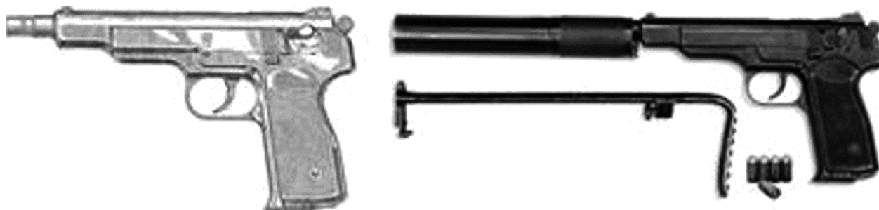
Рис. 11 Модификации пистолета АПБ 0 (со съемным глушителем и
