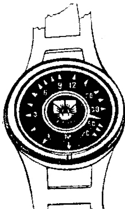
Рис. 14а Глубиномер в форме наручных часов
