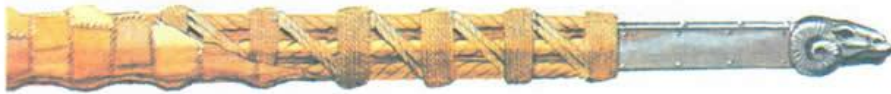
Таран, описанный Витрувием. Прямоугольная балка огледалась веревками и обшивалась сыромятной кожей. Конец был обит железом и снабжен наконечником в виде бараньей головы.
