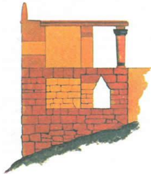
Поперечный разрез стен Тиринфа, на котором видны галереи и зубчатые стены из кирпича-сырца. Это самое сложное из укреплений микенской эпохи.
