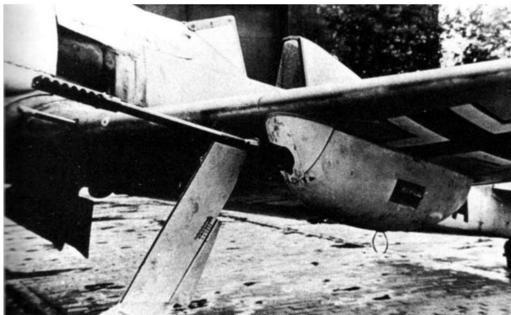
Подвесная гондола с пушкой МК 103 под крылом истребителя FW 190А-5/U13
