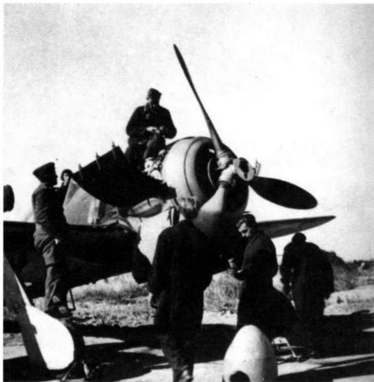
Техническое обслуживание истребителей на полево аэродроме. Широко распахнутые капоты обеспечивали хороший доступ к агрегатам мотоустановки
