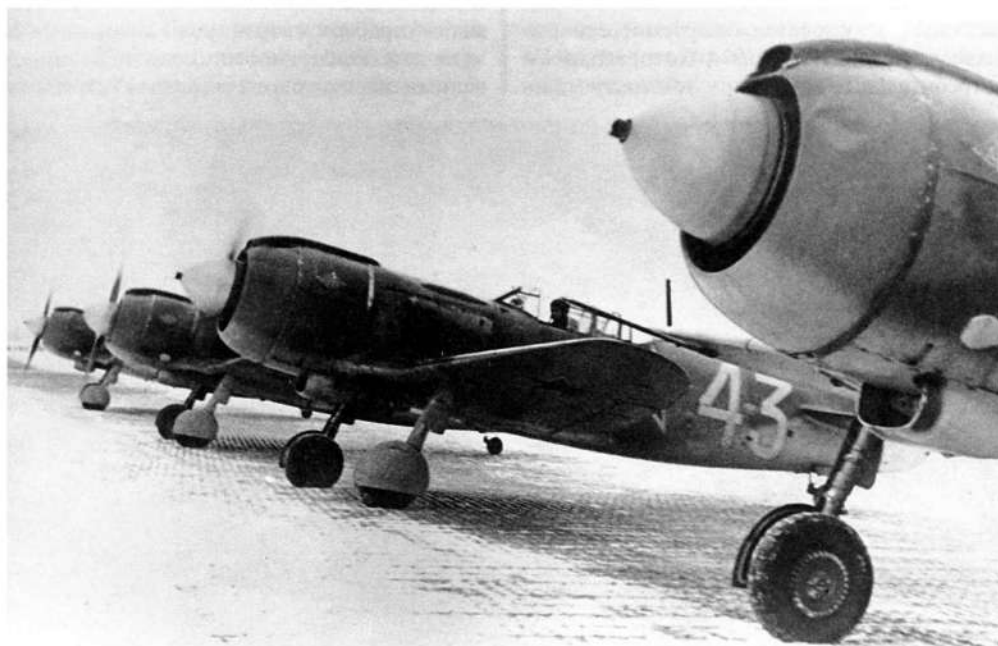
Советский истребитель Ла-5ФН с мотором воздушного охлаждения М-82ФН с лета 1943 г. стал одним из основных оппонентов «сто девяностого»
