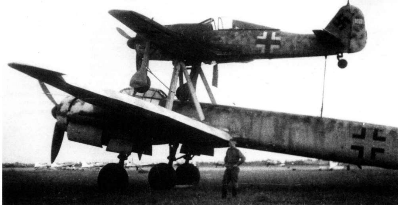
Система «Мистель» с самолетом наведения FW 190А-8 и ударным самолетом Ju 88В. На «Юнкерсе» смонтирована дополнительная (средняя) опора шасси, сбрасывавшаяся после взлета
