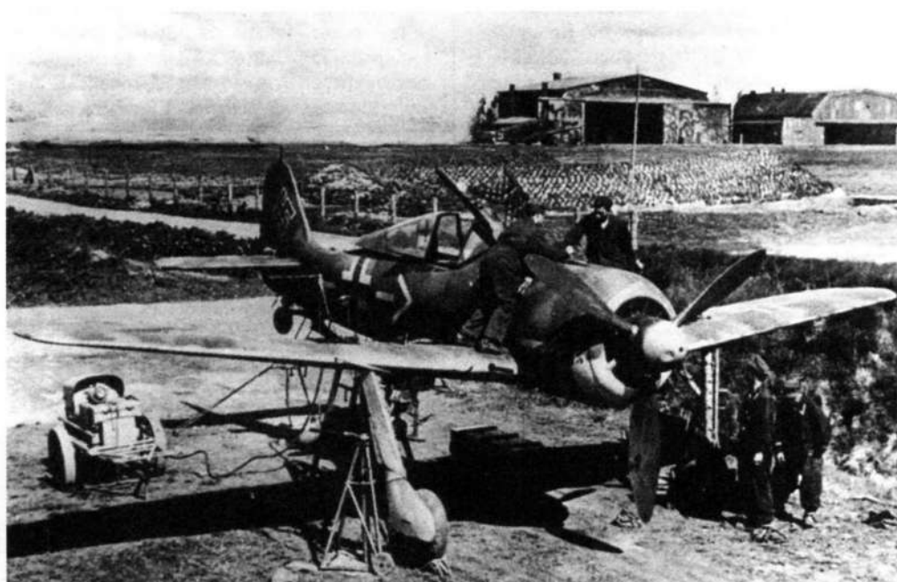
Производится пристрелка оружия на самолете командира JG54 майора А. Мадера
