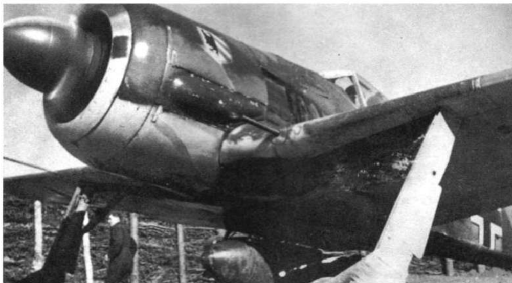
Машина с бомбой SC 250 и без внешних крыльевых пушек — штурмовик, принадлежавший истребительно-бомбардировочному отряду JG54
