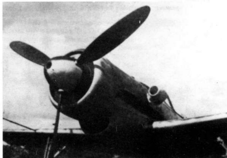
Носовая часть фюзеляжа высотного истребителя FW 190C с мотором DB 603A
