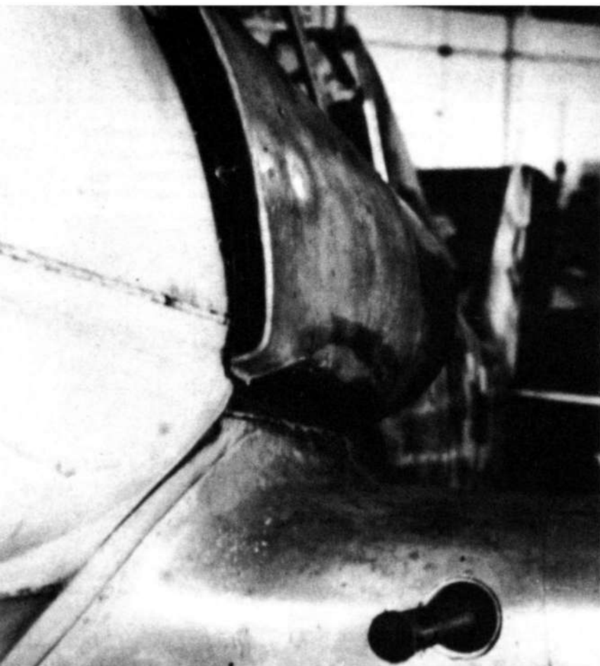
Пламегаситель, смонтированный на истребителе- бомбардировщике FW 190G-3N
