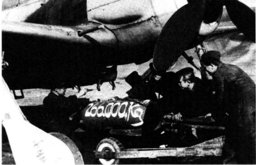
Подвеска бомбы на истребитель-бомбардировщик FW 190G-2
