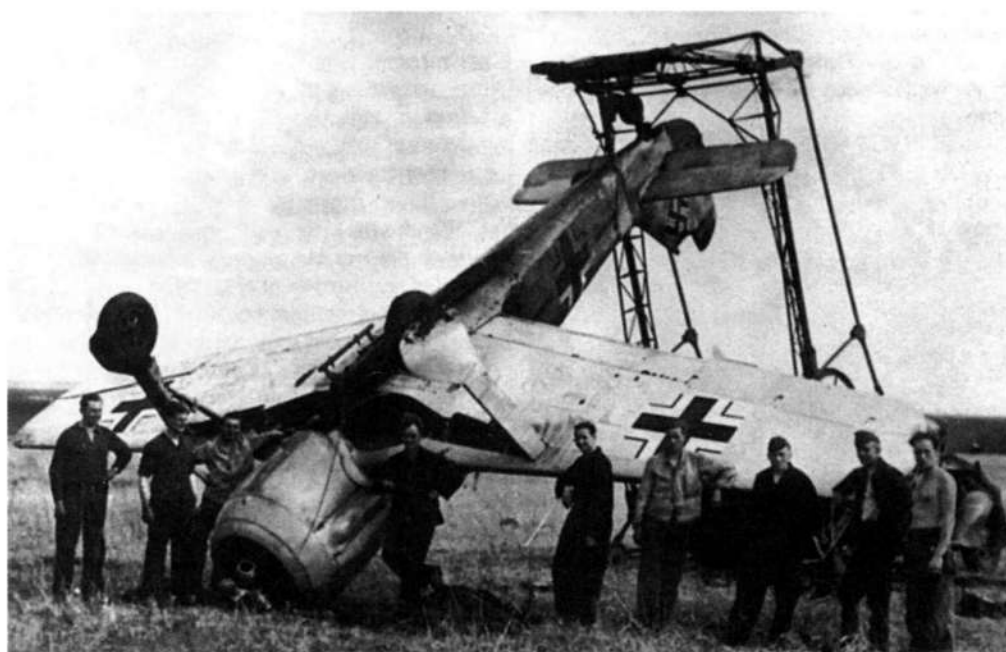
Скапотированный при пробеге «Фокке-Вульф»
