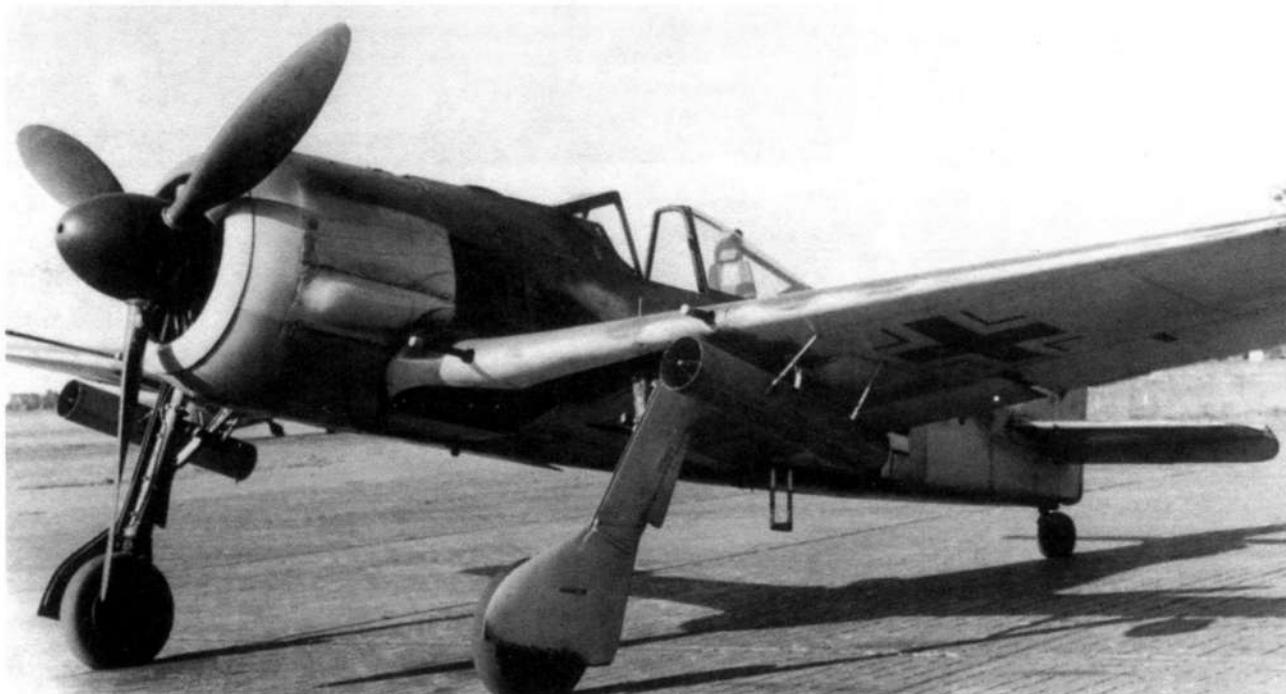
«Разрушитель строя» — истребитель с двумя подкрыльевыми установками для запуска неуправляемых реактивных снарядов Wfr.Gr. 21
