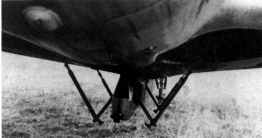
Подфюзеляжный держатель ETC501 позволял подвешивать 250- или 500-килограммовую бомбу
