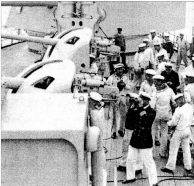
Зенитные орудия типа 8,8-см SKL/45 (G.E.). Хотя данная фотография сделана на германском корабле уже после войны, конструкция орудий и лафетов этой модели практически не изменялась до принятия более совершенных систем.
