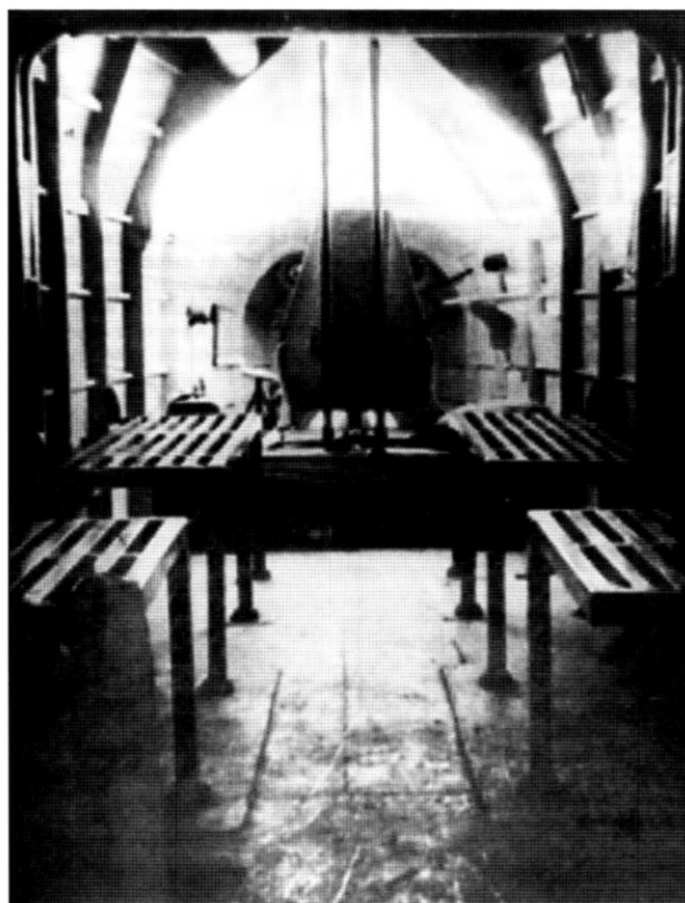
Грузовая кабина планера Г-11. Впереди — кресло пилота. По бортам — скамейки для десантников. При перевозке грузов их можно было сложить вниз или просто снять. Скамейки имеют разрыв в районе грузовой двери
