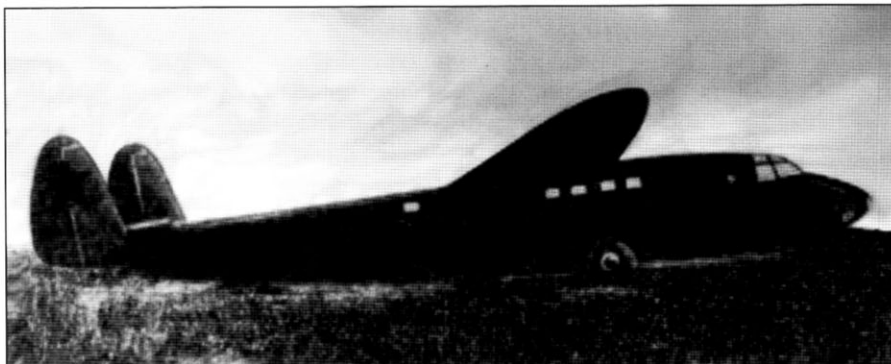
Серийный планер КЦ-20. Видно, что грузовая кабина имеет по 4 иллюминатора на борт. Пятый иллюминатор, у задней кромки крыла, сделан в месте, где предполагалось установить пулеметную установку
