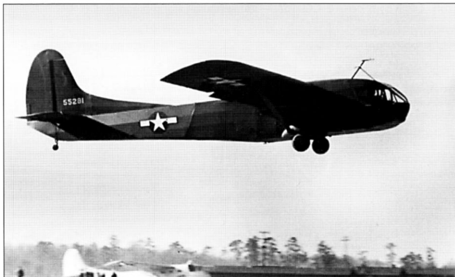
Планер CG-15A является модернизацией планера CG-4A. Была оптимизирована силовая схема и улучшена аэродинамика. Размерность осталась прежней
