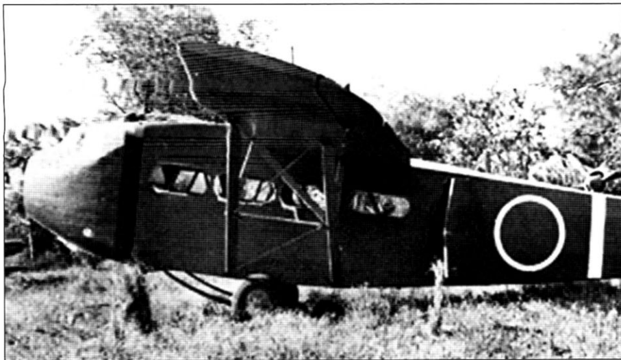
Японский средний планер Ki-8-II был создан на основе транспортного самолета Ki-59. Он мог перевозить 2 пилотов и 18 десантников
