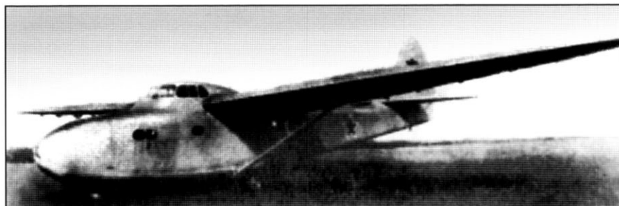
Планер Ц-25. Видна входная дверь на левом борту. Планеры несли только красные звезды, каких-то индивидуальных обозначений не было
