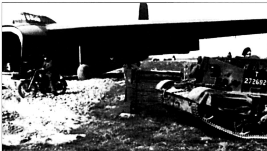
Планер «Хамилькар» выгрузился в районе Рейна. Он мог взять 1 БТР «Универсал Карьер» (на переднем плане) и 8 мотоциклов (на втором плане)
