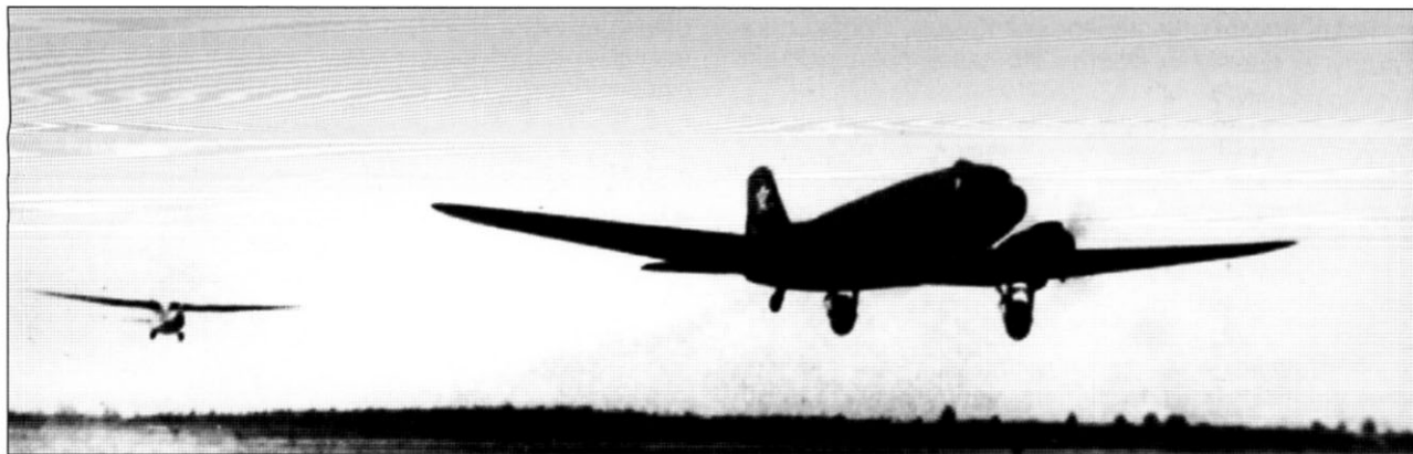
Планер Г-11 взлетает за буксировщиком Ли-2. Во время взлета планер не должен уходить далеко вверх и опускаться слишком вниз, чтобы не нарушить балансировку самолета-буксировщика на малых скоростях
