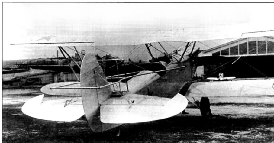
Самолет — разведчик Р-5, приспособленный для буксировки планера Г-31 «Яков Алкснис». В дальнейшем самолеты Р-5 часто использовались для буксировки других типов планеров
