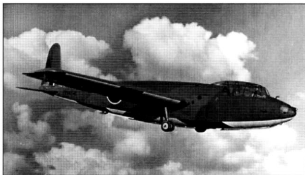
«Хотспур» Mk II в классической комплектации. Планер имеет две лыжи и хвостовой костыль — «лыжонок». Кроме серийного номера, планер не имеет каких-либо индивидуальных обозначений. На пилотах одеты стальные каски
