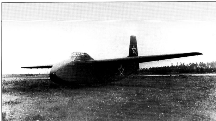
Як-14 готовится к взлету. Спереди можно заметить буксировочный трос. Также видны кронштейны для подвески закрылков и элеронов
