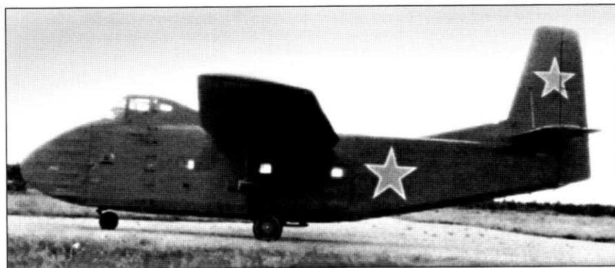
Серийный Як-14. За основным колесом видна посадочная лыжа
