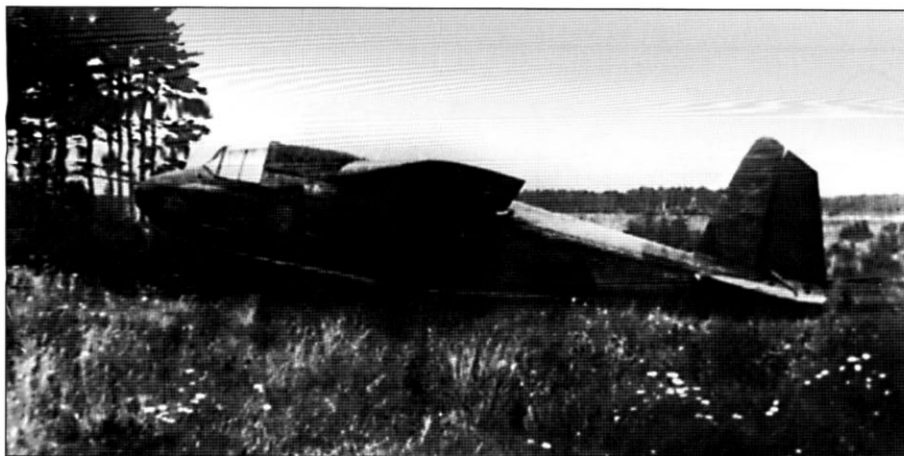
Серийный образец планера Г-11. Крыло отодвинуто назад, для создания более передней центровки
