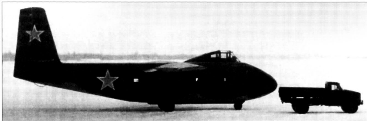
Прототип планера Як-14. Обратите внимание на отсутствие форкиля. Стоящий спереди грузовик хорошо показывает размеры планера
