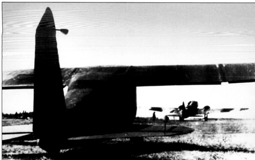
Г-11 перед вылетом. Щитки выпущены во взлетное положение. Видно, что противоблужетный груз руля направления расположен справа. В качестве буксировщика — самолет Ли-2. Самолет-буксировщик имеет камуфляжную окраску
