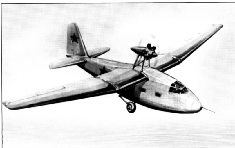
Схема мотопланера Г-11М (Г-30) с мотором М-11
