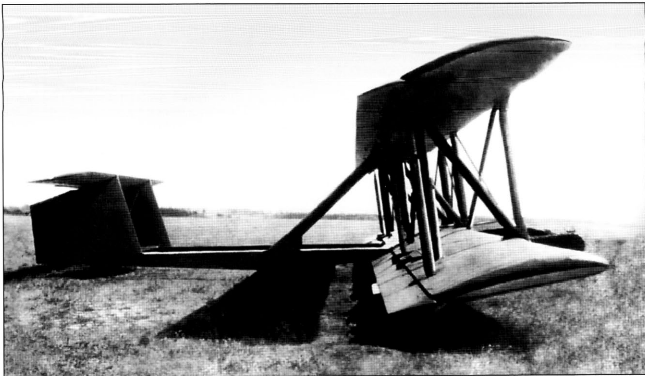
Во время испытаний планера КТ башню с танка Т-60 сняли для уменьшения полетного веса. На снимке видны часть корпуса и левая гусеница танка, конструкция каркаса планера и его хвостовое оперение. На нижнем крыле видны кронштейны крепления аэродинамических компенсаций, которые прижимаются к верхней поверхности крыла при убранном положении закрылков
