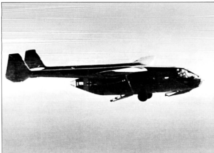
Планер Go-242A-1 с обозначением VC+OI в полете над Средиземным морем. Шасси в полной комплектации для версии A-1: носовая лыжа – с тормозным плугом, а на основных лыжах установлены колесики для маневров на земле. Взлетная тележка не сброшена
