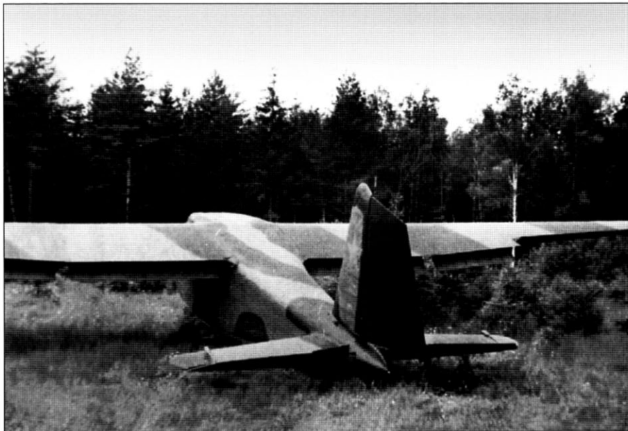
Планер Г-11, вид сзади. Планер имеет камуфляжную окраску. Щитки выпущены. Противофлаттерные грузы руля высоты легли на стабилизатор-руль в крайнем поднятом положении. На руле виден триммер
