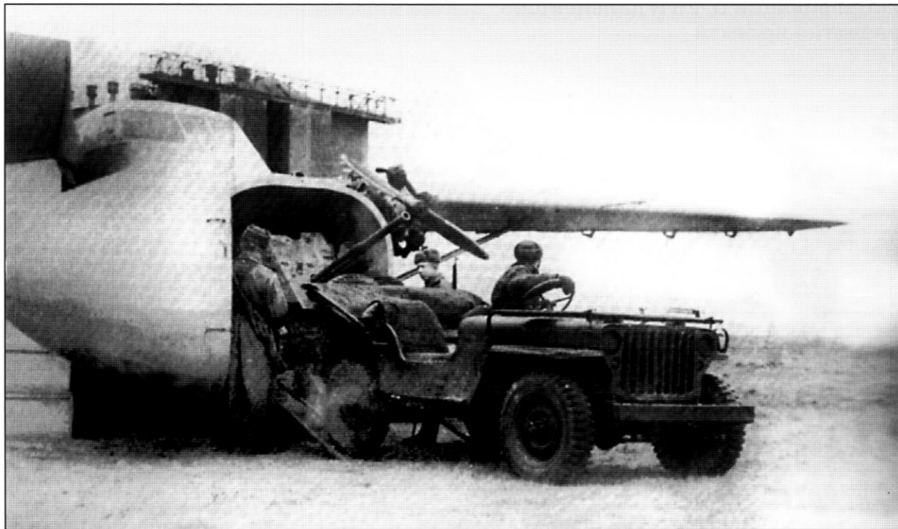
Мотопланер Ц-25М. Мотор М-11 не имеет капотов. Автомобиль «Виллис» вытаскивает противотанковую пушку кал. 45 мм
