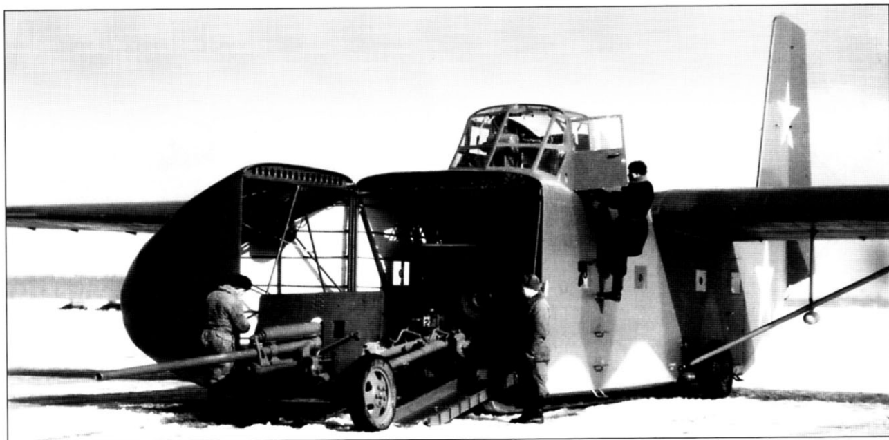
Боевая учеба: тягач ГАЗ-67Б загружает пушку калибром 57 мм в планер. Пилот занимает место в кабине. Время зимнее, и под брюхом заметна длинная лыжа
