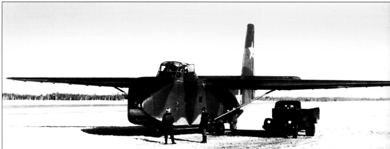
Эта фотография хорошо показывает размеры планера относительно людей и грузовика ГАЗ-51, который он может перевозить. Планер имеет двухцветный камуфляж и волнистую границу голубого цвета снизу. 1949 г.
