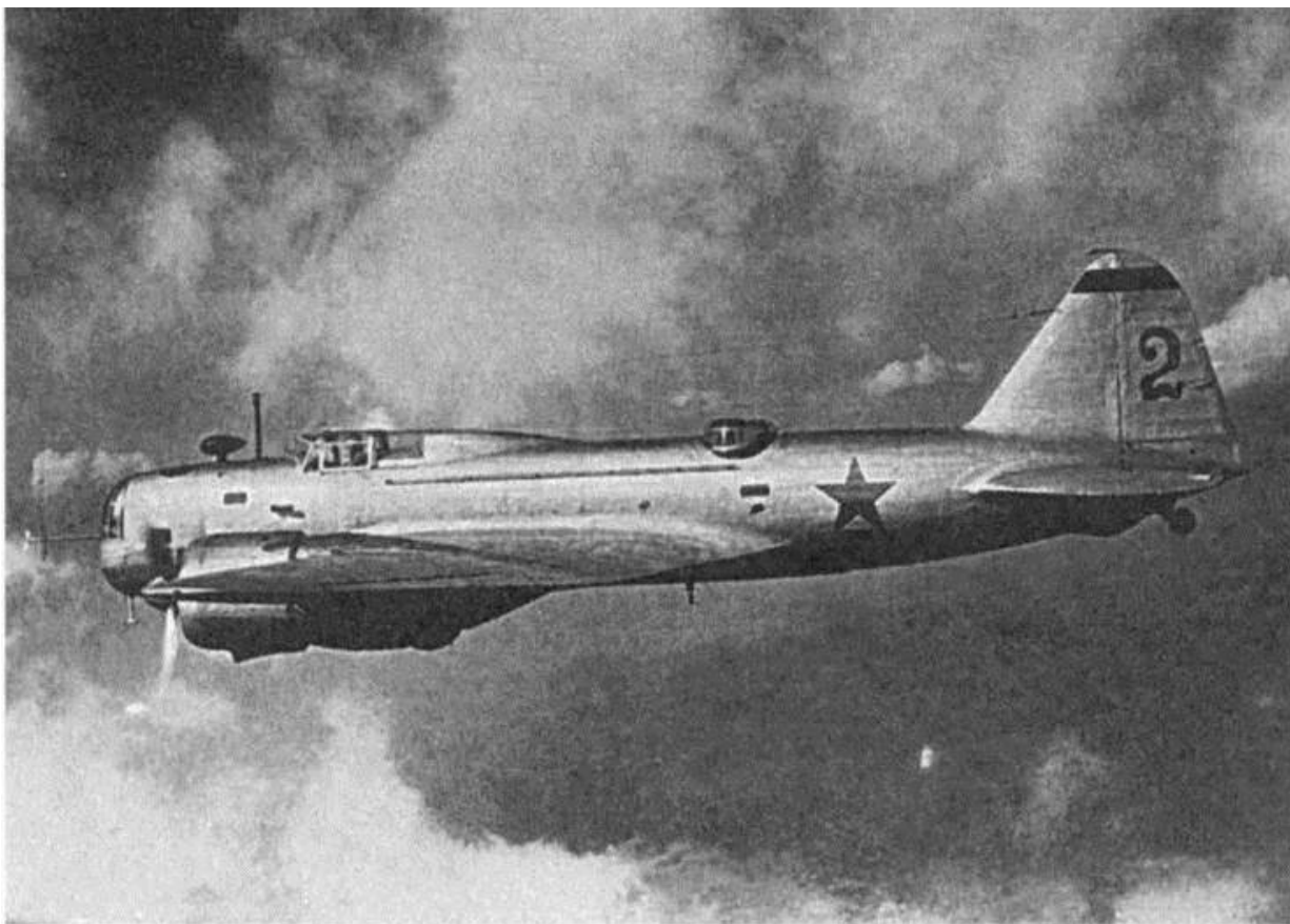
Дальний бомбардировщик ДБ-3Б в полете. Перед кабиной пилота установки радиополукомпас РПК-2 (рамочная антенна в обтекателе)
