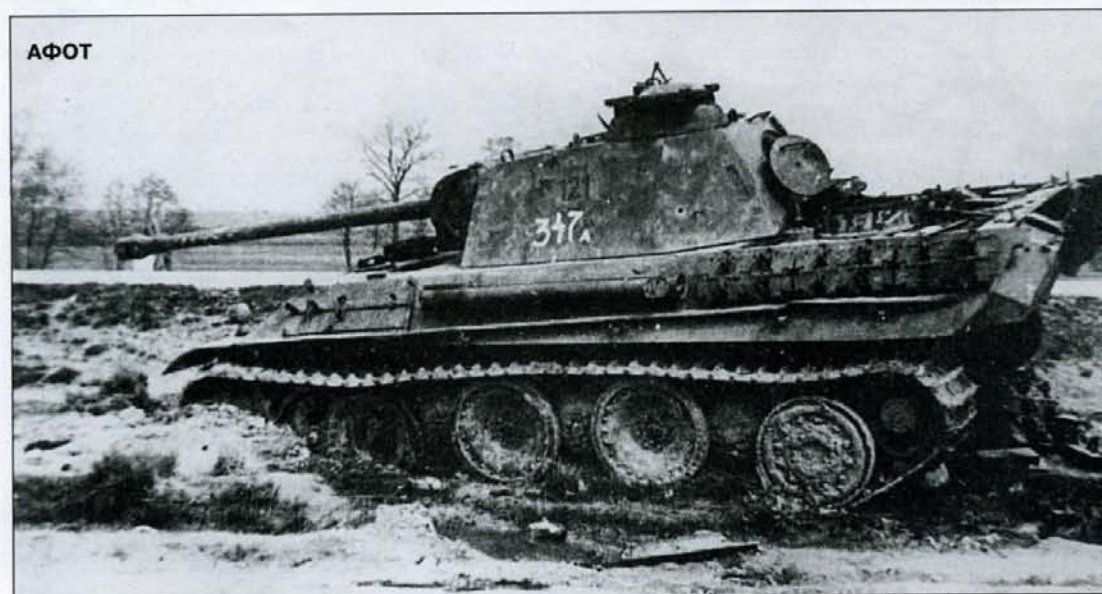
"Пантера" Ausf G, брошенная немцами из-за неисправности. Обратите внимание на использование нестандартного катка. An abandoned Panther Ausf G. Note the non-standard road wheel.
