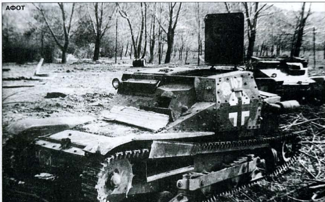
Брошенные венгерскими войсками танкетки 37. М (CV 3/35 итальянского производства). Abandoned Hungarian 37.M tankettes (CV 3/35 of Italian production).
