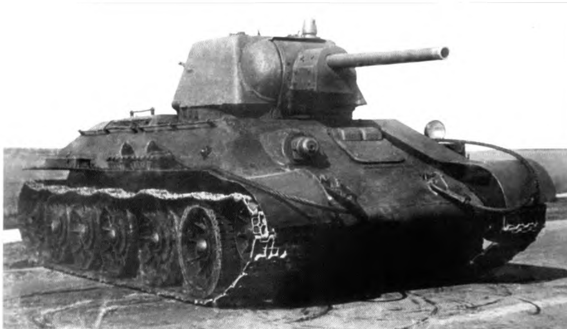
Огнеметный танк ОТ-34, вид спереди. 1942 г. Обратите внимание: в корпусе, левее люка механика-водителя, вместо курсового пулемета установлен огнемет АТО-41. Фотография из фондов ФГУП "УКБТМ".
