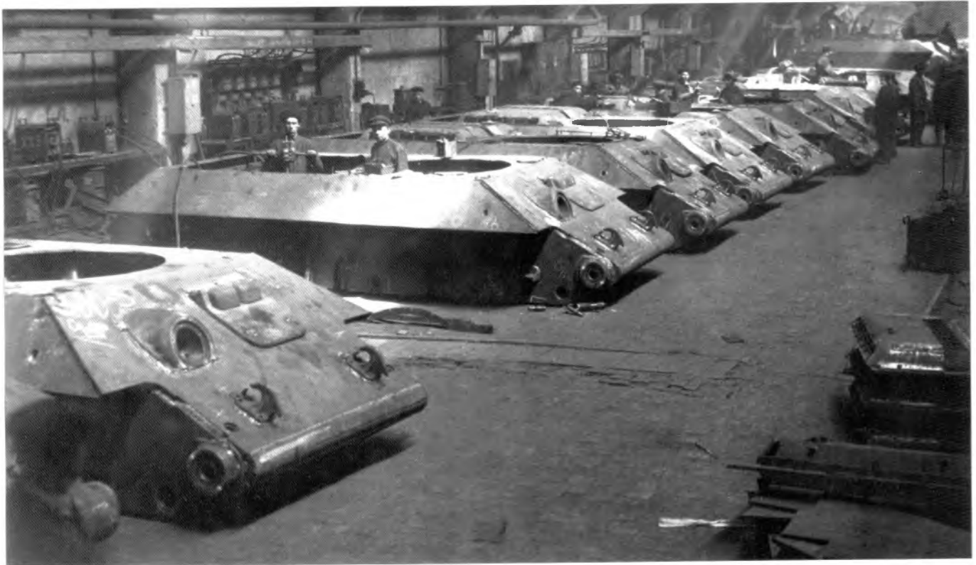
Сварка корпусов танков на заводе №183. 1942 г.
