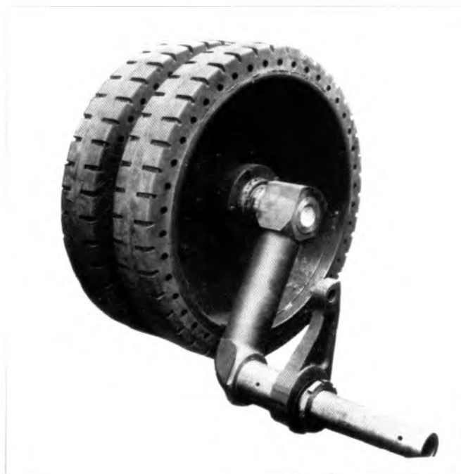
Опорный каток с балансиrom передней правой подвески танка Т-34-76. Апрель 1941 г.
