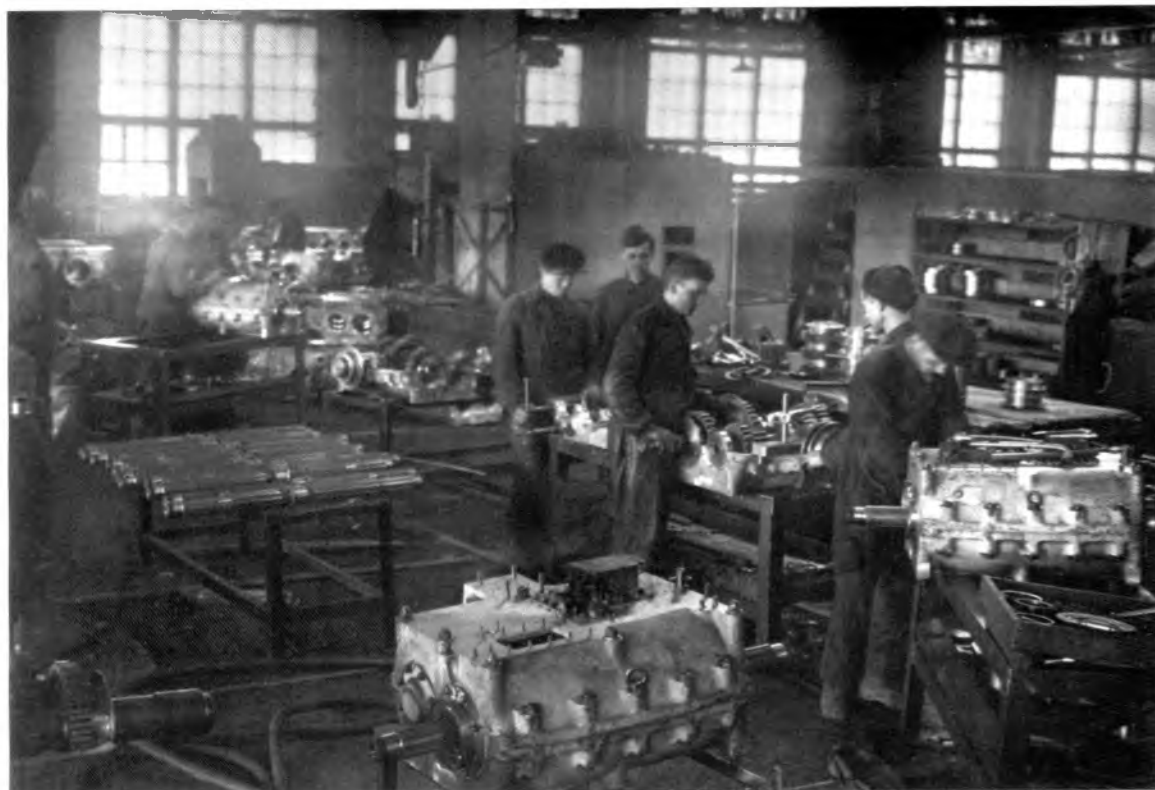
Сборка коробки передач. Завод
