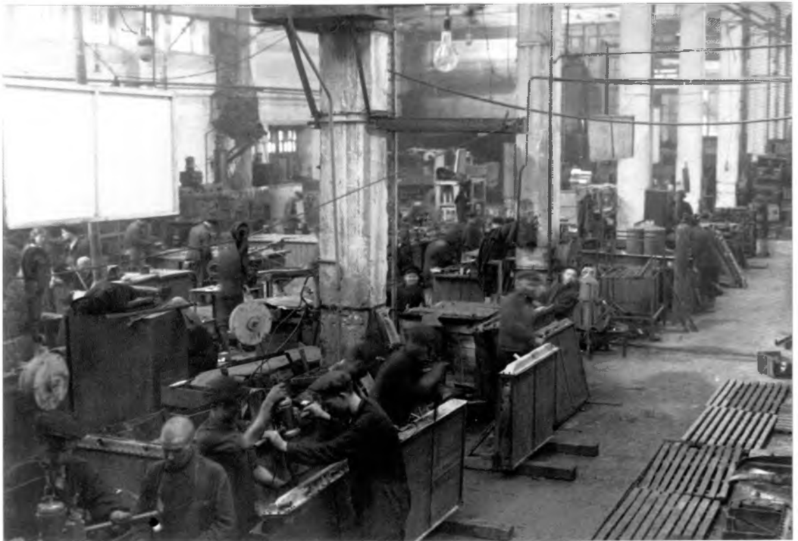
Сборка радиаторов. Завод №183. 1942 г.
