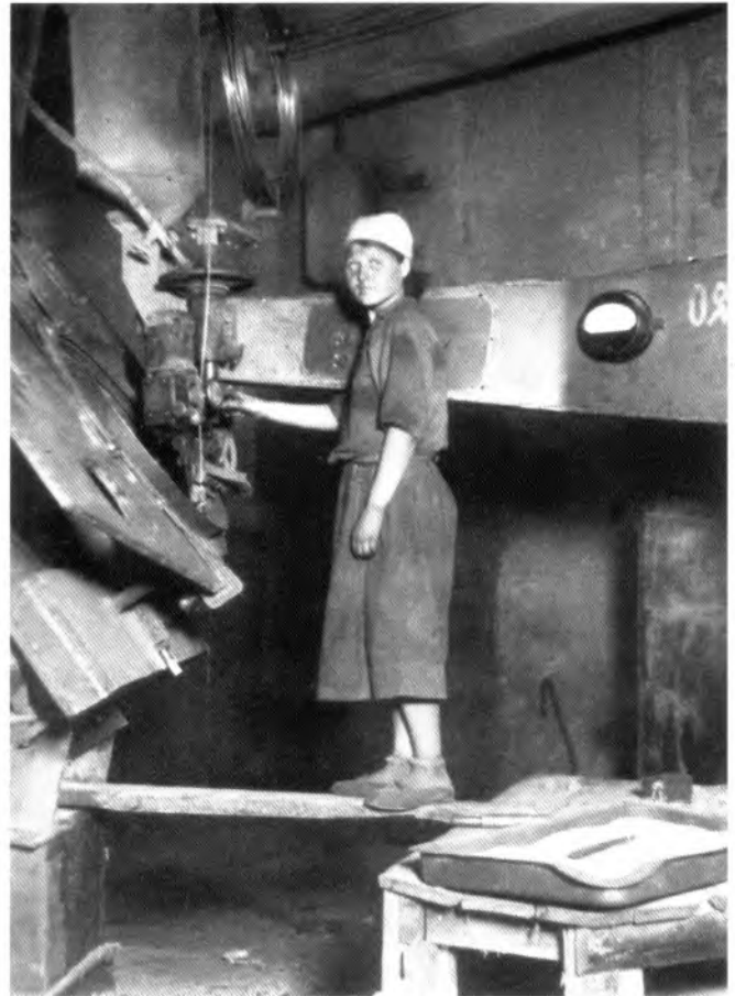
Автоматическая сварочная установка для приварки командирской башенки к крыше башни. 1944–1945 гг.
