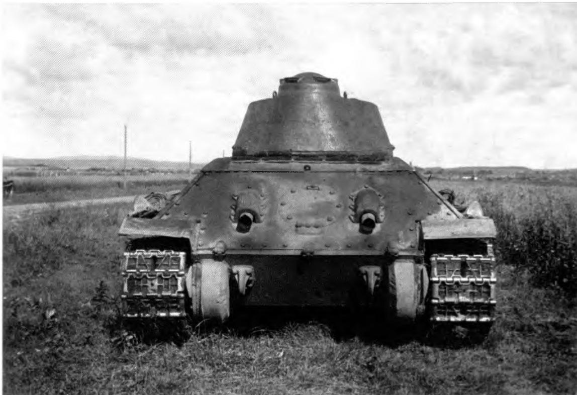
Танк Т-34 с трехместной башней и командирской башенкой танка Т-43. Лето 1942 г. Фотографии из фондов РГАЗ.
