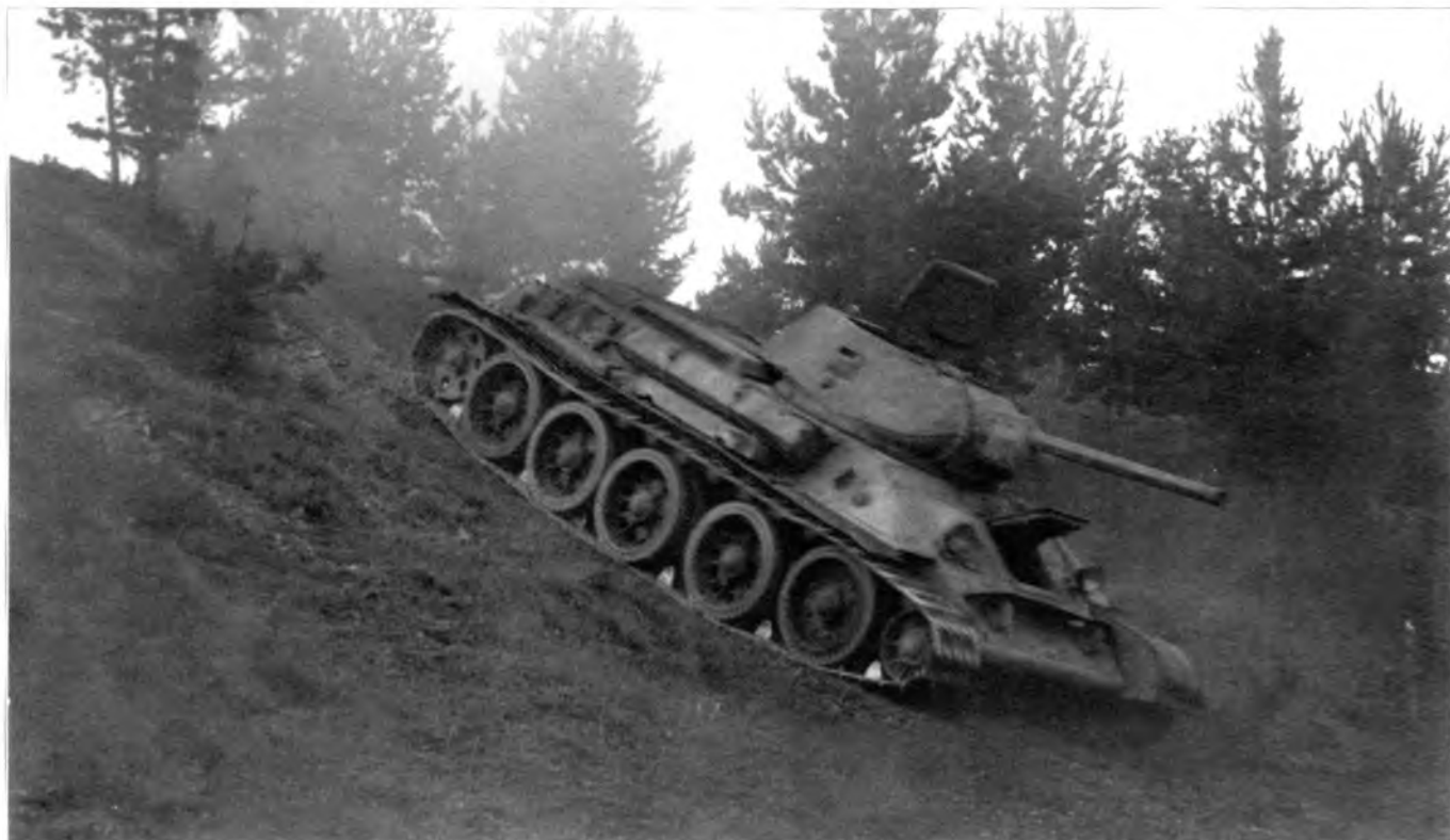
Танк Т-34-76 с 5-скоростной коробкой передач преодолевает подъем в 33 градуса на передаче заднего хода. Лето 1942 г. Фотография из фондов РГАЗ.
