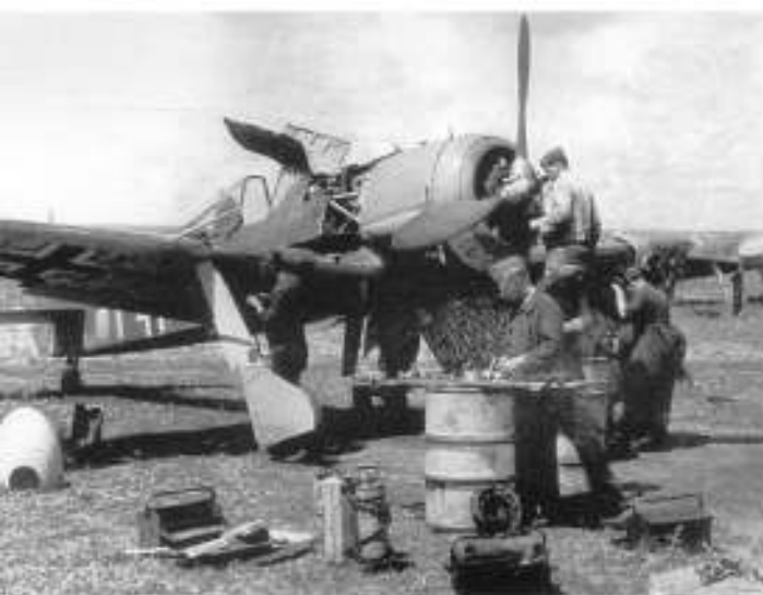
Профилактический осмотр в полевых условиях между вылетами самолета FW. 190
