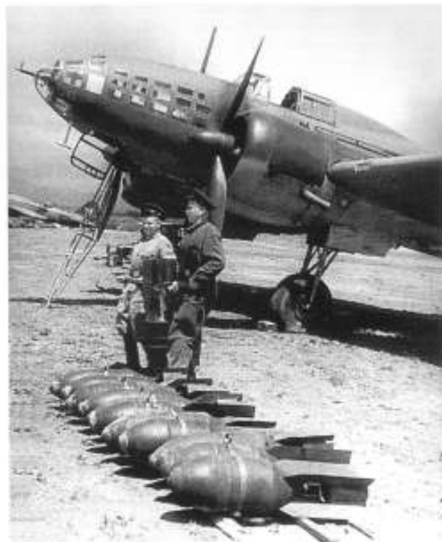
Подготовка бомб для загрузки в дальний бомбардировщик. Лежащие на переднем плане 10 ФАБ-10 составляли стандартную загрузку самолета Ил-4 при действиях по дальним целям
