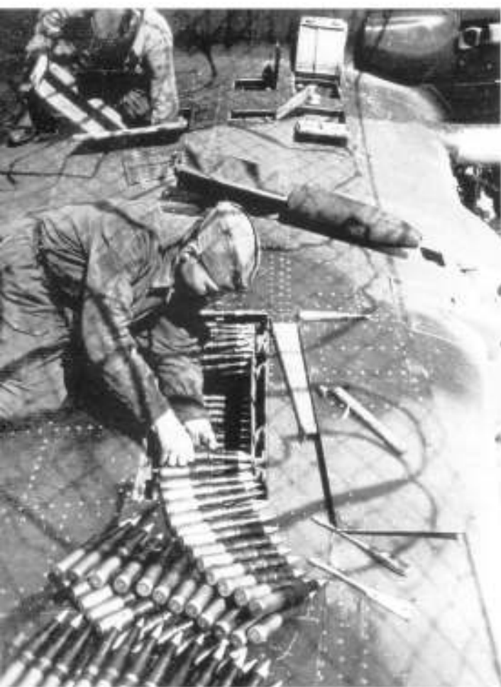
Механики заряжают боеприпасами штурмовик. На переднем плане — ленты снарядов ВЯ-23
