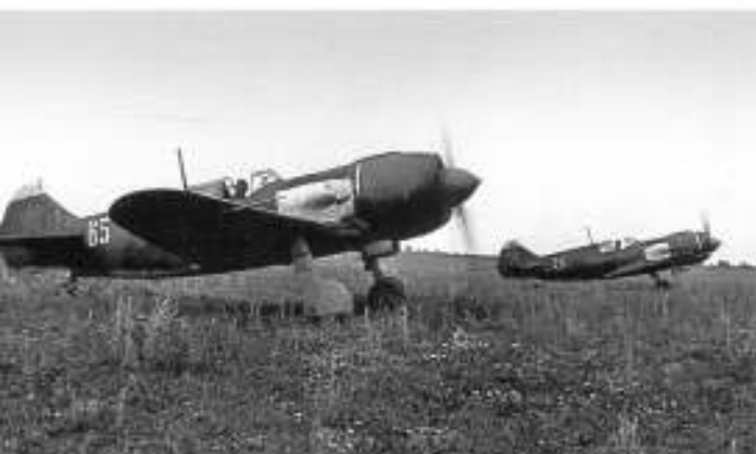
Пара Ла-5 из 302-й иад на полевом аэродроме. Соединение было укомплектовано преимущественно «лавочками» первых серий: высокий гаргрот, ограниченный обзор для летчика задней полусферы, пять топливных баков...
