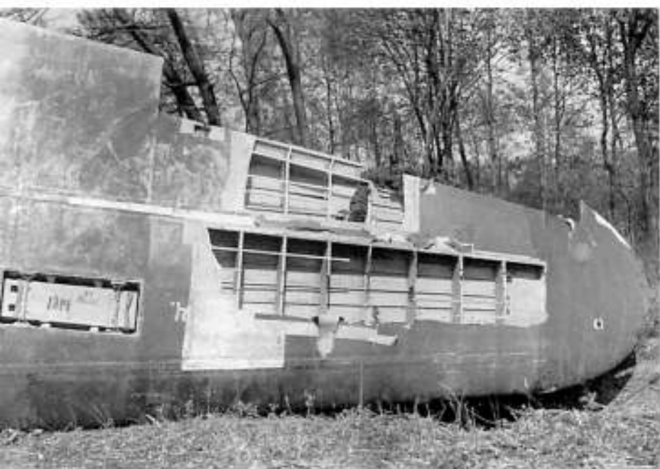
Отстыкованная для ремонта консоль крыла штурмовика Ил-2. Видны типичные повреждения зенитным огнем, сопровождаемые частичным обрывом обшивки
