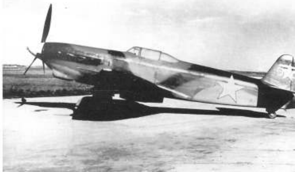
Новинки советских ВВС в битве под Курском: истребители Як-9 Т (с 37-мм мотор-пушкой, вверху) и Як-9 Д (с увеличенной дальностью полета). В ходе сражения обе модификации успешно прошли войсковые испытания
