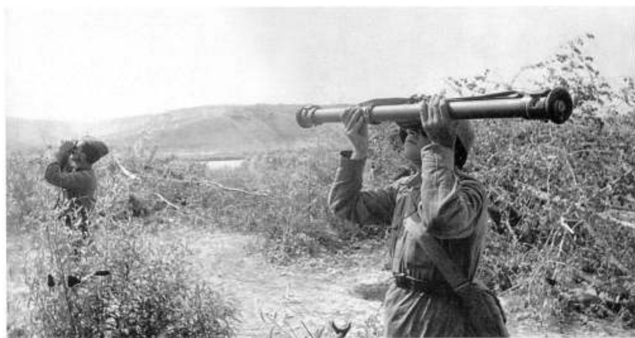
Дальномерщики за работой. Их задача — подготовка данных для прицельной стрельбы зенитной батареей
