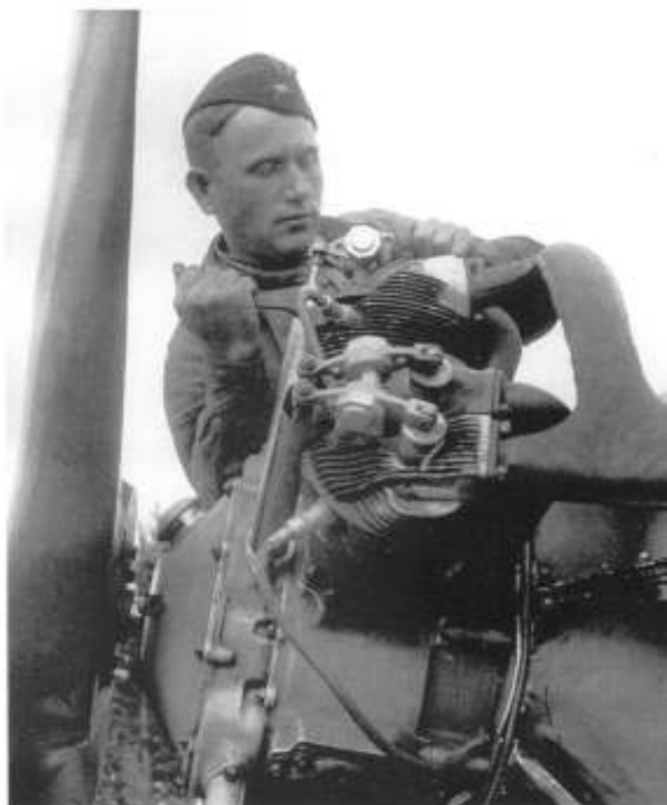
Советский механик ремонтирует 5-цилиндровый мотор М-11 Д в полевых условиях
