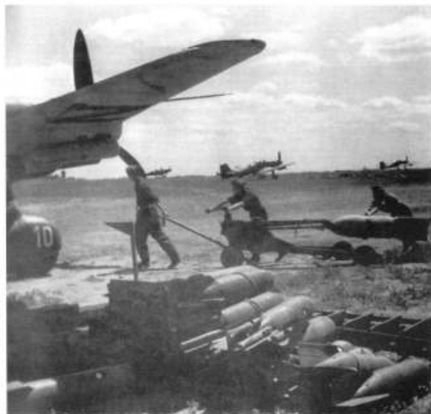
Наземный состав эскадры StG2 «Иммельман» подвозит боеприпасы для загрузки самолетов Ju.87. На переднем плане лежат бомбы SC 250 и SC 90
