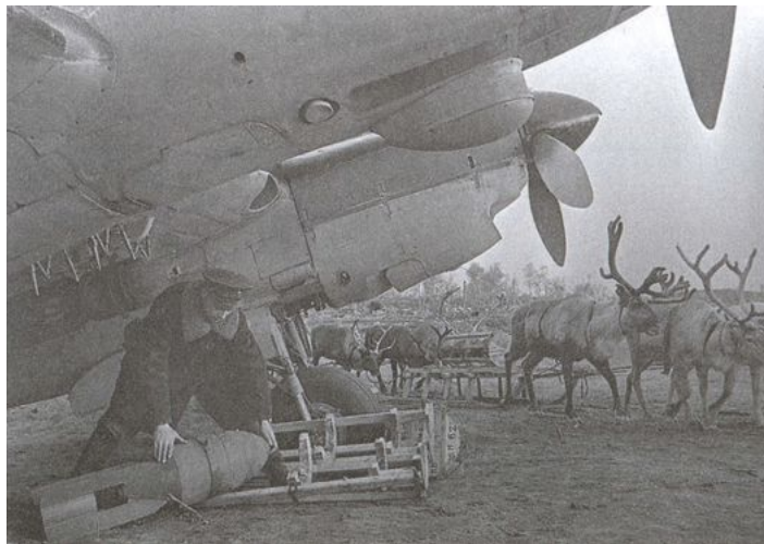
Подвеска авиабомб ФАБ-100 на пикирующий бомбардировщик Пе-2 ВВС Северного флота
