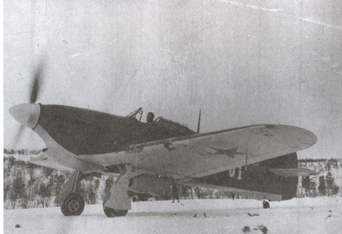
Советский истребитель «Харрикейн» Мк IIВ(Т), пилотируемый командующим военно-воздушными силами Северного флота генерал-майором авиации А. А. Кузнецовым. На фюзеляже видны следы перекрашивания, тактический номер «01» и серийный номер Z5252. 25 сентября 1941 г.
