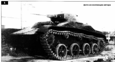
4 Танк Т-60 выпуска завода № 37 с 20-мм пушкой ТНШ. 1942 г.
