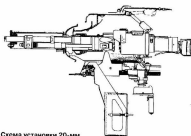
Схема установки 20-мм танковой пушки в башне танка Т-60
