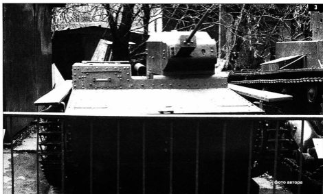
3 Танк Т-38Ш, вооруженный 20-мм пушкой ТНШ во дворе ЦМВС.
