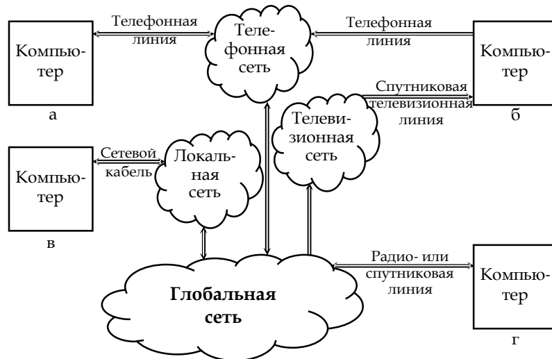
Рис. 3. Схемы подключения пользователя к глобальной сети:
