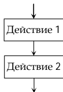
Рис. 7. Элементарная структура следования
