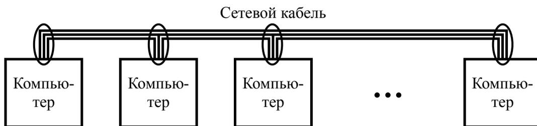
Рис. 1. Линейная архитектура сети. Кругами обведены разъемы
