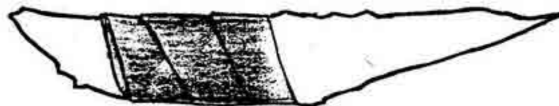
Для предохранения собственной ладони от порезов кусок стекла обматывают изолентой, куском ткани или плотной бумаги
