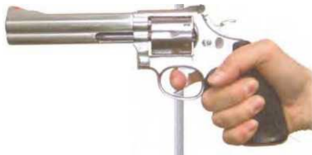
Начало нажатия на спусковой механизм (у этого Smith & Wesson 686 курок все еще опущен)
