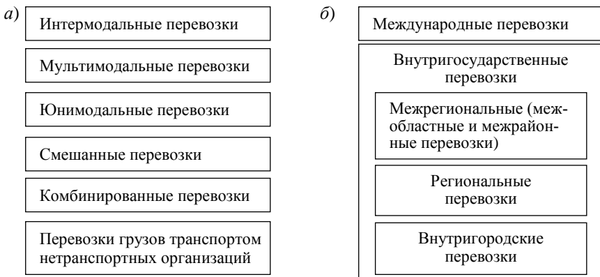
Рисунок 9.3 – Иерархическая схема перевозок грузов: а – по видам исполнения; б – по видам сообщений
