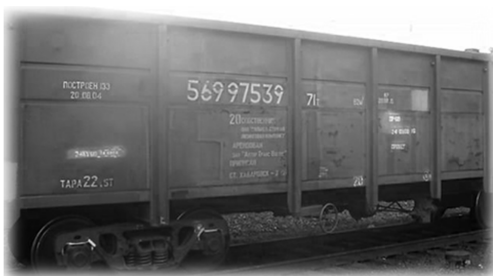
Рис. 3.11. Внешний вид идентификаторов на вагоне
