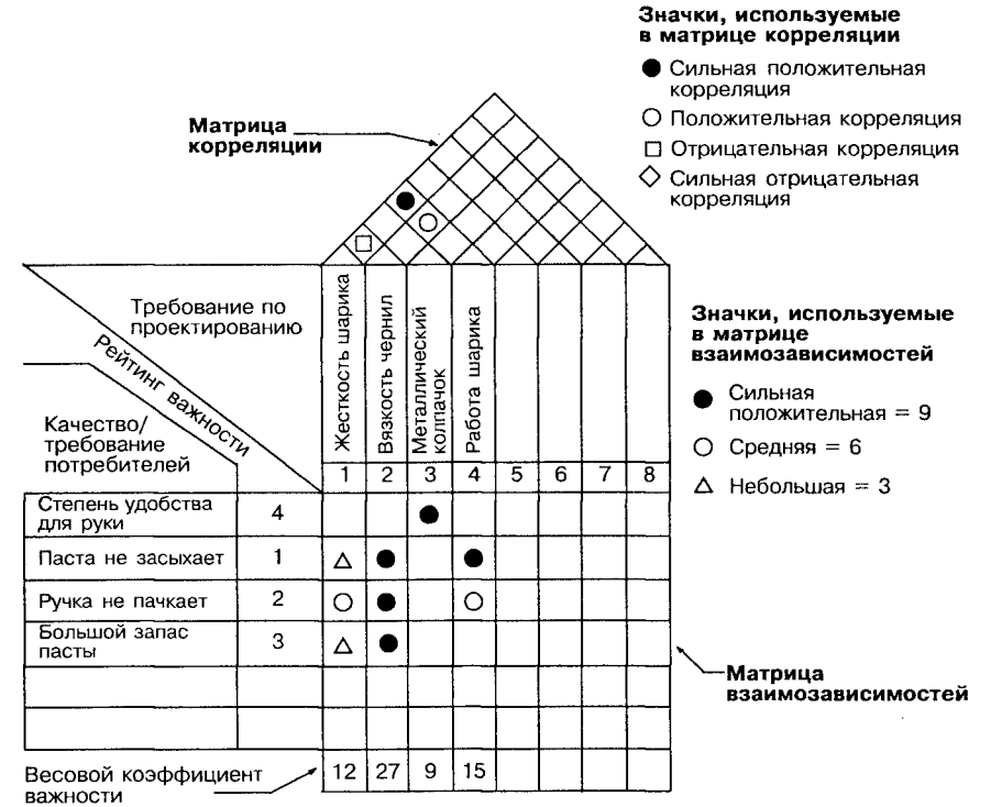
Матрица ХУ («дом качества»), показывающая на простом примере шариковой авторучки связь между разработкой продукта и требованиями потребителей
