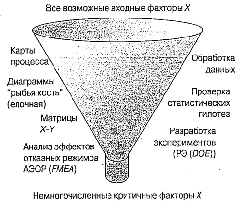
Рис. 7.4. Инструменты для идентификации всех потенциальных входных факторов X и выбора из них только критичных X
