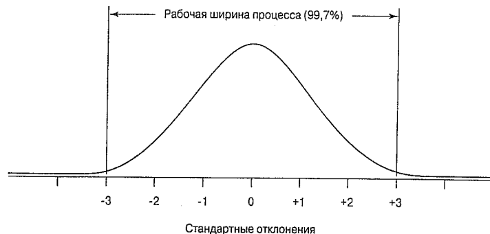
Рис. 6.12. Рабочая ширина процесса (или характеристики) равна \pm 3 стандартным отклонениям и включает 99,7% вариации процесса
