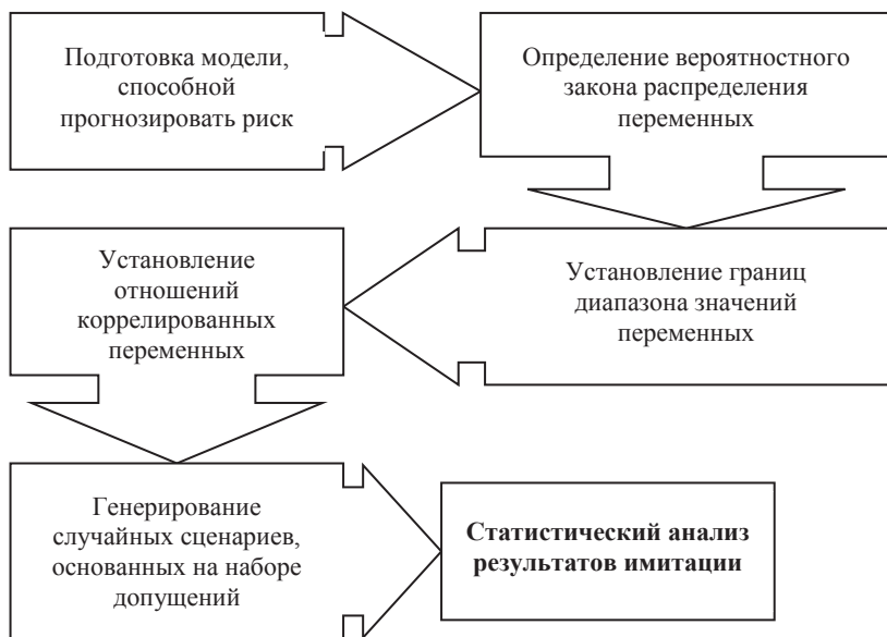
Рис. 4.2. Алгоритм имитационного моделирования
