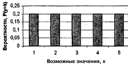
Рис. 7.3. График вероятностного ряда равновероятного распределения
