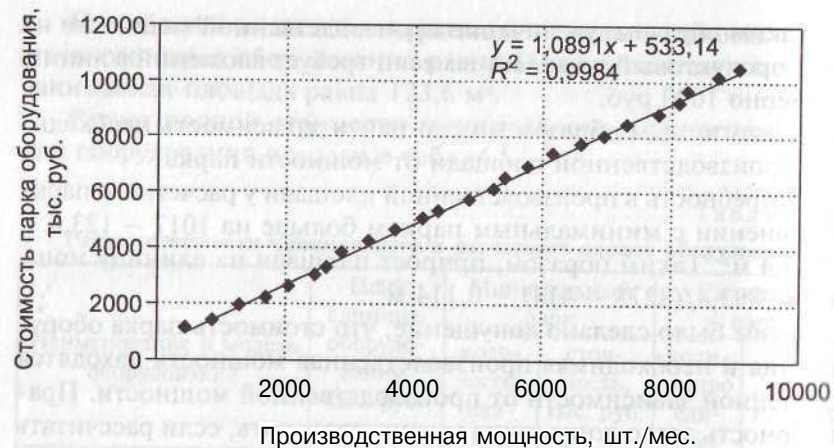
Рис. 4.3. Зависимость стоимости парка оборудования от его производственной мощности
