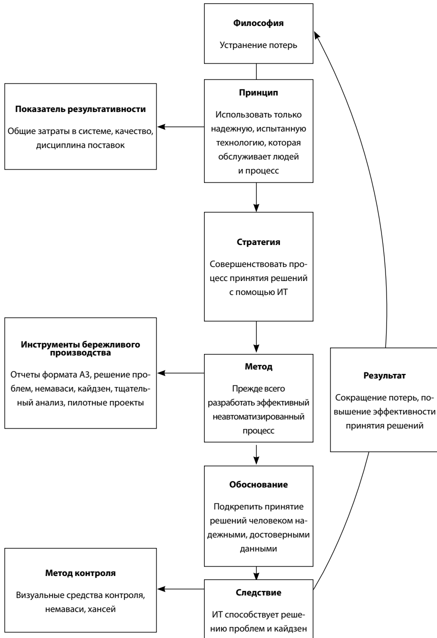
Рис. 9-4. ИТ при бережливом производстве
