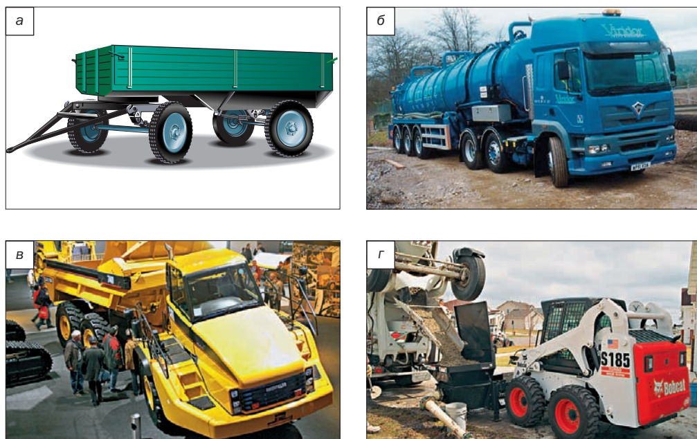
Рис. 5.1. Способы поворота колесной машины: а — за счет поворота оси; б — за счет поворота управляемых колес; в — складыванием рамы; г — силовым способом
