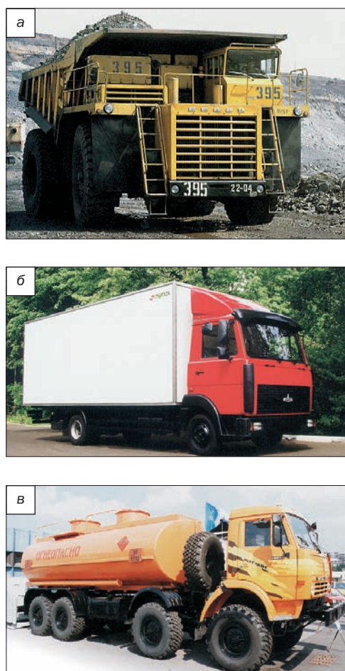
Рис. 7.11. Специализированные кузова грузовых автомобилей: а — карьерный самосвал; б — фургон на шасси МАЗ; в — цистерна на шасси КамАЗ
