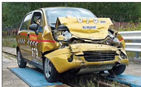
Рис. 7.21. Смятие передней части кузова при ударе
