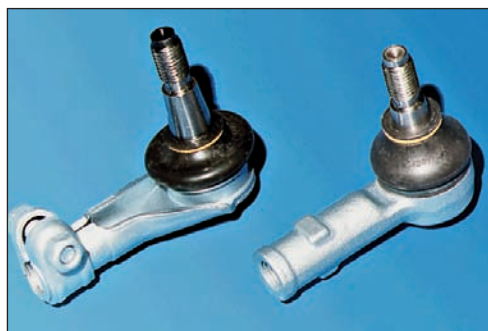
Рис. 5.9. Шарнир рулевого привода с шаровым пальцем
