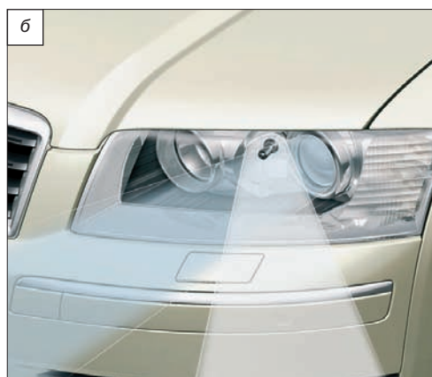
Рис. 7.33. Расположение и типы внешних световых приборов автомобиля (а): 1 — передние фары; 2 — задние фонари; 3 — освещение номерного знака; 4 — подсветка дверных ручек; 5 — внешнее освещение двери; 6 — противотуманные фары; регулируемые (поворачивающиеся) фары (б) и современные системы головного освещения автомобиля с регулируемыми световыми потоками (в)
