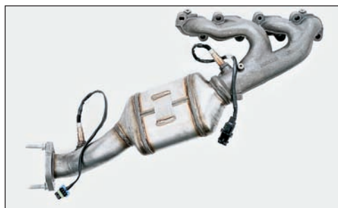
Рис. 2.78. Выпускной коллектор двигателя с предварительным нейтрализатором
