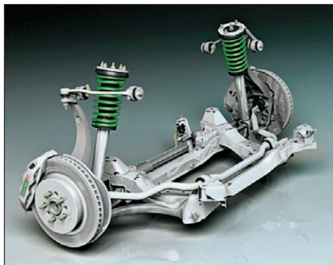
Рис. 4.41. Передняя подвеска автомобиля Jaguar S-type имеет двойные поперечные рычаги и очень длинную поворотную цапфу. Такая конструкция обеспечивает большое пространство для размещения агрегатов под капотом автомобиля
