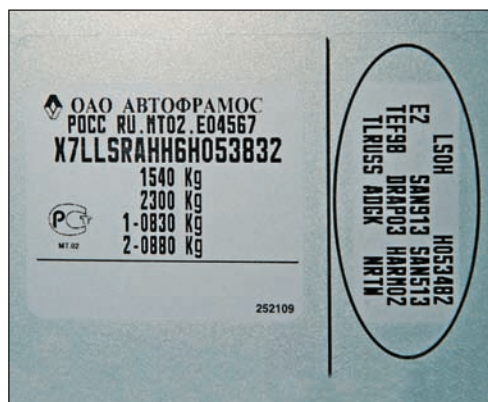
Рис. 1.32. Пример расшифровки идентификационного номера X7LLSRANH6H053832 (модель Renault Logan): X7L — по международным стандартам обозначается код завода-изготовителя; L — тип кузова (седан); SR — модель автомобиля; A — наличие подушки безопасности (4 — без подушки безопасности); HH — двигатель 1,6 л (GH — двигатель 1,4 л); 6 — модельный год выпуска автомобиля (2006); H 053832 — номер кузова
