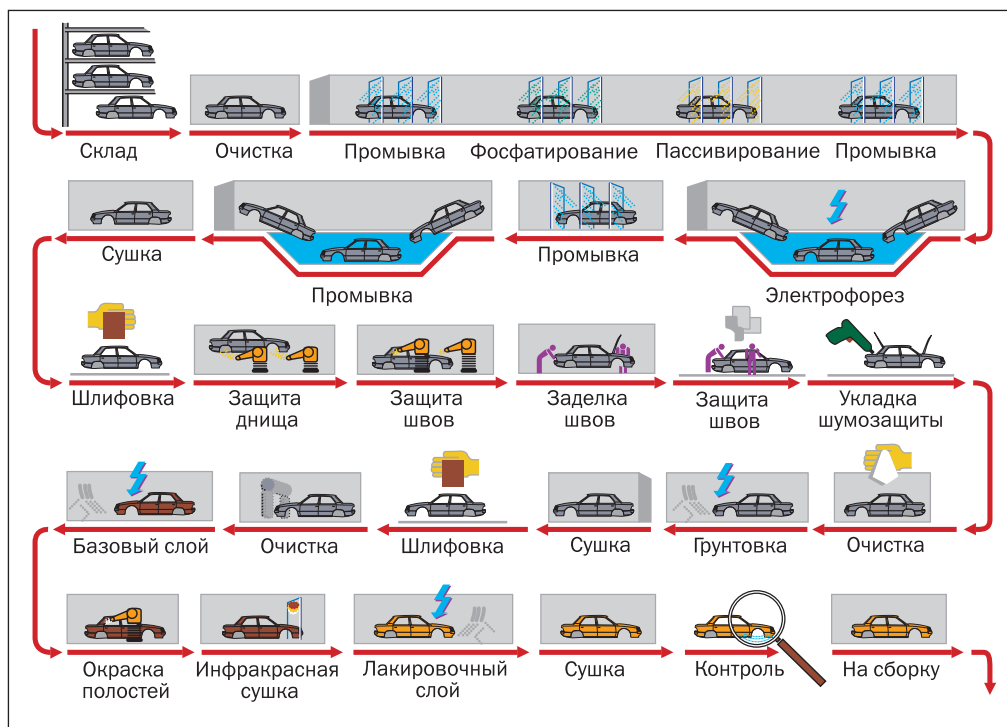
Рис. 7.14. Технологический процесс окраски кузова
