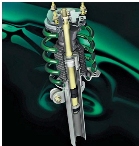
Рис. 4.25. Пружина подвески автомобиля Jaguar с переменной жесткостью
