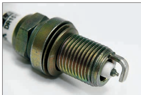
Рис. 2.114. Рабочая часть свечи зажигания
