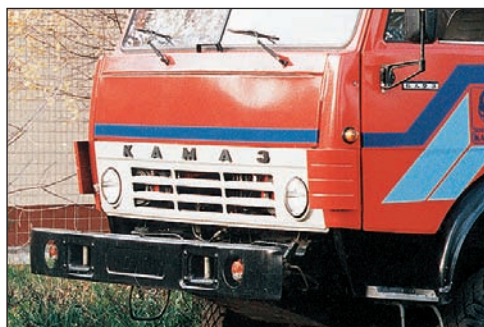
Рис. 7.20. Противогрязевые обтекатели автомобиля КамАЗ
