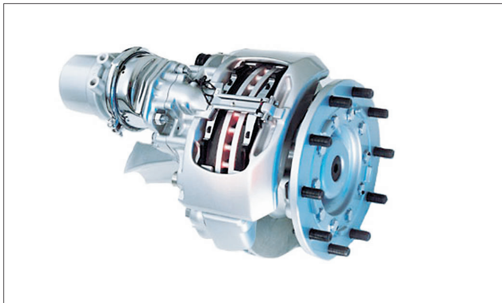
Рис. 6.13. Дисковый тормозной механизм с пневматическим приводом
