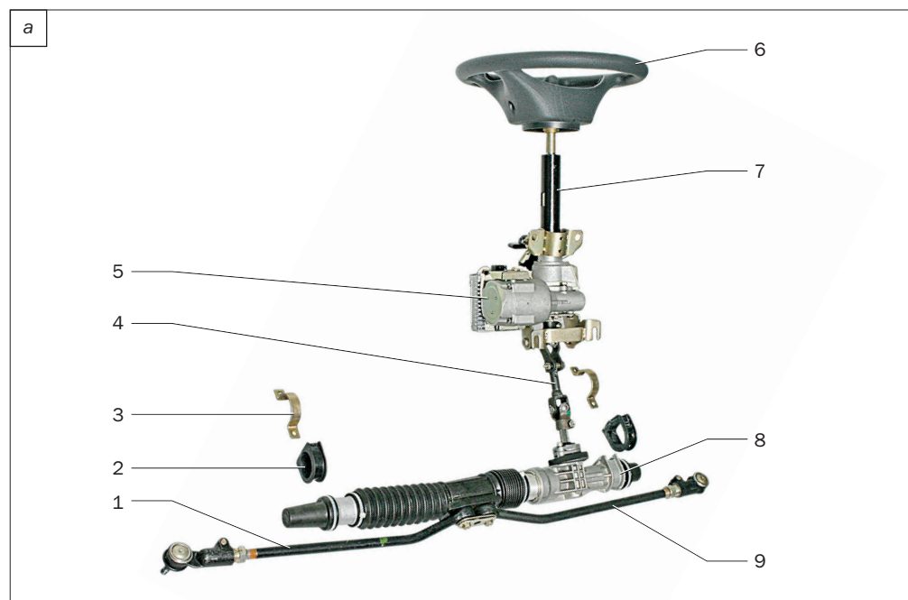
Рис. 5.6 а. Реечный рулевой механизм: 1 — правая рулевая тяга в сборе; 2 — опора рулевого механизма; 3 — скоба опоры рулевого механизма; 4 — промежуточный карданный вал; 5 — электроусилитель; 6 — рулевое колесо; 7 — рулевая колонка; 8 — рулевой механизм; 9 — левая рулевая тяга в сборе
