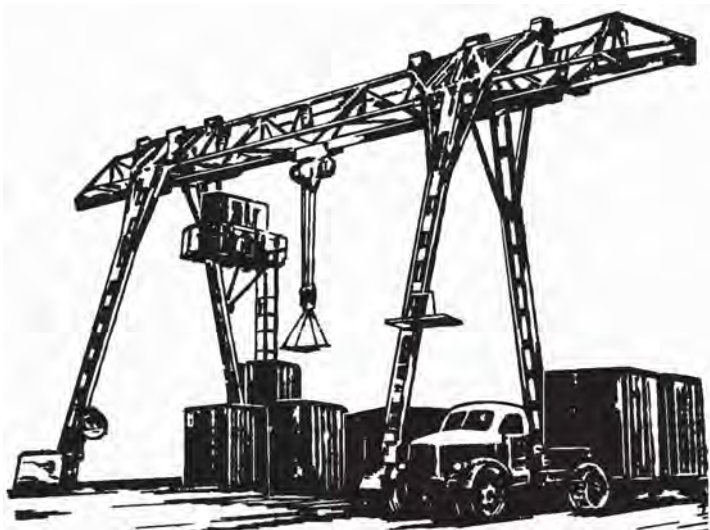
Рис. 8. Электрический козловый кран
