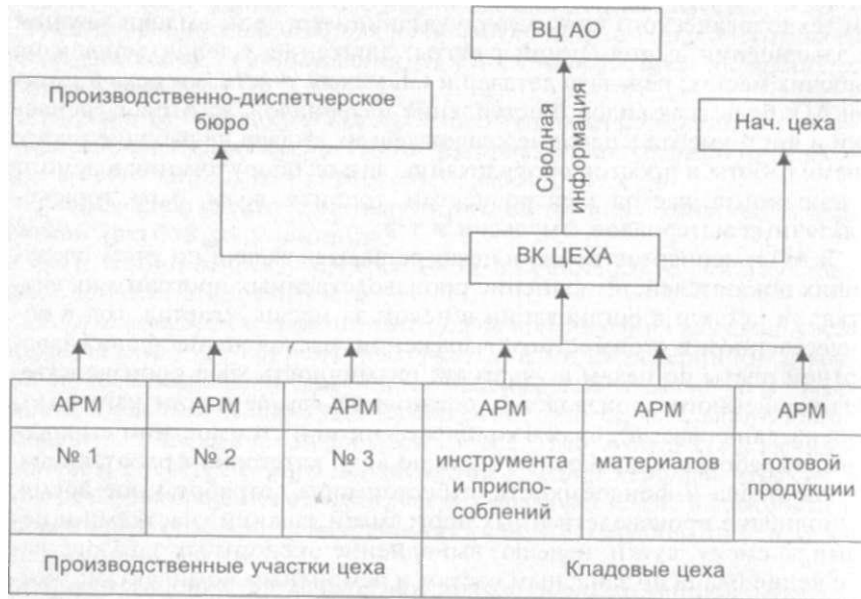
Рис. 7.7. Схема регистрации, обработки и передачи оперативной информации о ходе производства в обрабатывающем цехе
