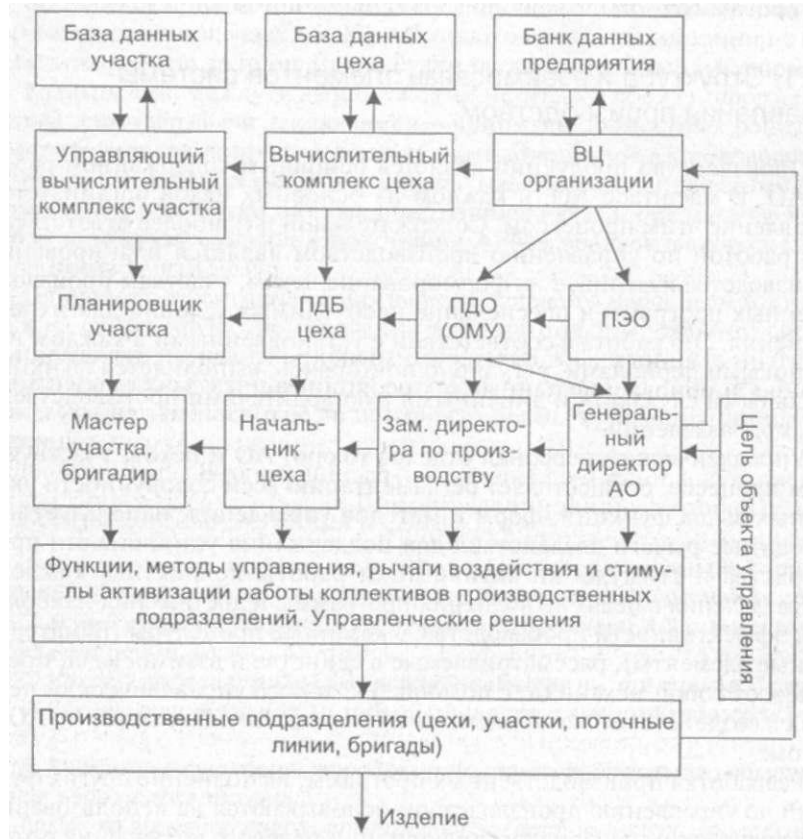
Рис. 7.8. Схема взаимосвязи элементов системы управления производством
