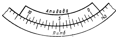
Рис. 61. Верньер теодолита ТТ5
