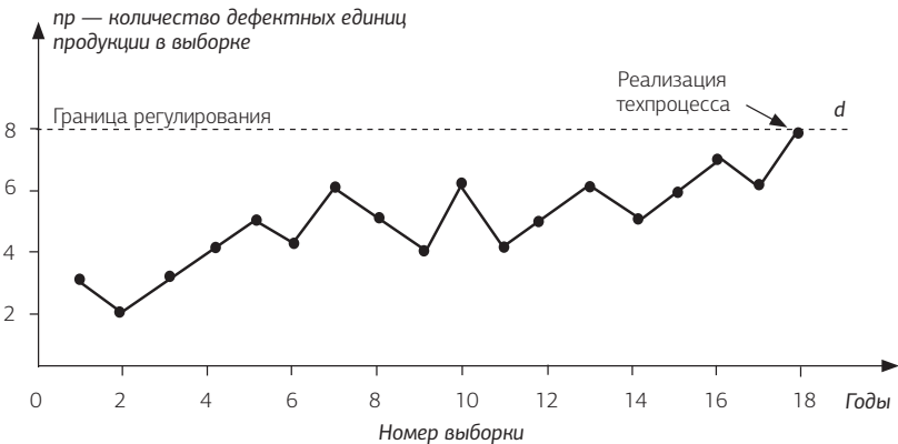
Рис. 148. Контрольная карта числа дефектных единиц продукции: пр — карта для статистического регулирования технологических процессов методом учета дефектов; d — браковочное число (минимальное число дефектных единиц в выборке, по достижении которого технологический процесс признается разлаженным)
